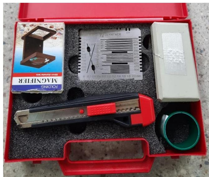
**Slika 24. Oprema za ispitivanje prionjivosti Cross-cut metodom**
