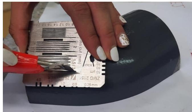
**Slika 25. Urezivanje mrežice za ispitivanje prionjivosti**
