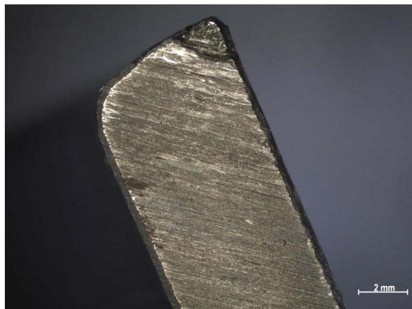
Slika 18. Stereomikroskopski prikaz presjeka osnovnog materijala s premazom
