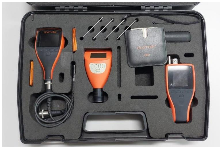
Slika 20. Uredaj za mjerenje debljine prevlake – Elcometer 456
