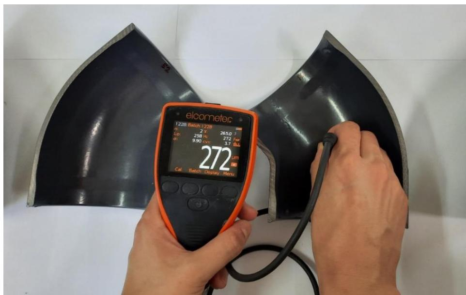
Slika 21. Postupak mjerjenja debljine prevlake
