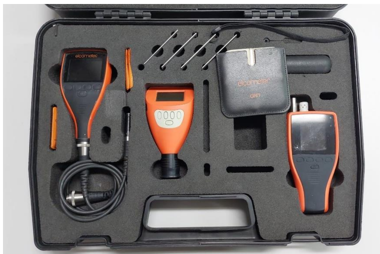
Slika 20. Uređaj za mjerenje debljine prevlake – Elcometer 456
