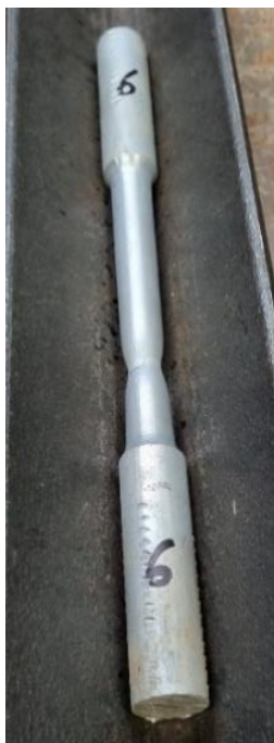
Slika 20. Epruveta 6 nakon ispitivanja
