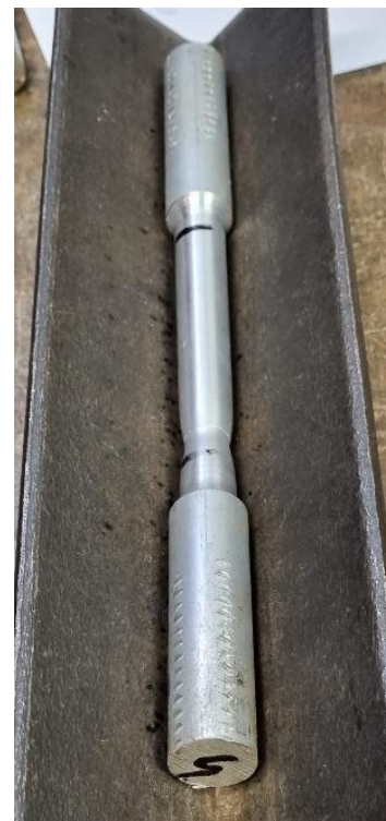
Slika 16. Epruveta 4 nakon ispitivanja
