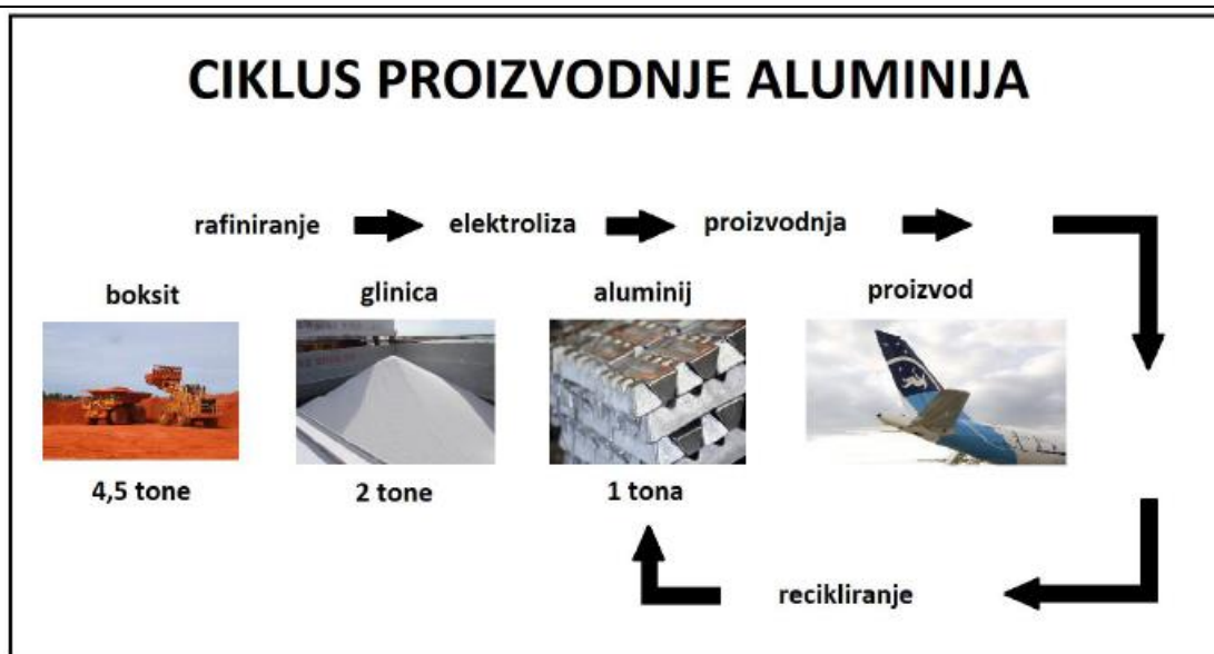
Slika 1. Ciklus proizvodnje aluminija [2]
