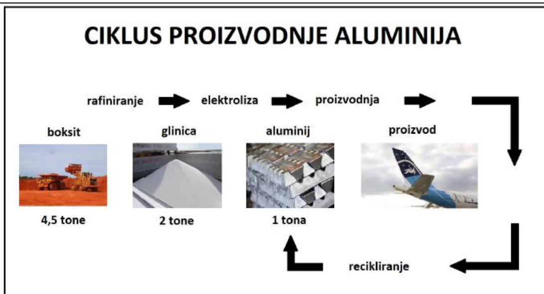
Slika 1. Ciklus proizvodnje aluminija [2]
