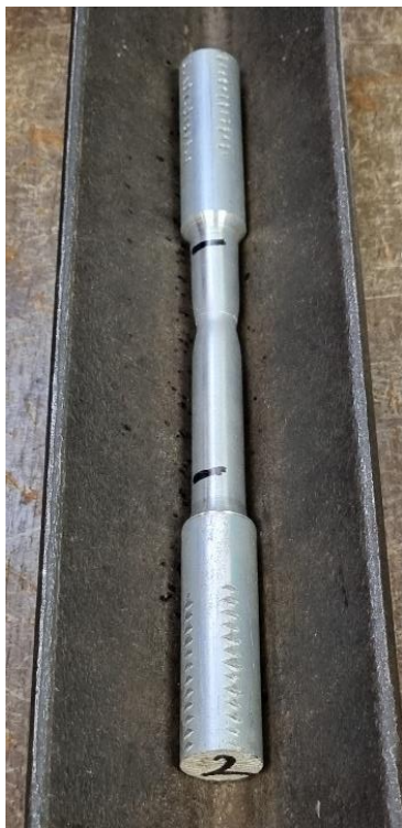
Slika 14. Epruveta 2 nakon ispitivanja
