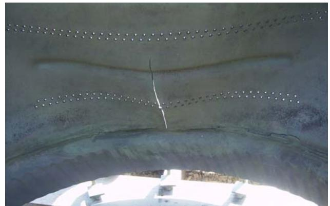
Slika 4.4 Unutarnja strana kućišta vrućih plinova, s kojeg je izrezan uzorak za ispitivanje
