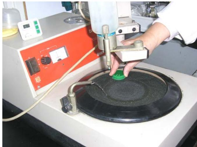
Slika 4.19 Uređaj za brušenje STRUERS DAP - V
