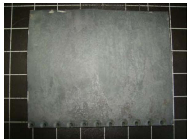
Slika 4.6 Unutarnja strana uzorka Ni-legure, koja je bila izložena visokim temperaturama i strujama plinova izgaranju
