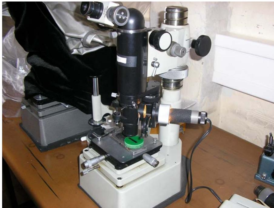
*Slika 4.15 Mikrotvrdomjer PMT3*
