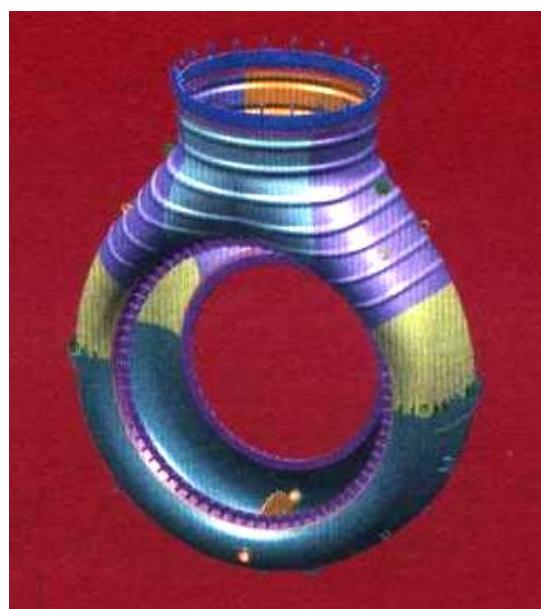
Slika 4.2 3D model kućišta vrućih plinova [8]
