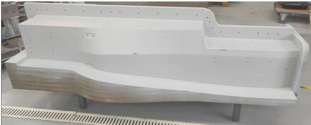
Slika 6.32. Kalup nakon završnog brušenja
