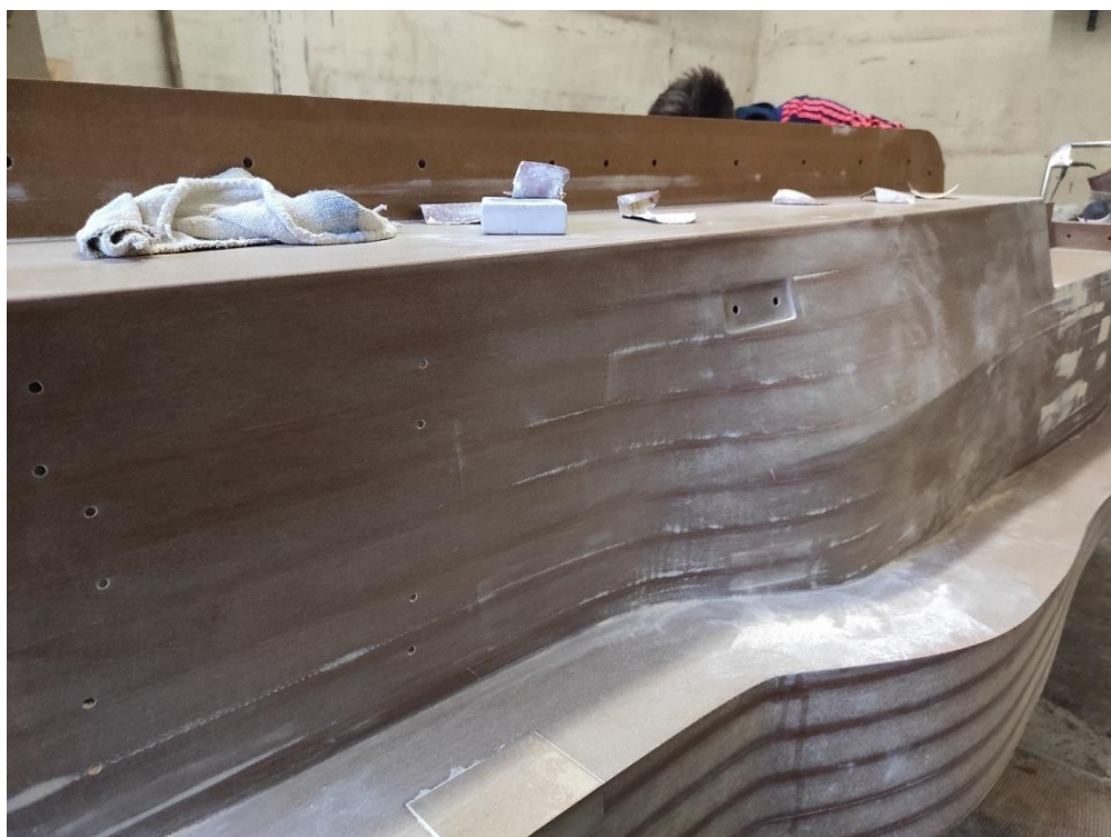
Slika 6.24. Kalup nakon nanošenja auto kita
