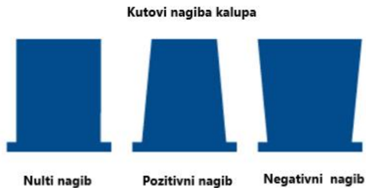
Slika 6.2. Kutovi nagiba kalupa [19]
