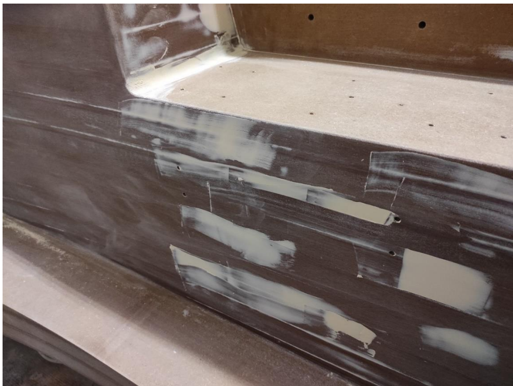
Slika 6.24. Kalup nakon nanošenja auto kita
