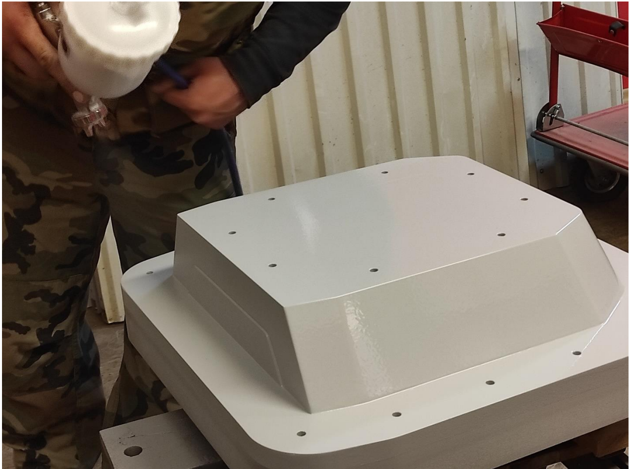
Slika 6.30. Nanošenje temeljnog premaza na površinu prednjeg kalupa
