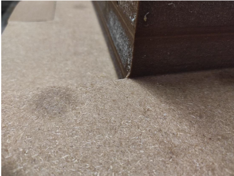
Slika 6.26. Srh nastao tijekom strojne obrade kalupa
