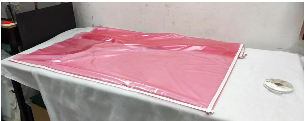
Slika 6.39. Vreća spremna za postavljanje
