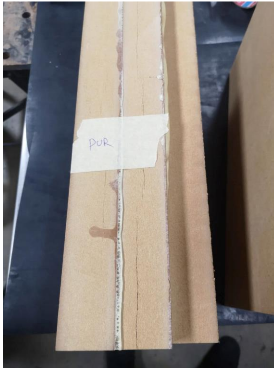
Slika 6.10. Ispitak s poliuretanskom pjenom kao ljepljom
