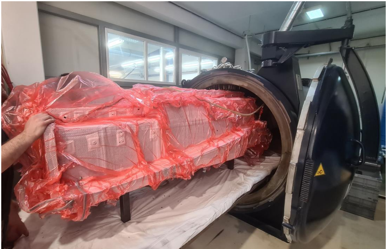
Slika 6.44. Stavljanje proizvoda u autoklav
