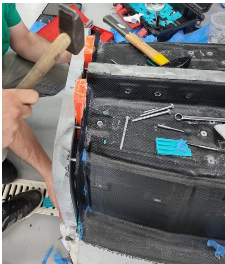
Slika 6.47. Skidanje prednjeg poklopca s predoblika za proizvodnju kalupa
