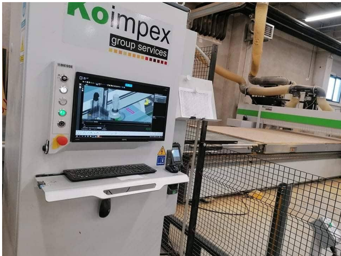
Slika 6.12. Obradni stroj za rezanje drva
