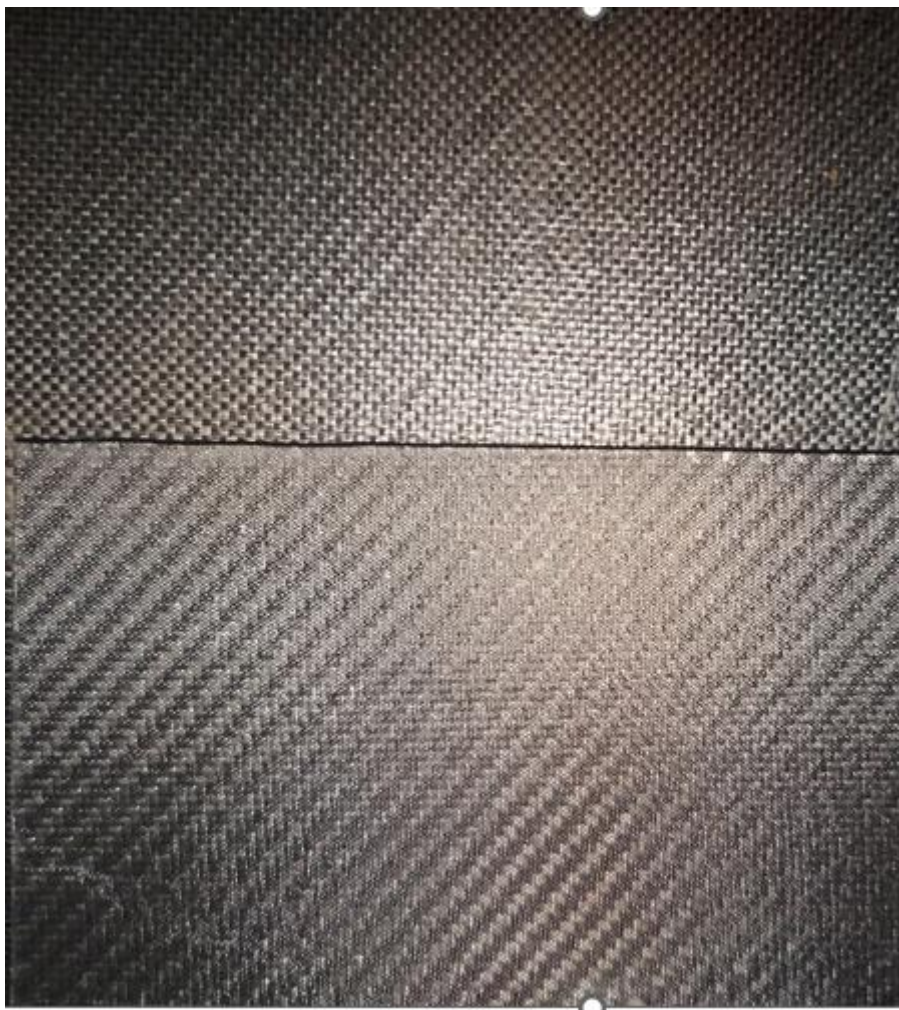
Slika 6.55. Površina proizvedena bez odvojive tkanine (gore) i s odvojjivom tkaninom (dolje)
