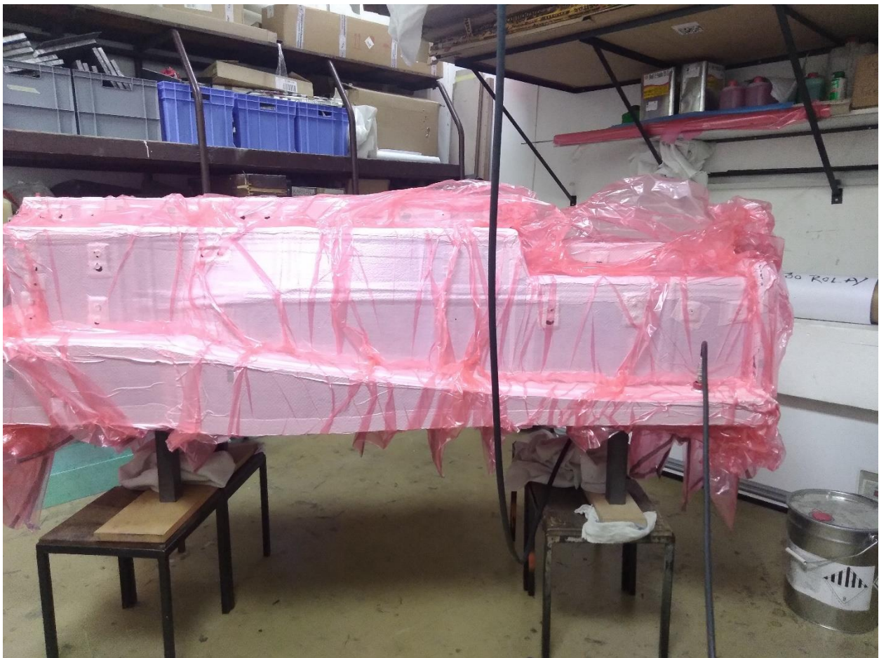
Slika 6.42. Postupak izvlačenja zraka iz poluproizvoda
