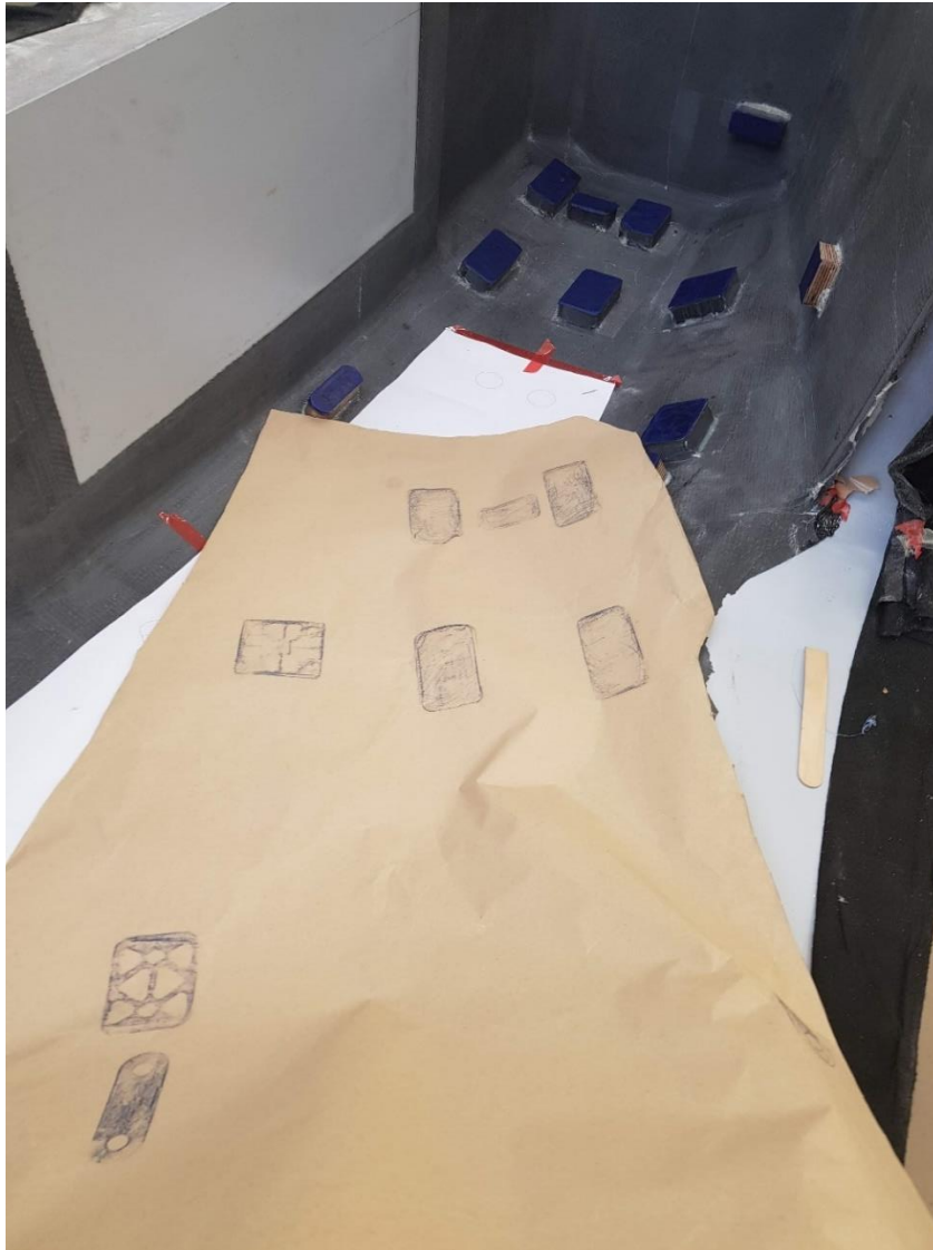
Slika 6.56. Izrada predložaka za rezanje saća
