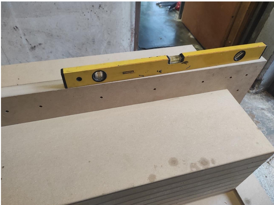
Slika 6.22. Namještanje gornje prirubnice u utor na kalupu
