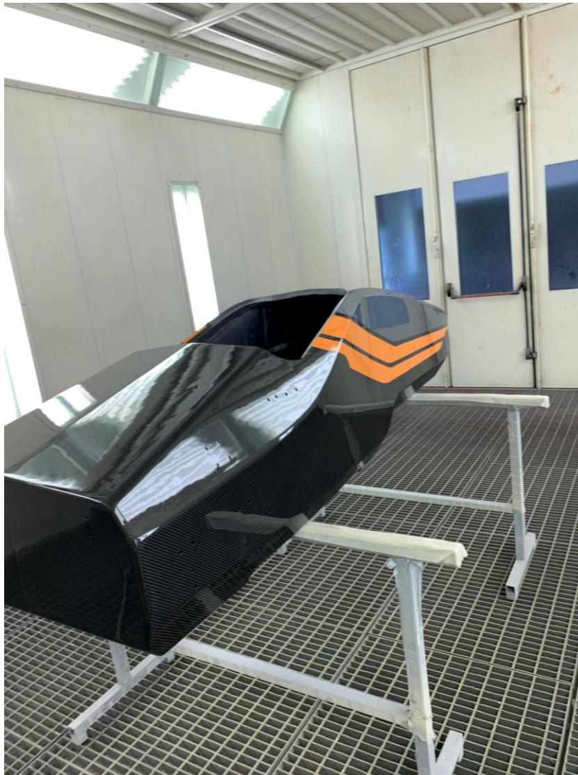
Slika 6.60. Šasija spremna za sklapanje bolida
