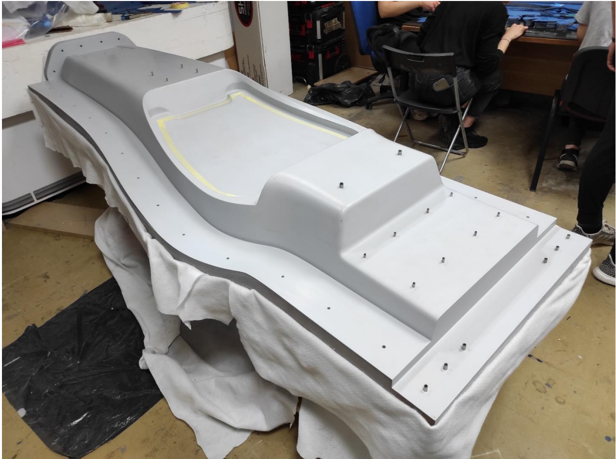
Slika 6.33. Zatici umetnuti u predoblik za proizvodnju kalupa
