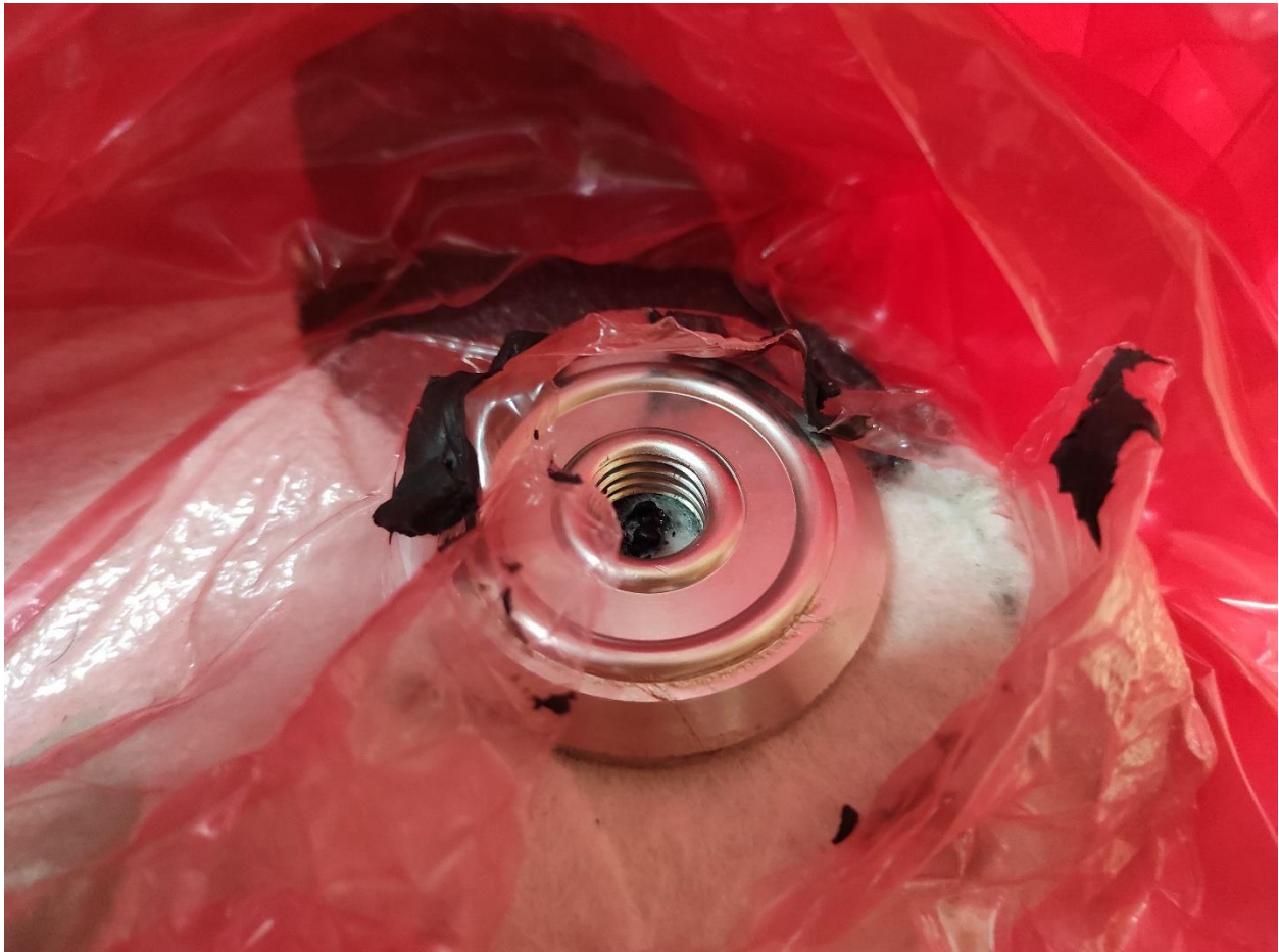
Slika 6.41. Smola u ventilu zbog pogrešne pozicije ventila na kalupu
