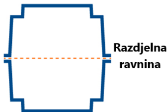
Slika 6.3. Razdjelna linija kalupa [19]
