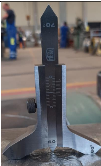
Slika 46. Nadvišenje zavarenoga spoja epruvete V-1
