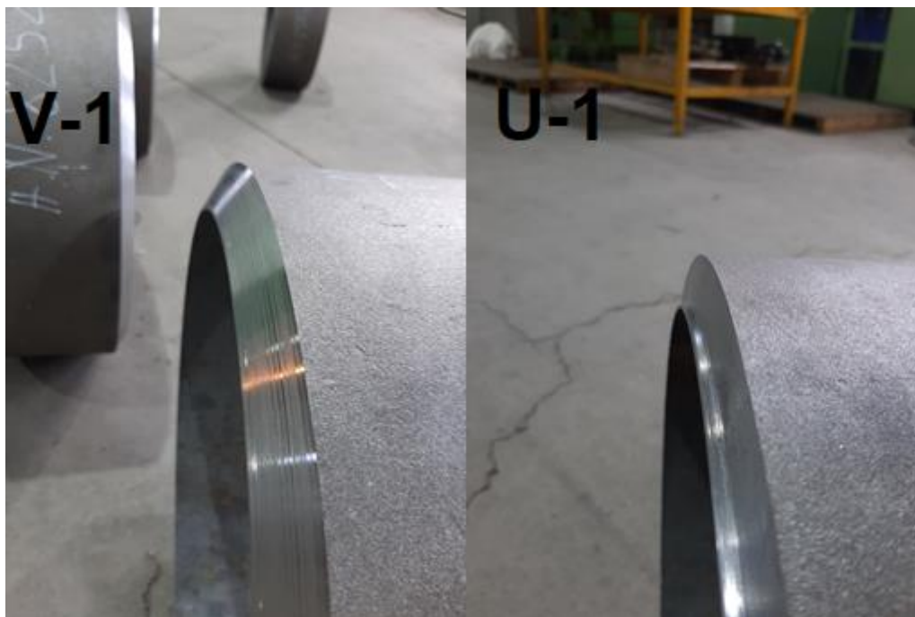
Slika 35. Tokarene epruvete V pripreme (lijevo) i U pripreme (desno)
