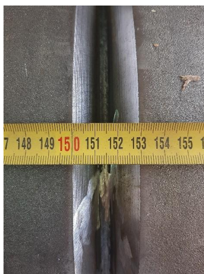
Slika 42. Lice korijena epruvete V-1
