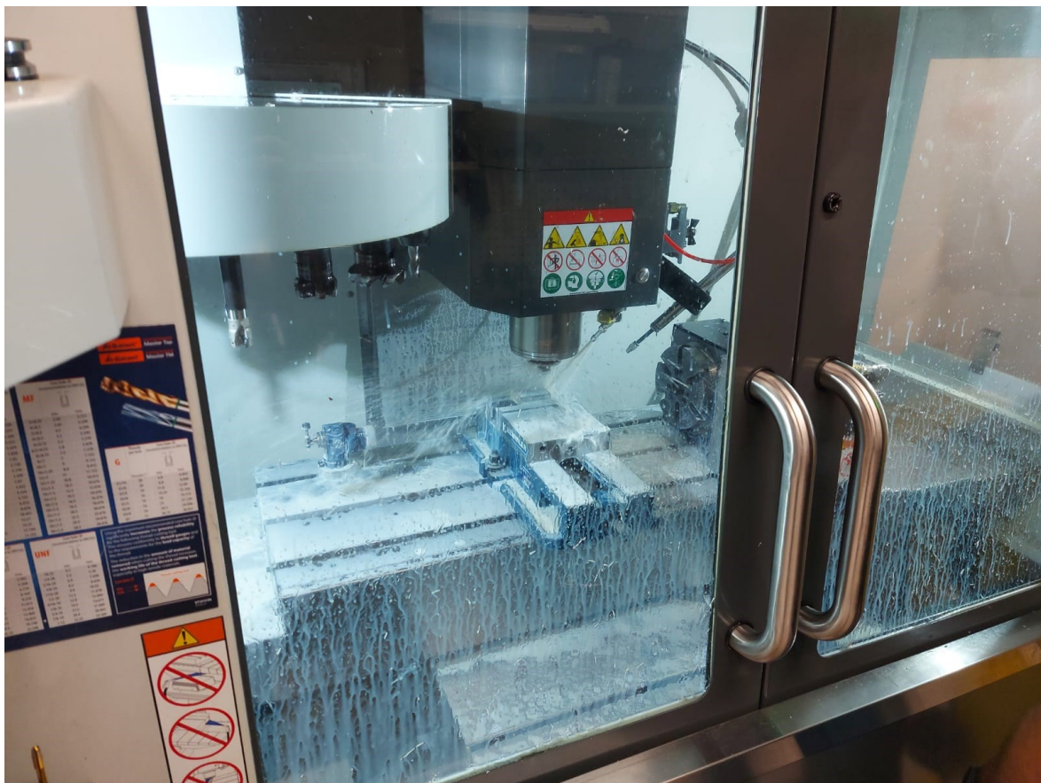
Slika 37. Izrada nosača motora na CNC stroju
