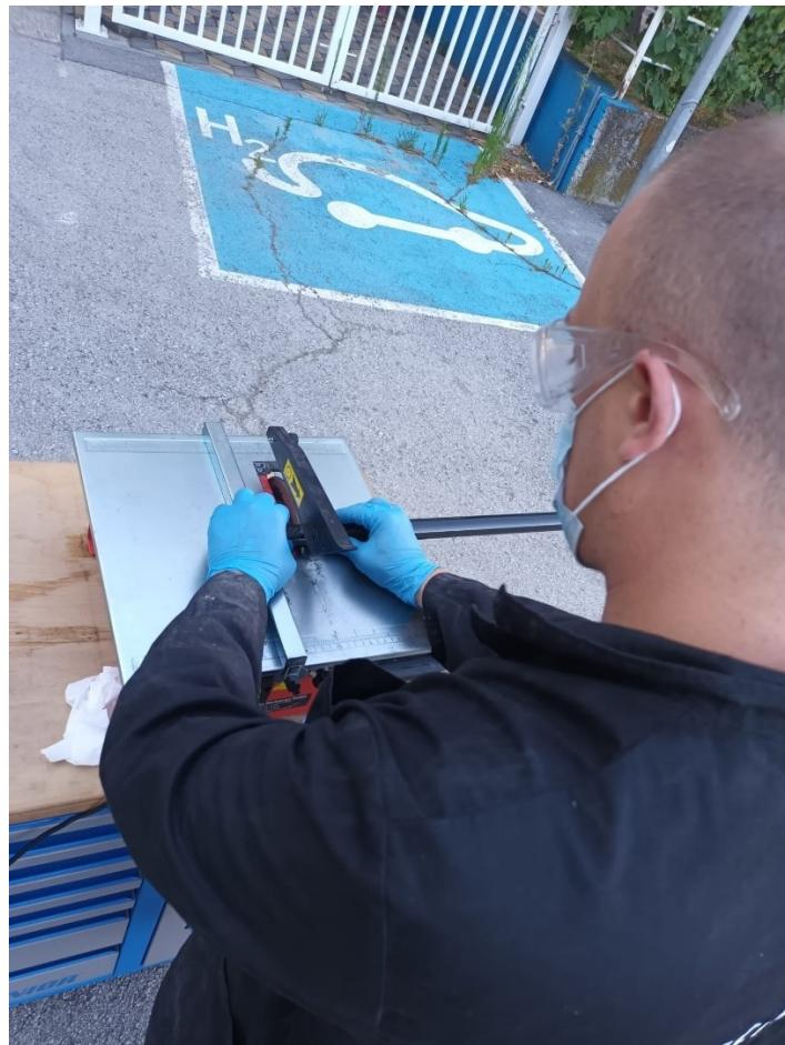
Slika 38. Izrezivanje karbon kompozit cijevi
