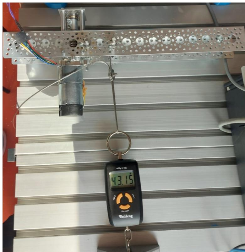
Slika 33. Testiranje sustava za namatanje sajle
