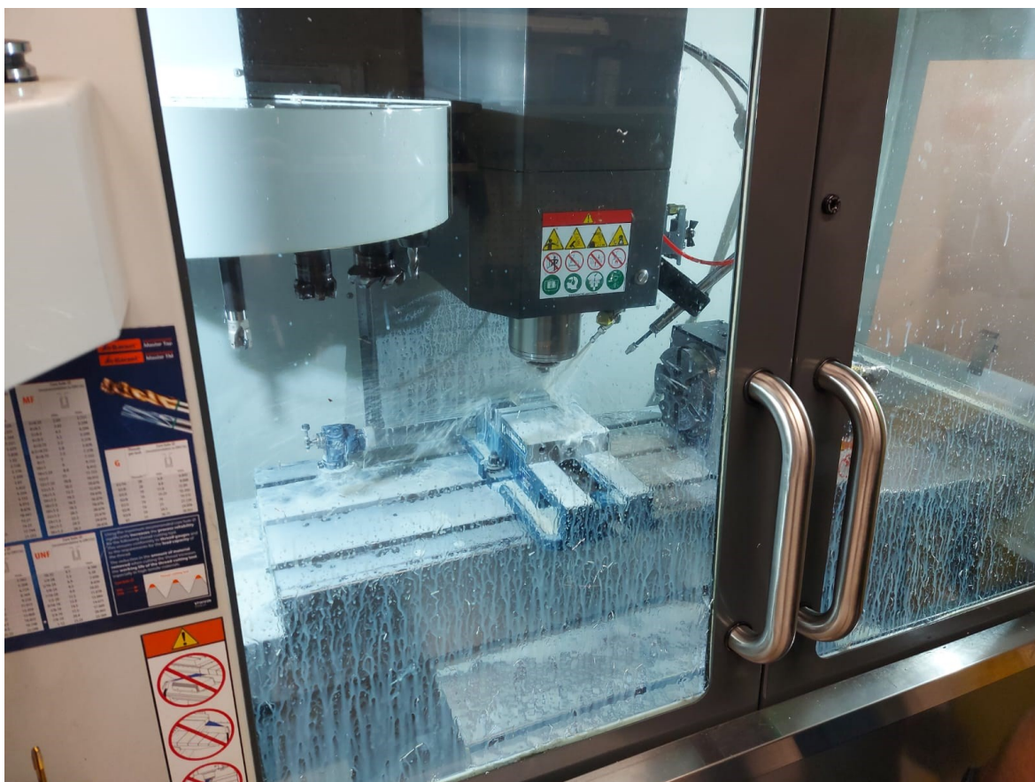
Slika 37. Izrada nosača motora na CNC stroju
