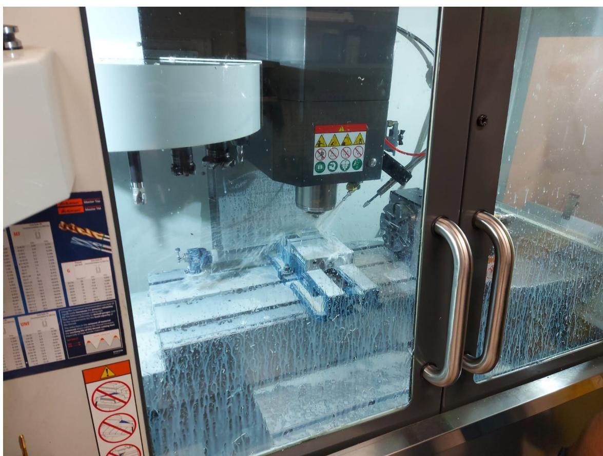
Slika 37. Izrada nosača motora na CNC stroju
