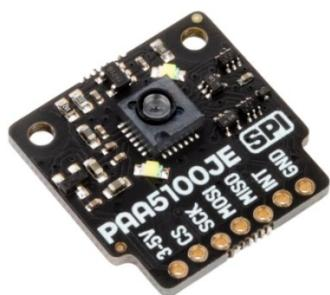
**Slika 9. Optički senzor pomaka PAA5100JE[]**
