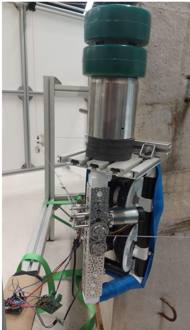
Slika 36. Testiranje nosivosti robota
