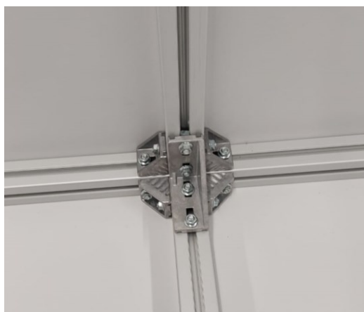
Slika 31. Spoj profila na testnom postavu
