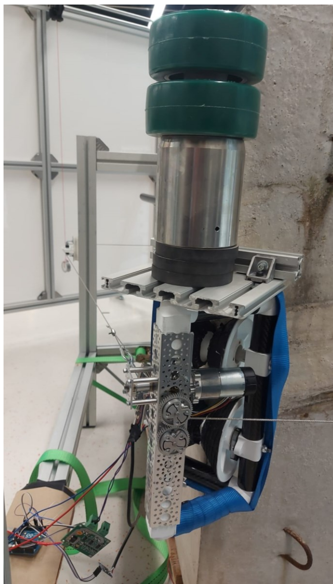
Slika 36. Testiranje nosivosti robota
