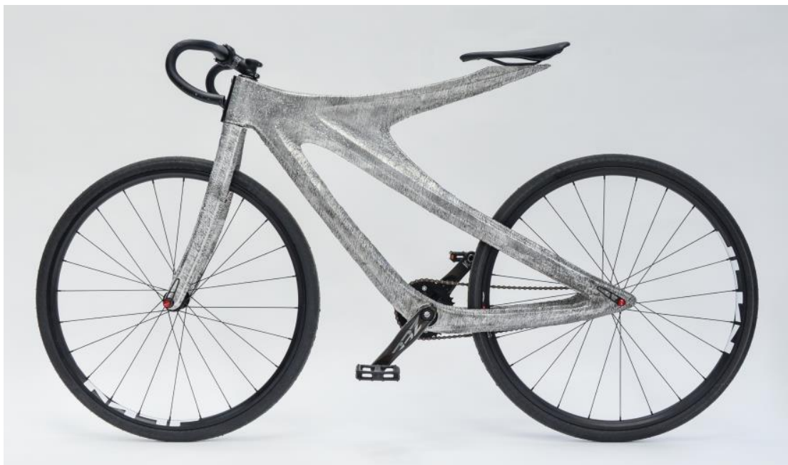
Slika 16. Aluminijski bicikl proizveden WAAM postupkom [15]
