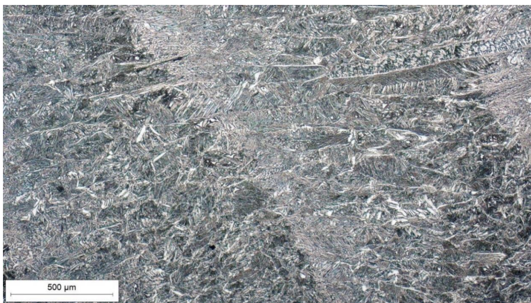
Slika 30. Mikrostruktura toplinski neobrađenog uzorka snimljena pri povećanju 50×
