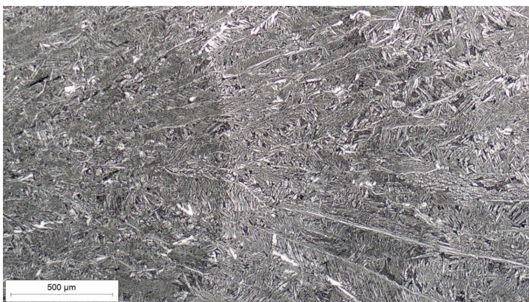
Slika 31. Mikrostruktura toplinski obrađenog uzorka snimljena pri povećanju 50×
