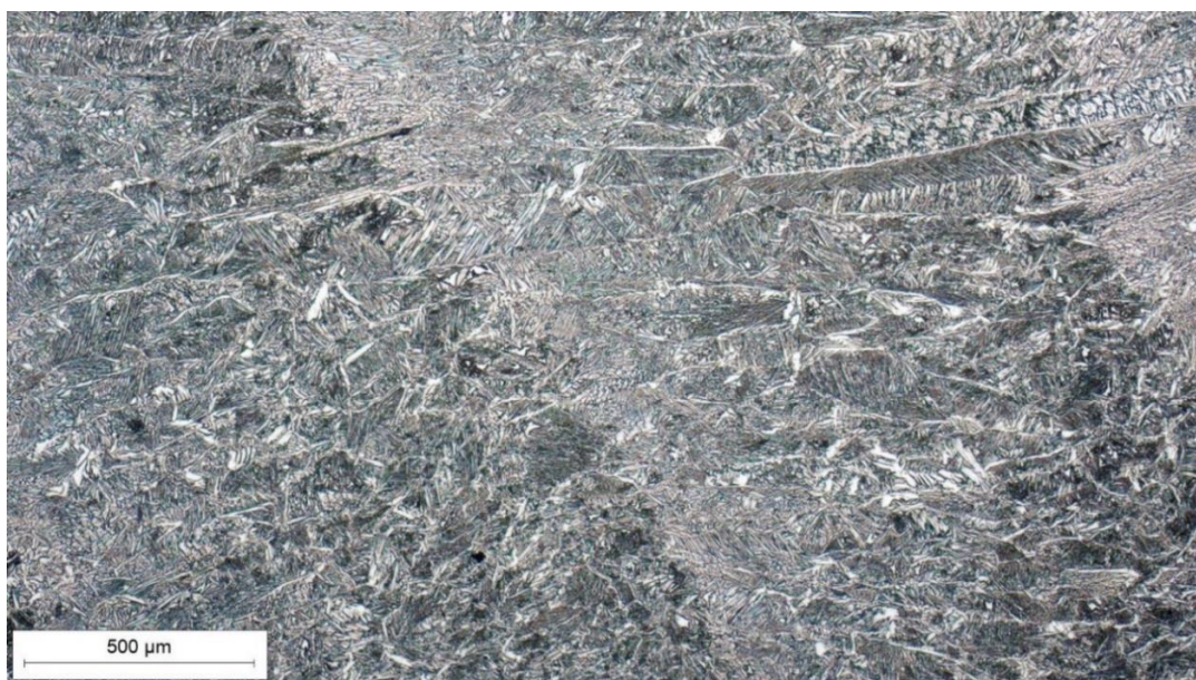
Slika 30. Mikrostruktura toplinski neobrađenog uzorka snimljena pri povećanju 50×
