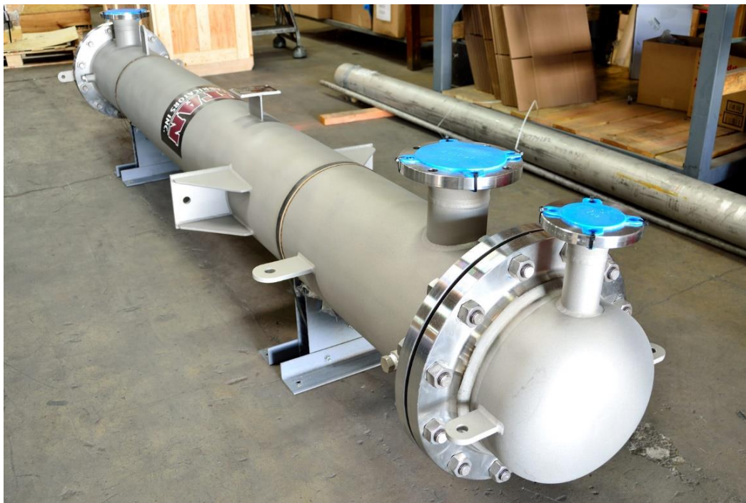
Slika 2. Izmjenjivač topline od čelika oznake X2CrNiMoN22-5-3 [5]
