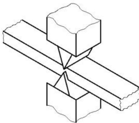
Slika 9. Postupak zasijecanja [8]
