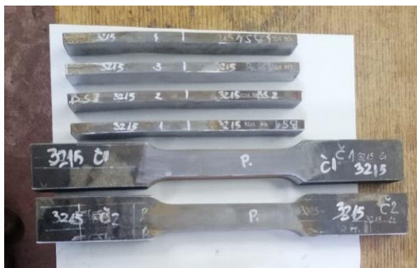
Slika 27. Epruvete dobivene rezanjem vodenim mlazom
