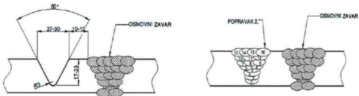
Slika 25. Shematski prikaz drugog popravka
