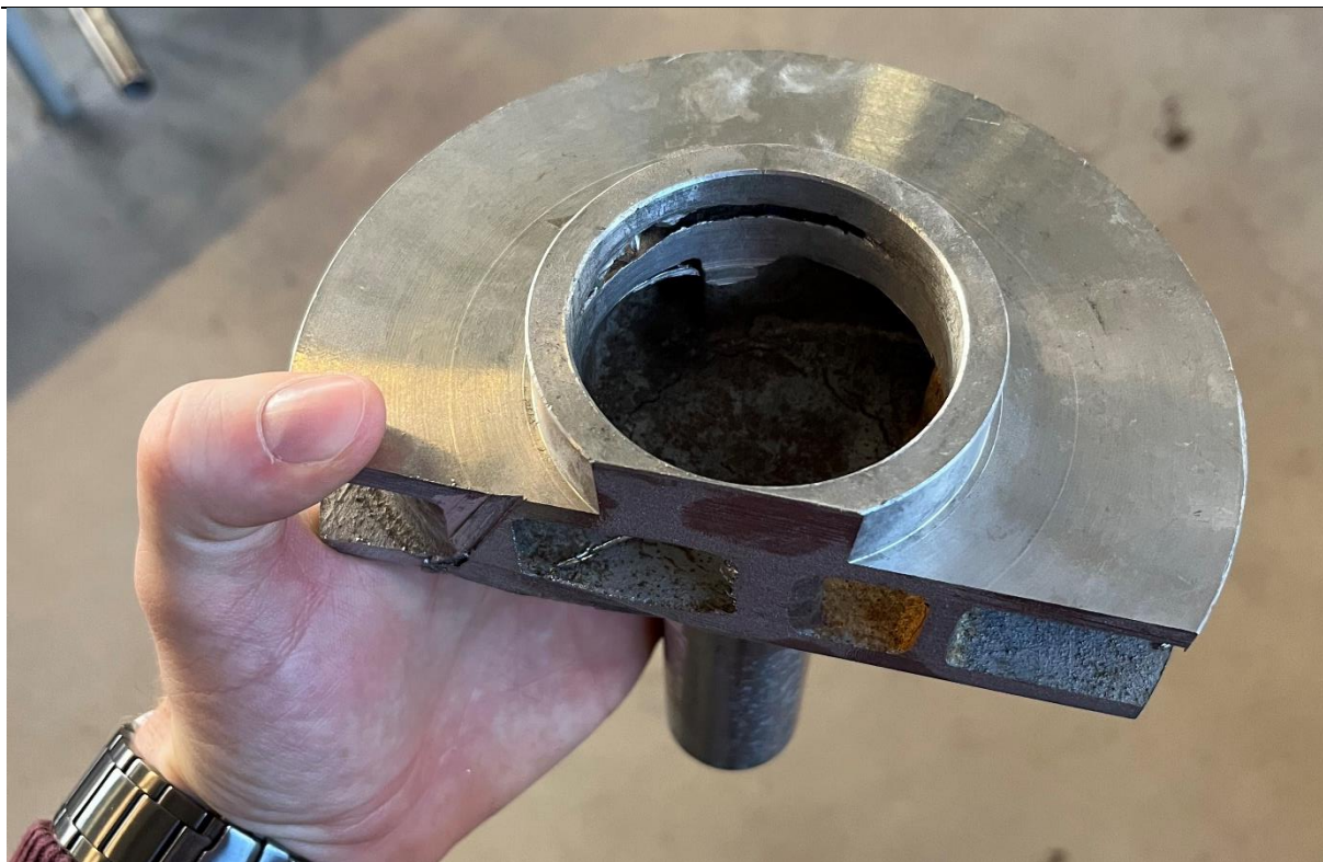
Slika 26. Greške na odljevku
