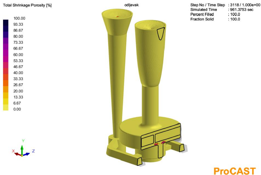
Slika 47. Vjerojatnost nastanka poroznosti u poprečnom presjeku 1
