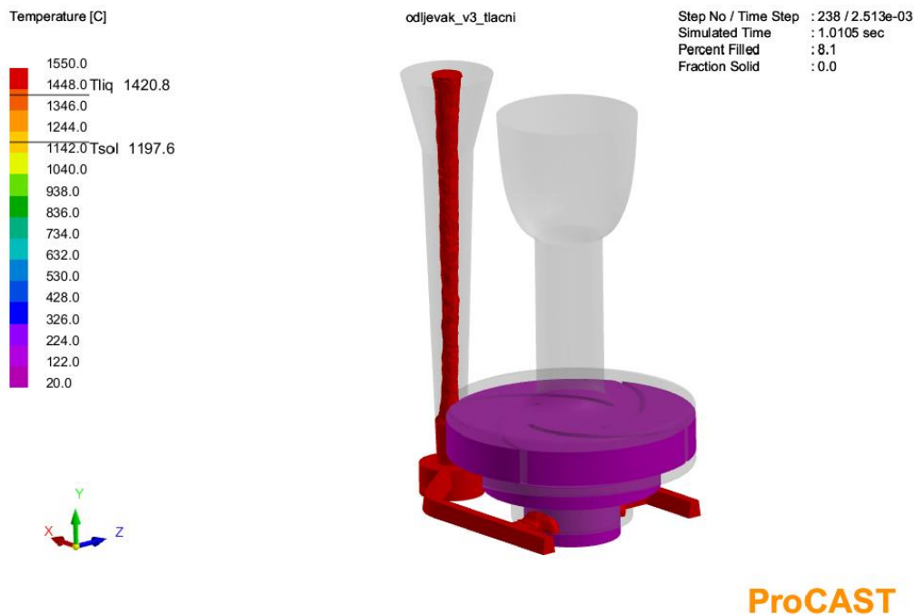
Slika 59. Punjenje kalupne šupljine nakon 1 sekunde
