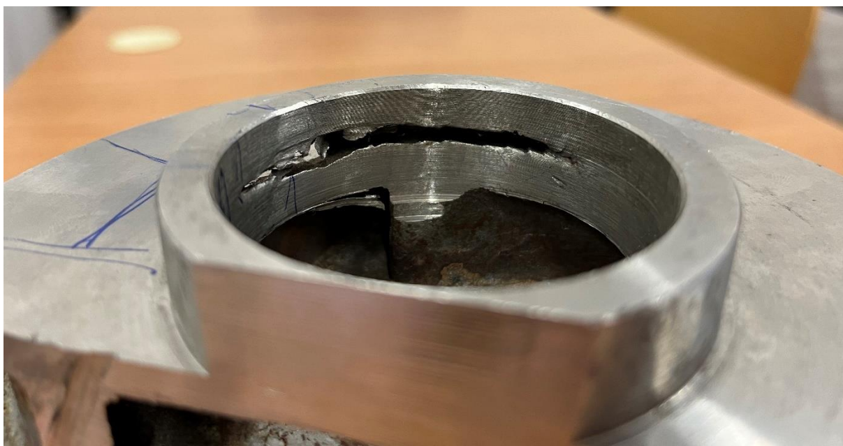
Slika 27. Greške na odljevku, veće povećanje
