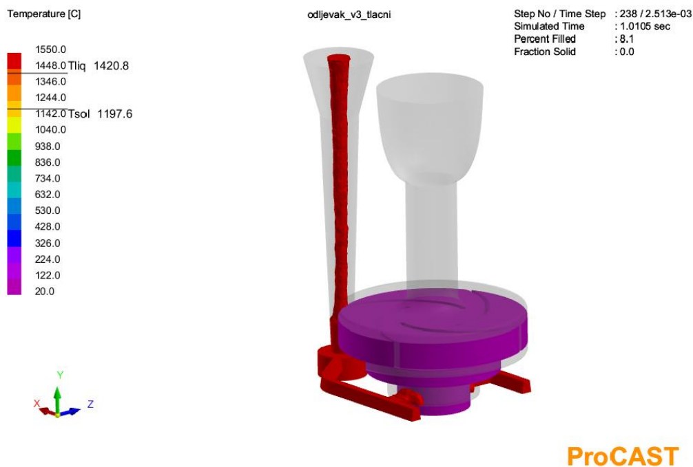
Slika 59. Punjenje kalupne šupljine nakon 1 sekunde
