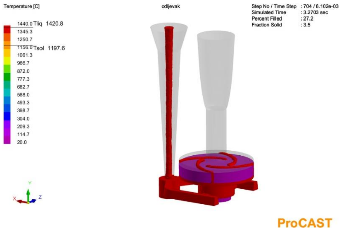
Slika 37. Punjenje kalupa nakon 1,5 sekunde
