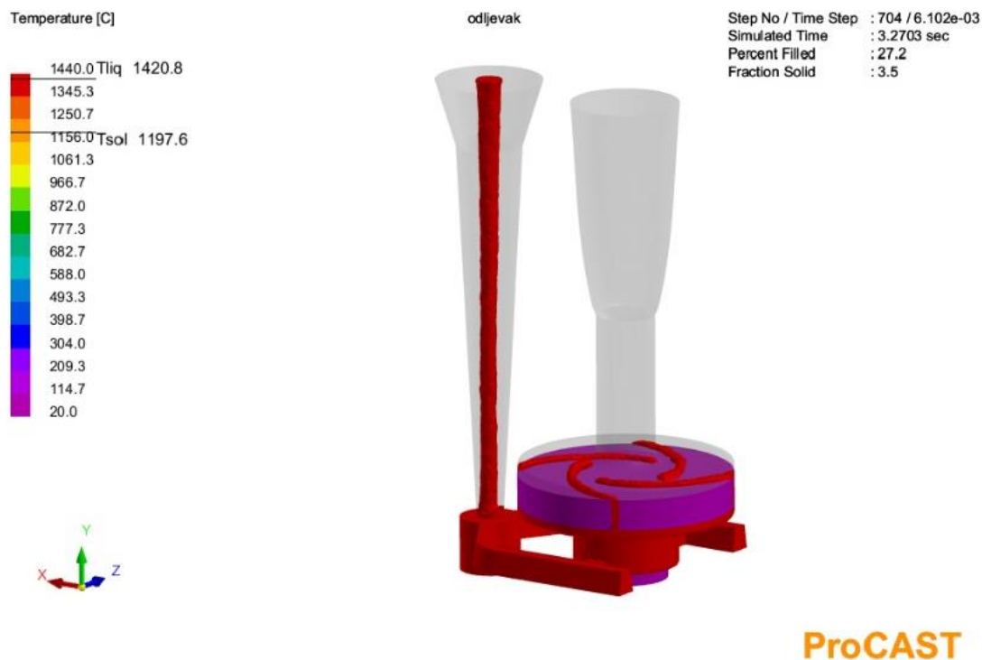
Slika 37. Punjenje kalupa nakon 1,5 sekunde
