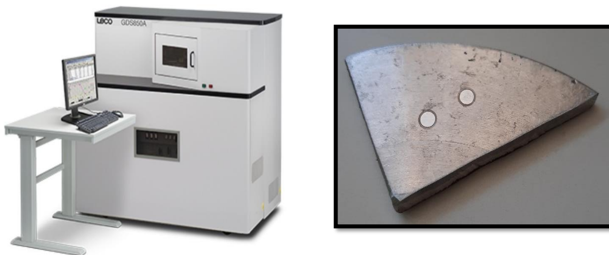
Slika 28. Ispitivanje kemijskog sastava uzorka na optičkom emisijski spektrometar GDS 850A, LECO [15]
