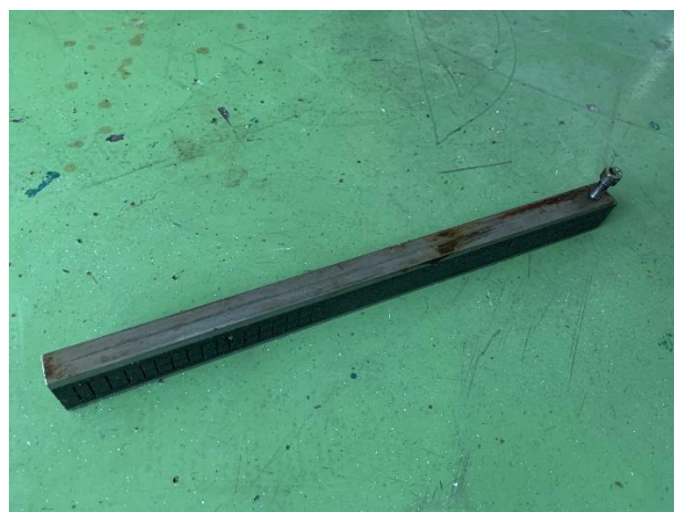
Slika 44. Polimerna masa na klinu za regulaciju zračnosti vodilica
