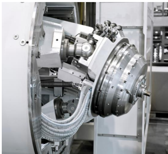
Slika 10. Primjer stroja s paralelnom kinematikom [8]
