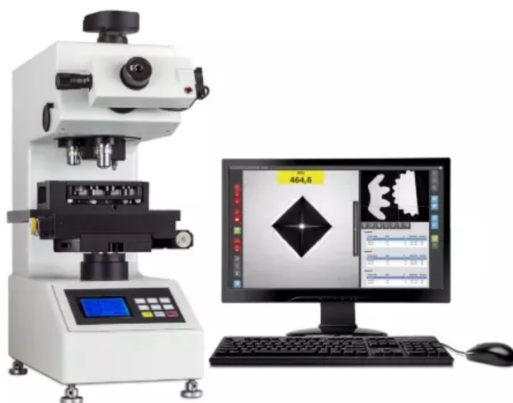
Tablica 6.2. Tvrdomjer - uređaj za mjerenje mikrotvrdoće [41]
