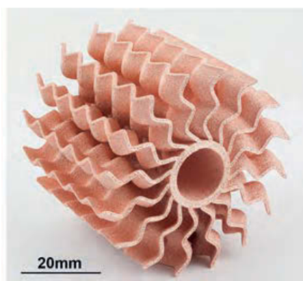
Slika 3.5. Prototip izmjenjivača topline izrađenog od čistog bakra [7]
