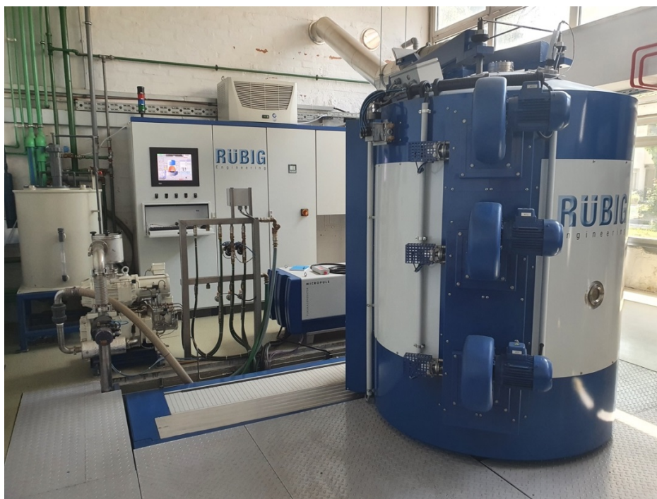
Slika 7.4. Postrojenje za PACVD postupak
