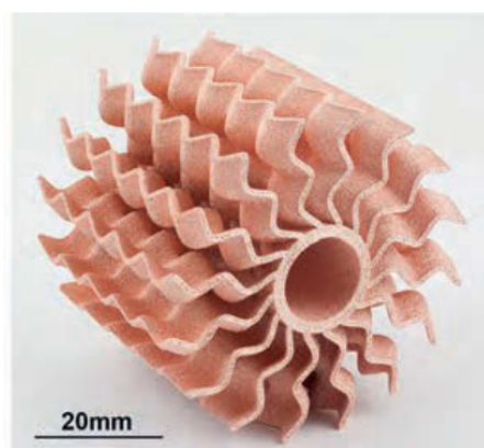
Slika 3.5. Prototip izmjenjivača topline izrađenog od čistog bakra [7]
