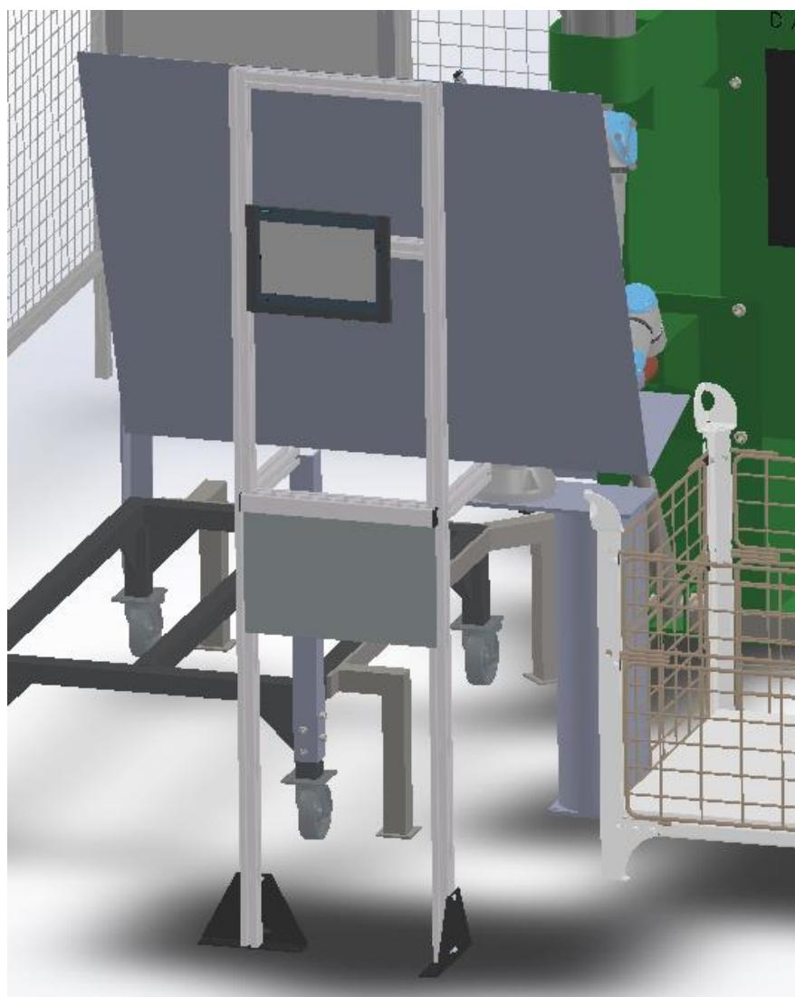
Slika 78. HMI panel na robotskoj stanci za varenje matica
