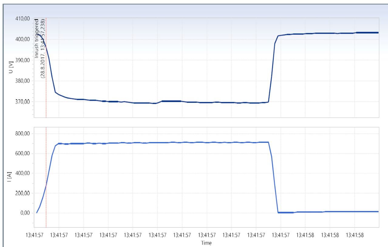
Slika 20. Snimljeni ciklus struje varenja [20]
