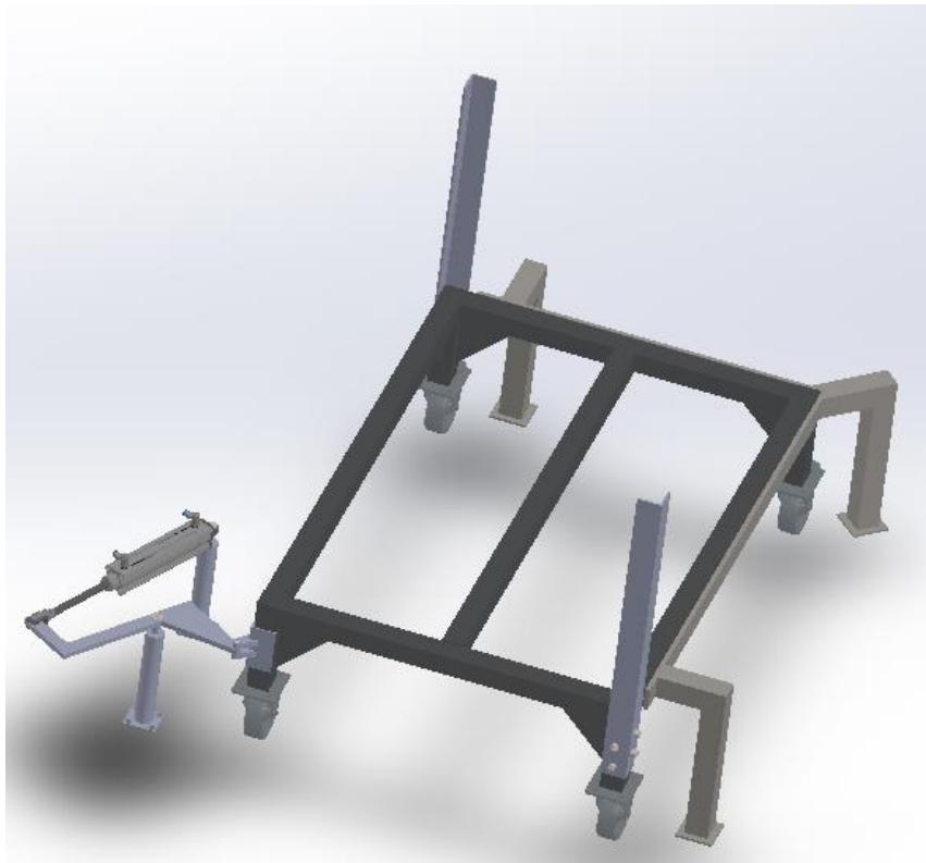
**Slika 46.** Kolica s mehanizmom za zaključavanje
