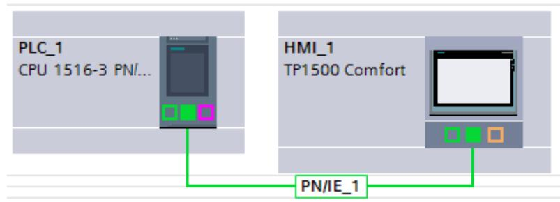
**Slika 67. Prikaz PROFInet komunikacije PLC-HMI u TIA Portal-u**
