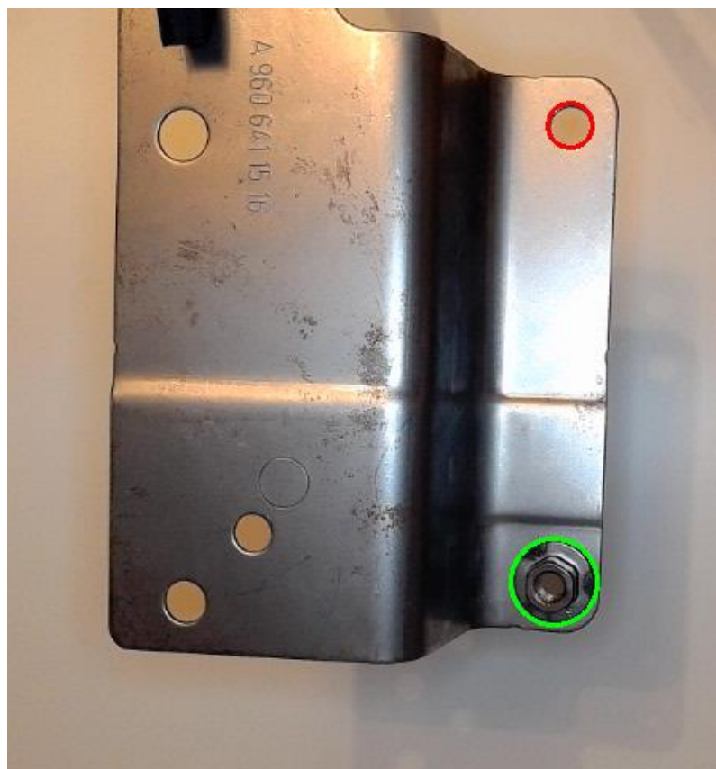
Slika 99. Vizijska kontrola dijela - zavarena samo druga matica
