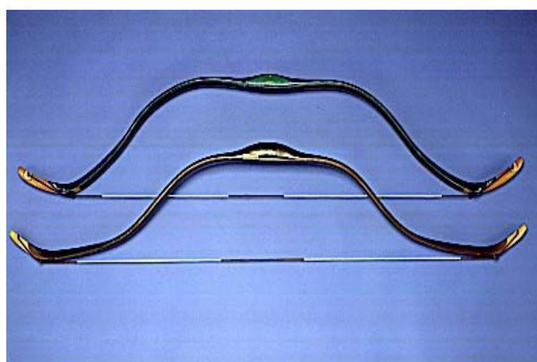
Slika 2.8. Luk napravljen od kompozita ojačanim prirodnim vlaknima [5]
