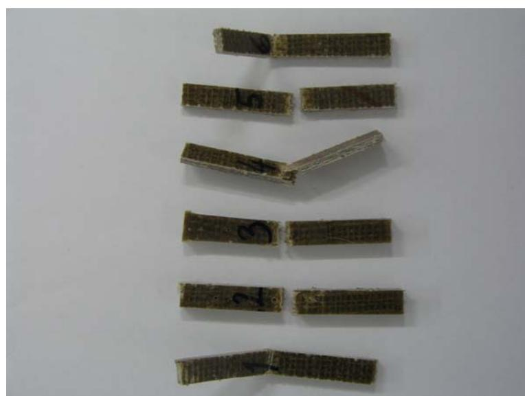
Slika 4.27. Uzorci nakon ispitivanja žilavosti
