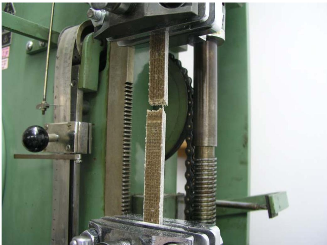
Slika 4.15. Ispitivanje uzorka na kidalici
