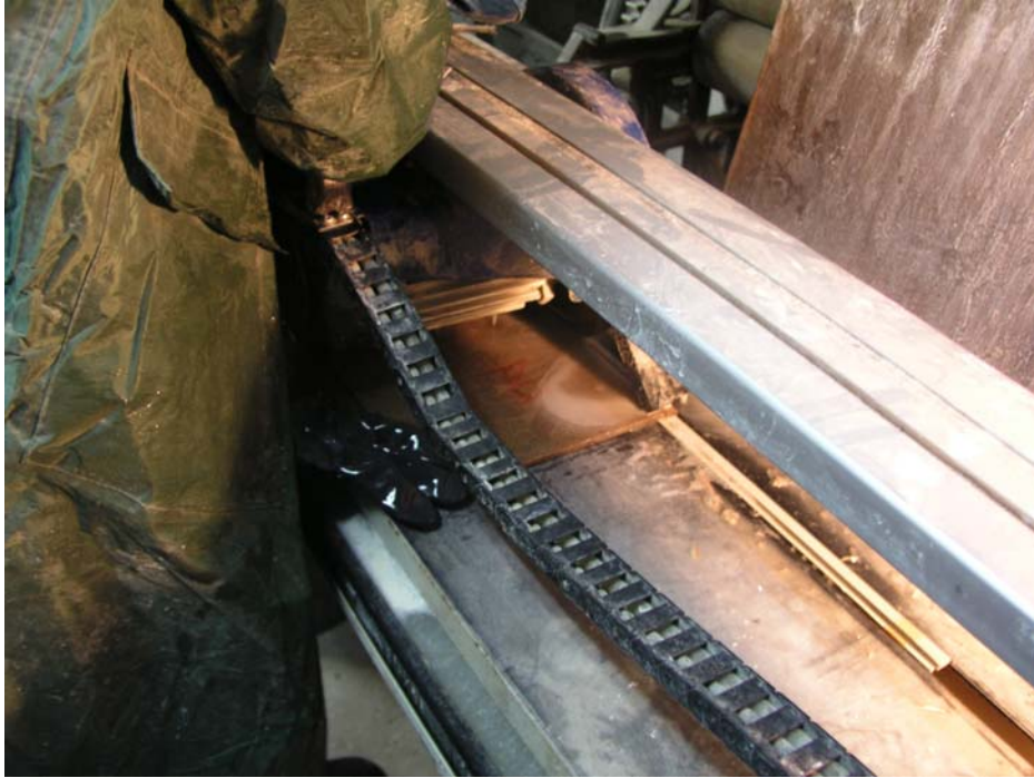
Slika 4.12. Rezanje uzoraka iz kompozitnih ploča
