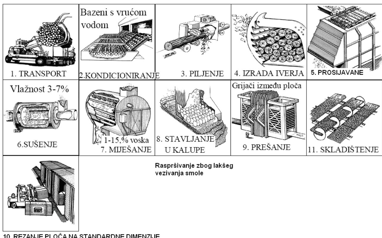
Slika 3.3. Proces proizvodnje lijepljenih ploča s usmjerenim iverjem [8]
