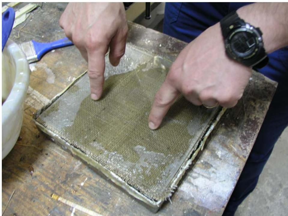
Slika 4.8. Stavljanje stakla na slojeve jute
