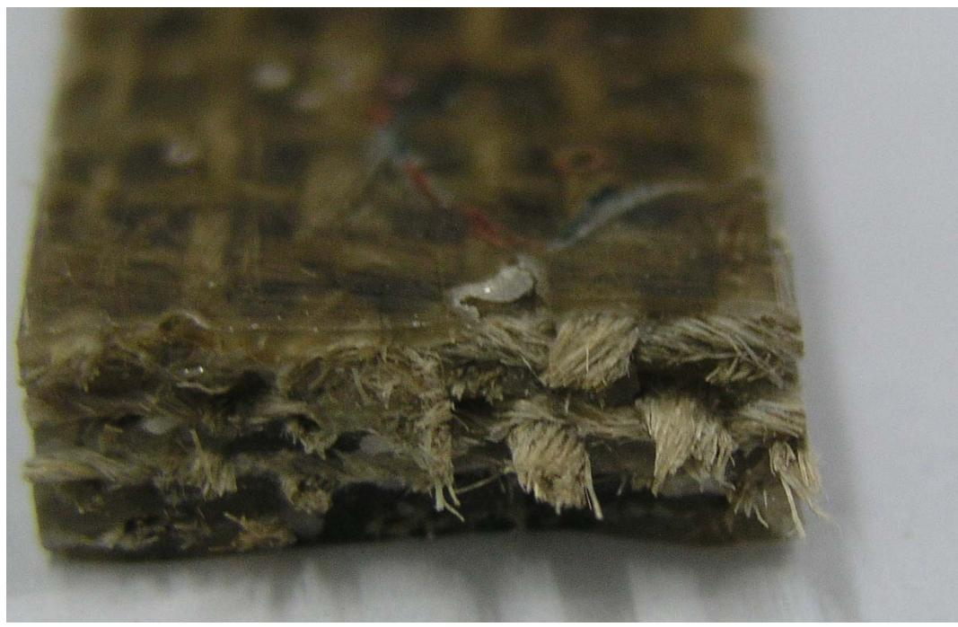
Slika 4.16. Presjek uzorka nakon ispitivanja vlačne čvrstoće
