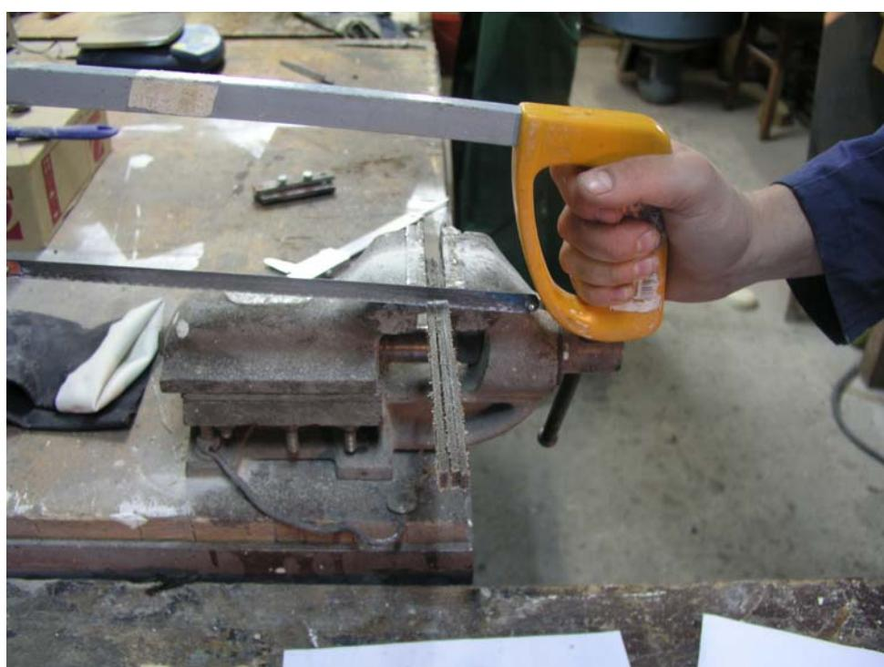
Slika 4.13. Rezanje uzoraka ručnom pilom
