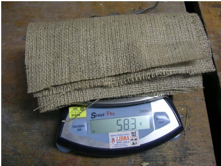
Slika 4.4 Mjerenje mase slojeva jute
