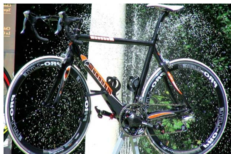
Slika 2.7. Bicikl napravljen od vlakana lana i ugljika [7]
