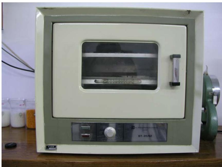
Slika 4.11. Sušenje uzoraka u termostatu
