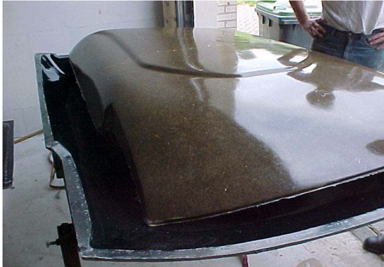
Slika 2.6. Krov automobila načinjen od vlakana lana [5]
