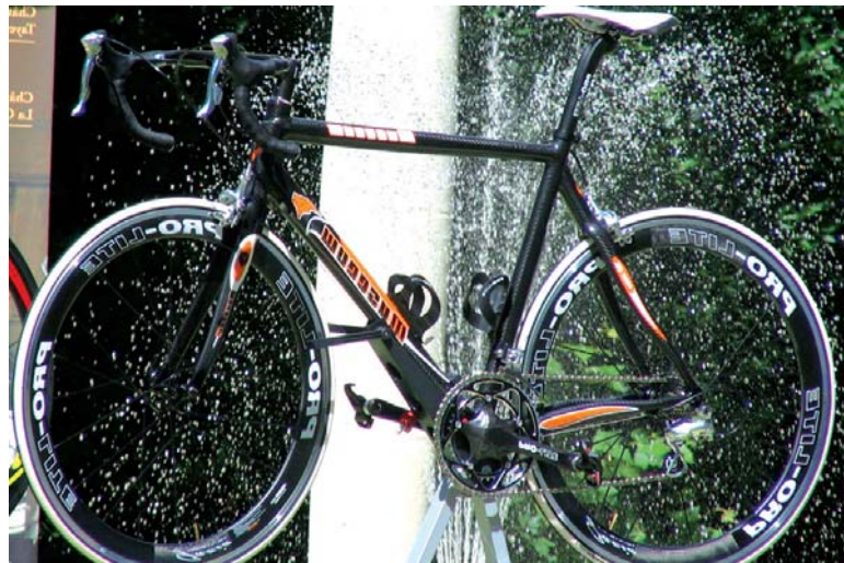
Slika 2.7. Bicikl napravljen od vlakana lana i ugljika [7]
