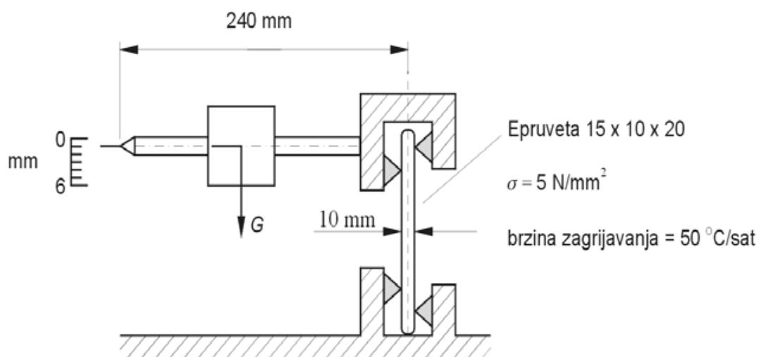
Slika 4.28. Određivanje temperature postojanosti oblika po Martensu [10]
