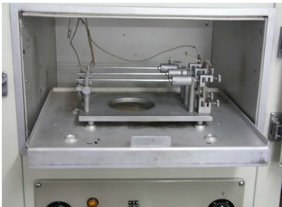
Slika 4.29. Uređaj za ispitivanje toplinskih – mehaničkih svojstava duromera po Martensu
