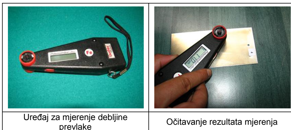
Slika 14. Mjerenje uređajem za mjerenje debljne prevlake
