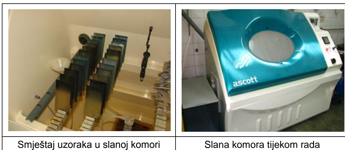
Slika 15. Slana komora u Laboratoriju za zaštitu materijala Fakulteta strojarstva i brodogradnje u Zagrebu
