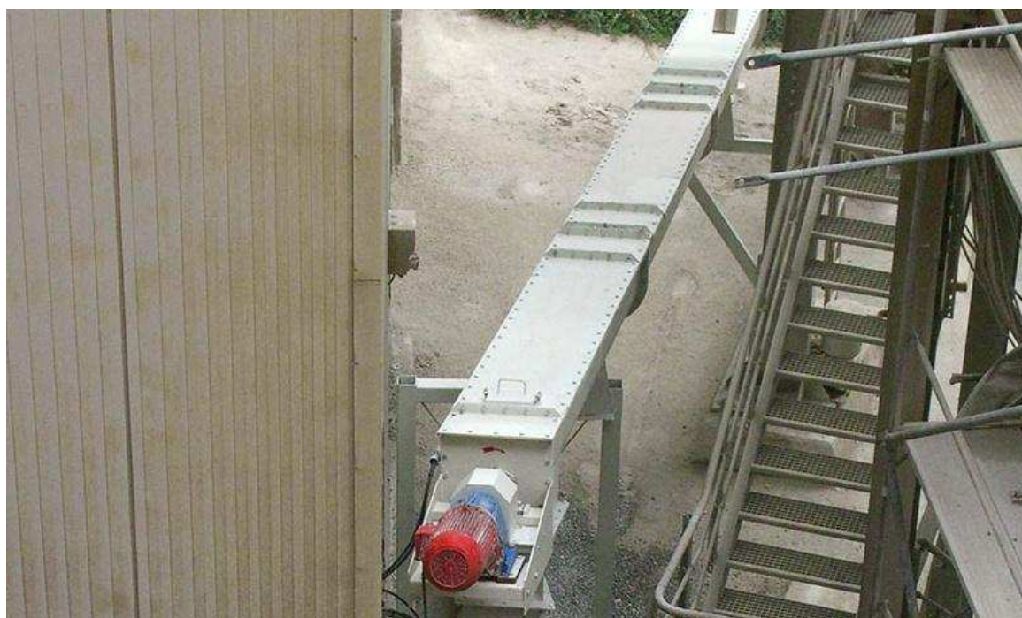
Slika 14. BBM Ehrhardt veliki pužni konvejer s jednom pužnicom [8]
