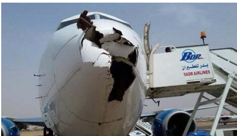
Slika 3. Oštećenje trupa zrakoplova zbog udara ptice [5]
