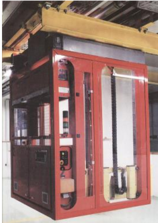
Slika 10. Standardizirani spremnik-„Bin“ i paletirka
