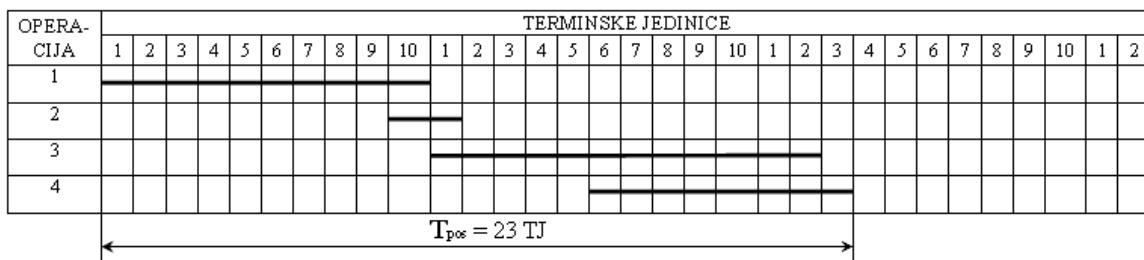
Slika 3. Gantogramski prikaz paralelnog ciklusa proizvodnje, [4]
