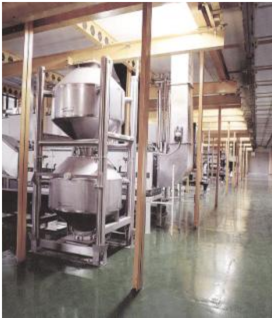
Slika 10. Standardizirani spremnik-„Bin“ i paletirka
