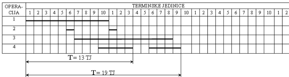
Slika 4. Gantogramski prikaz kombiniranog ciklusa proizvodnje, [4]
