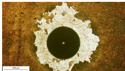
Slika 44. Rockwell-ov C tvrdomjer za ispitivanje prionjivosti, otisci na uzorcima T2 i T10 (ostatak mjerenja u prilogu)
