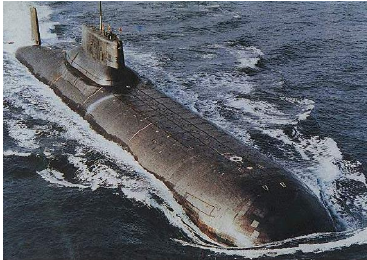
Slika 8. Podmornica s trupom od titanijeve legure [7]
