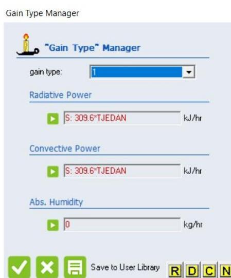
Slika 24 Primjer definiranja unutarnjih dobitaka u sučelju TRNBuild
