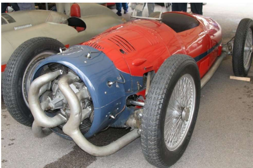
Slika 4. Trkaći automobil Monaco-Trossi sa šesnaesterocilindričnim dvorednim dvotaktnim zvjezdastim motorom [6]
