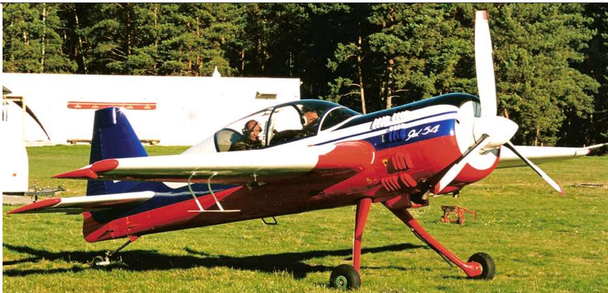
Slika 6. Sportski zrakoplov Jakovljev Jak-54 s deveterocilindričnim zvjezdastim motorom [8]
