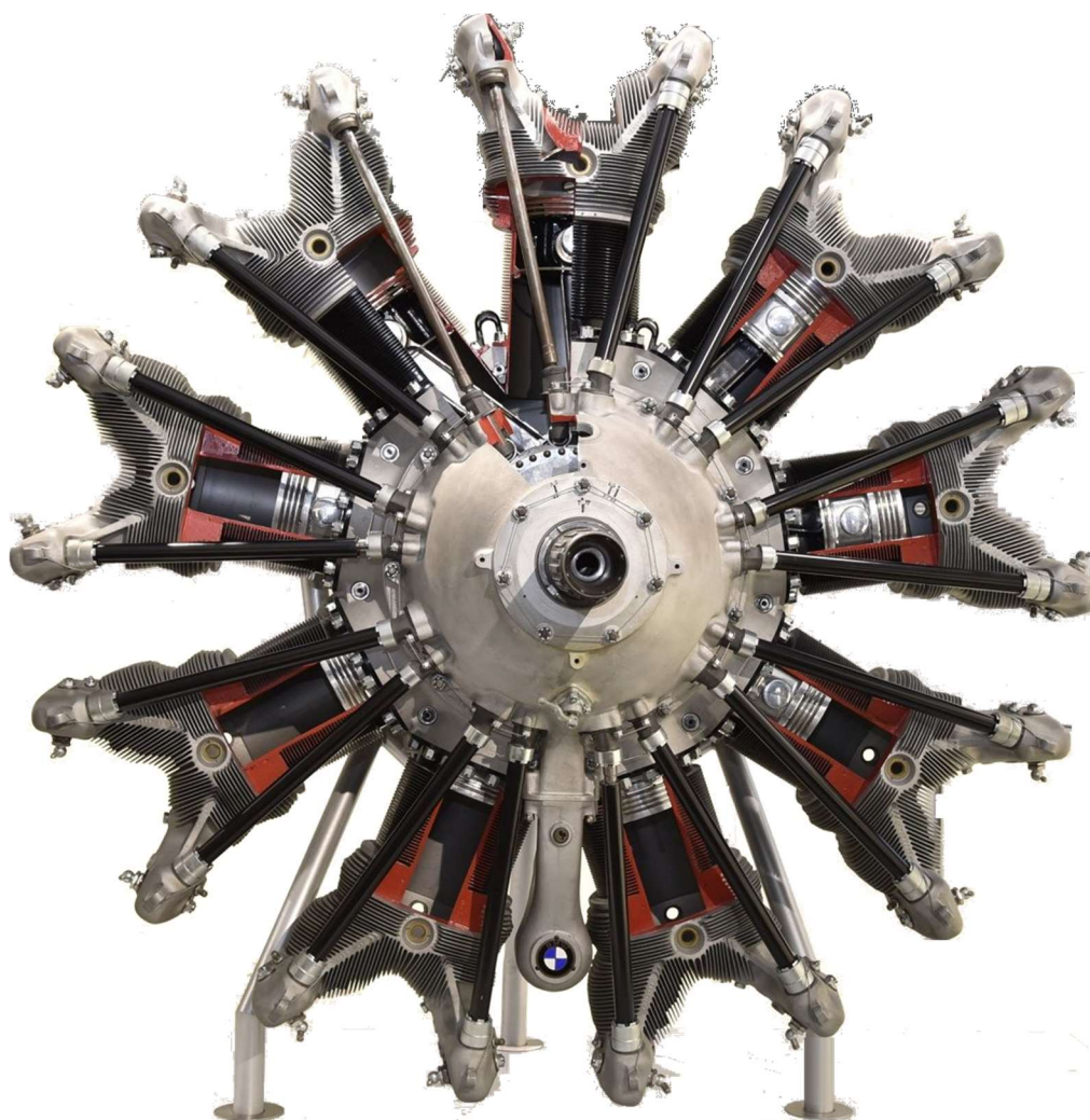
Slika 1. Deveterocilindrični zrakoplovni zvjezdasti motor BMW 132 [2]
