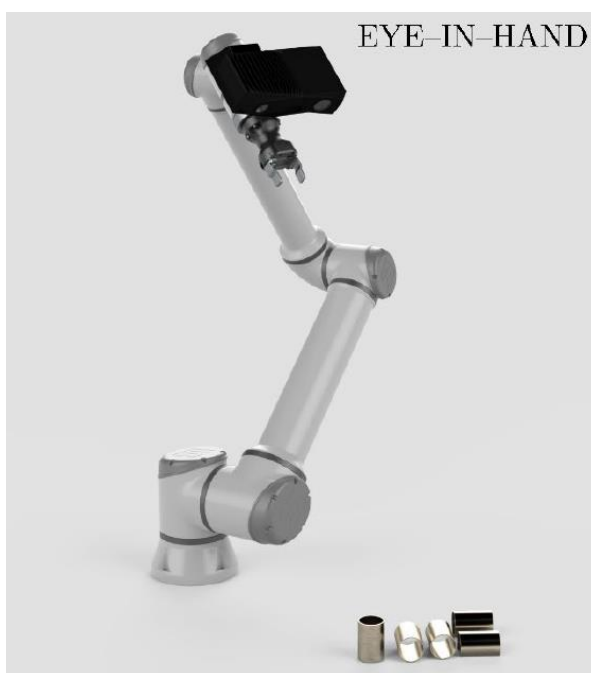
Slika 8. Eye in Hand princip rada [8]
