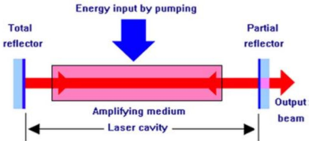
Slika 12. Dijelovi lasera [9]
