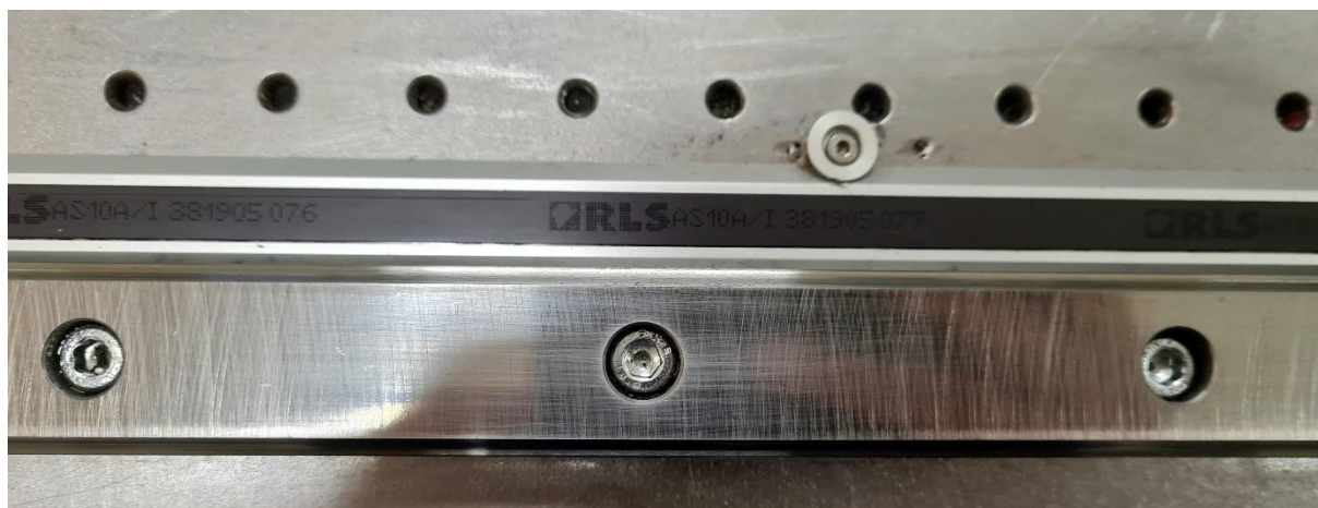
Slika 32. RLS magnetna traka postavljena u laboratoriju
