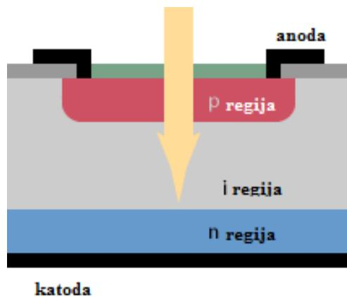
Slika 18. PIN fotodioda [17]
