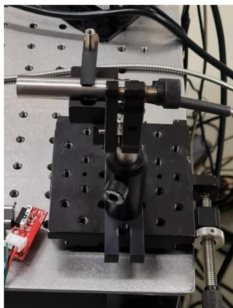
**Slika 36. Spojeni elementi za pozicioniranje laserske zrake**
