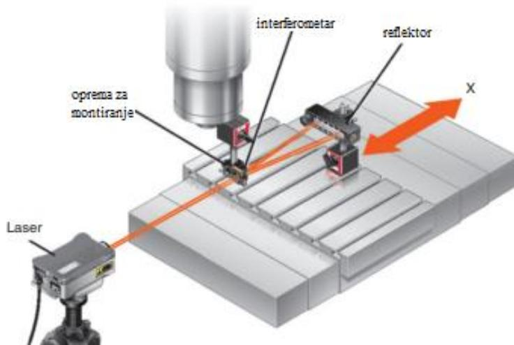
**Slika 15. Skica sustava za mjerjenje pravocrtnosti pomoću interferometra [14]**
