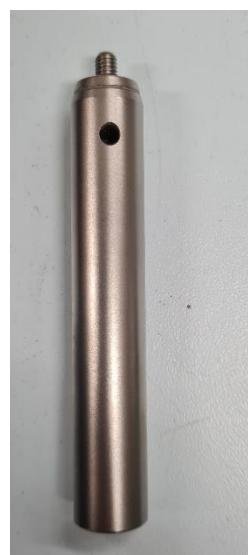
Slika 38. Thorlabs TR element za pozicioniranje
