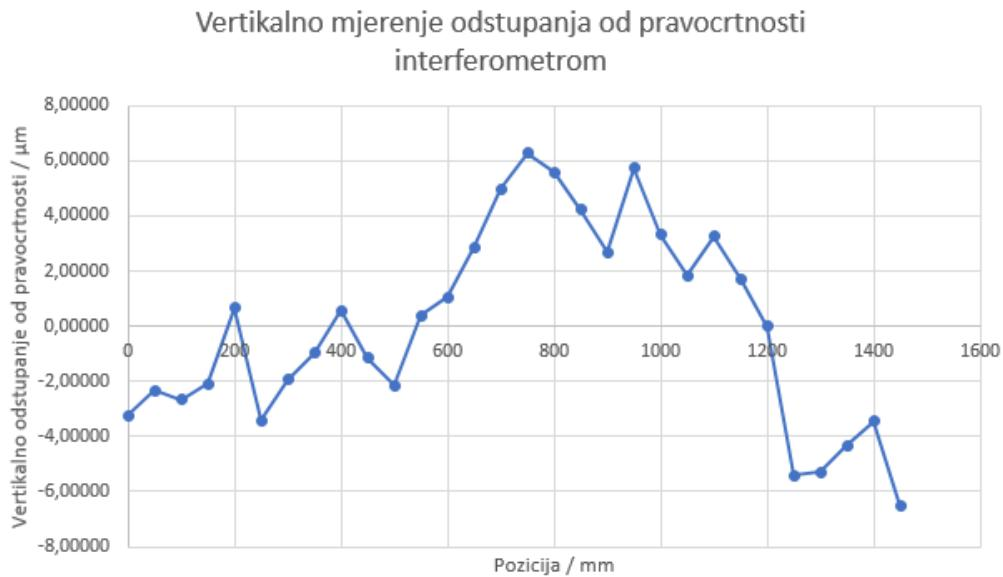
**Slika 44.** Graf vertikalnih odstupanja od pravocrtnosti mjereneh interferometrom
