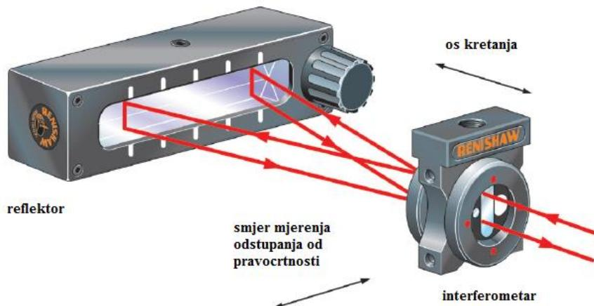
**Slika 16. Horizontalno mjerjenje odstupanja od pravocrtnosti [14]**
