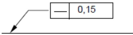
Slika 9. Označavanje odstupanja od pravocrtnosti na tehničkom crtežu [6]
