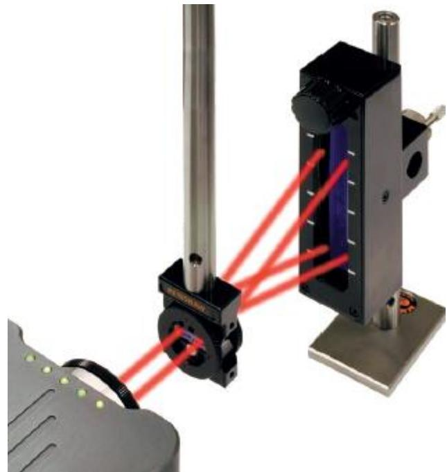
**Slika 17.** Vertikalno mjerjenje odstupanja od pravocrtnosti [14]
