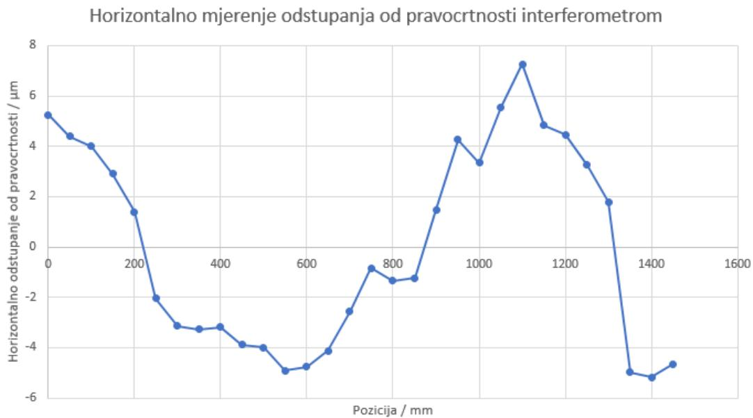
**Slika 43.** Graf horizontalnih odstupanja od pravocrtnosti mjereneh interferometrom
