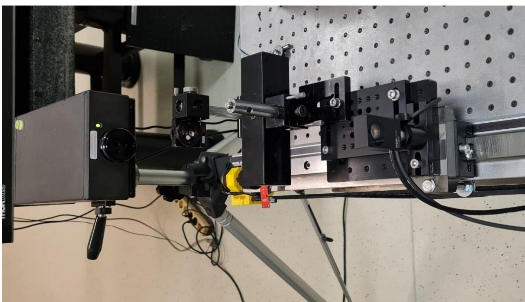
Slika 40. Mjerenje horizontalnih odstupanja pomoću laserskog interferometra
