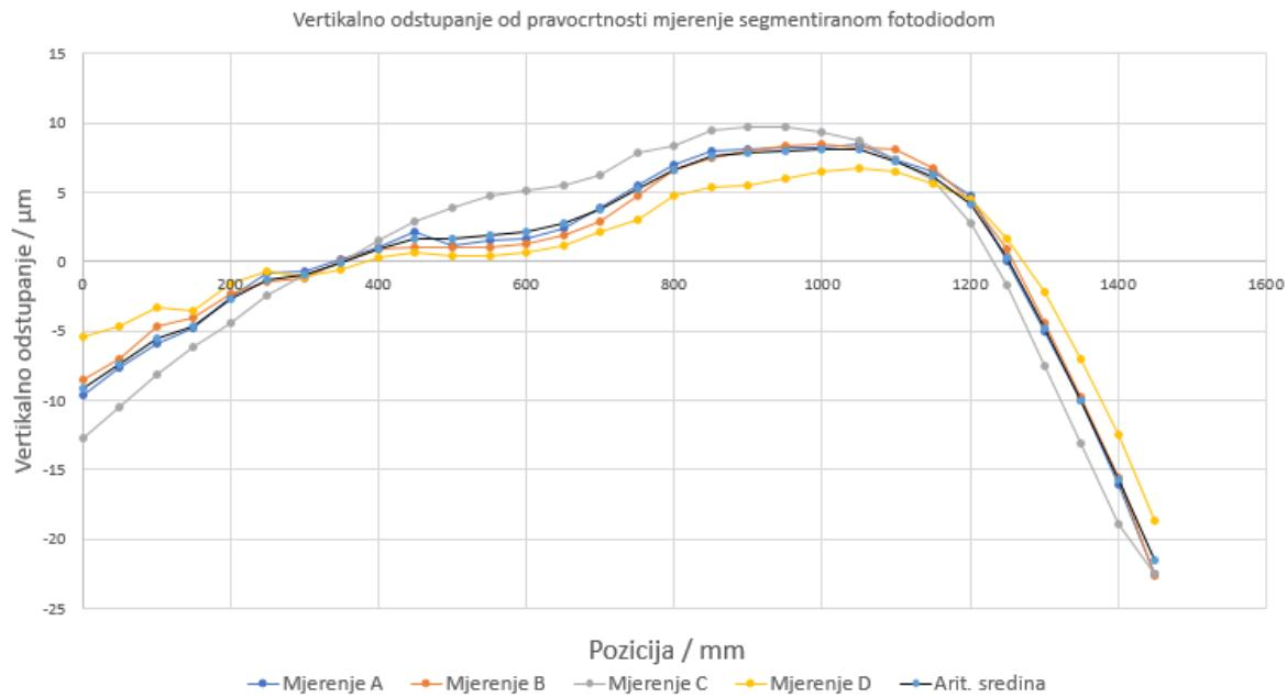
**Slika 48. Graf vertikalnih odstupanja od pravocrtnosti mjerena segmentiranim fotodiodom**
