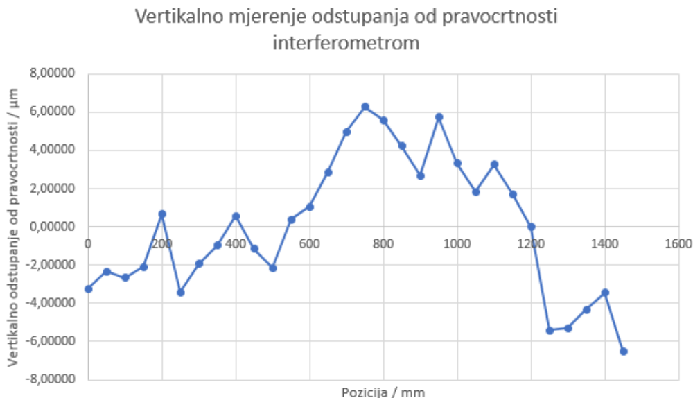
Slika 44. Graf vertikalnih odstupanja od pravocrtnosti mjerenih interferometrom
