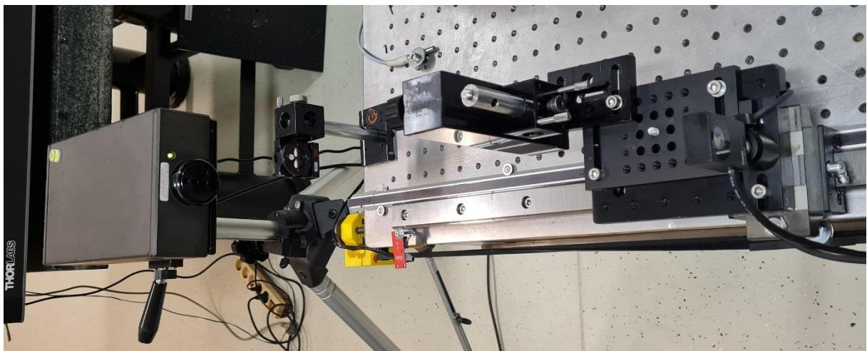
Slika 41. Mjerenje vertikalnih odstupanja pomoću laserskog interferometra
