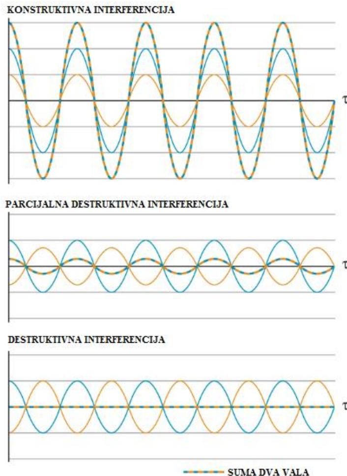
**Slika 13. Konstruktivna i destruktivna interferencija valova [12]**
