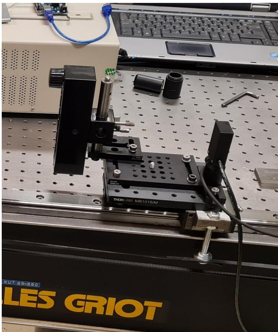
Slika 51. Reflektor i fotodioda različite visine postavljanja
