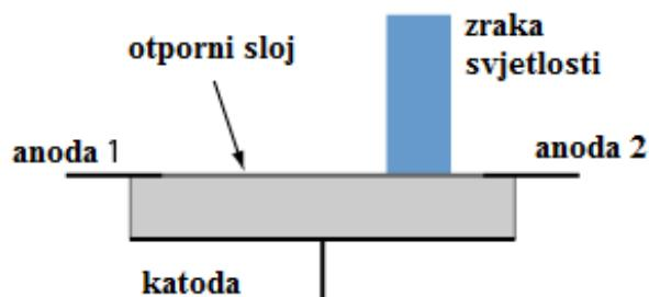
Slika 20. PSD na principu lateralnog efekta [20]
