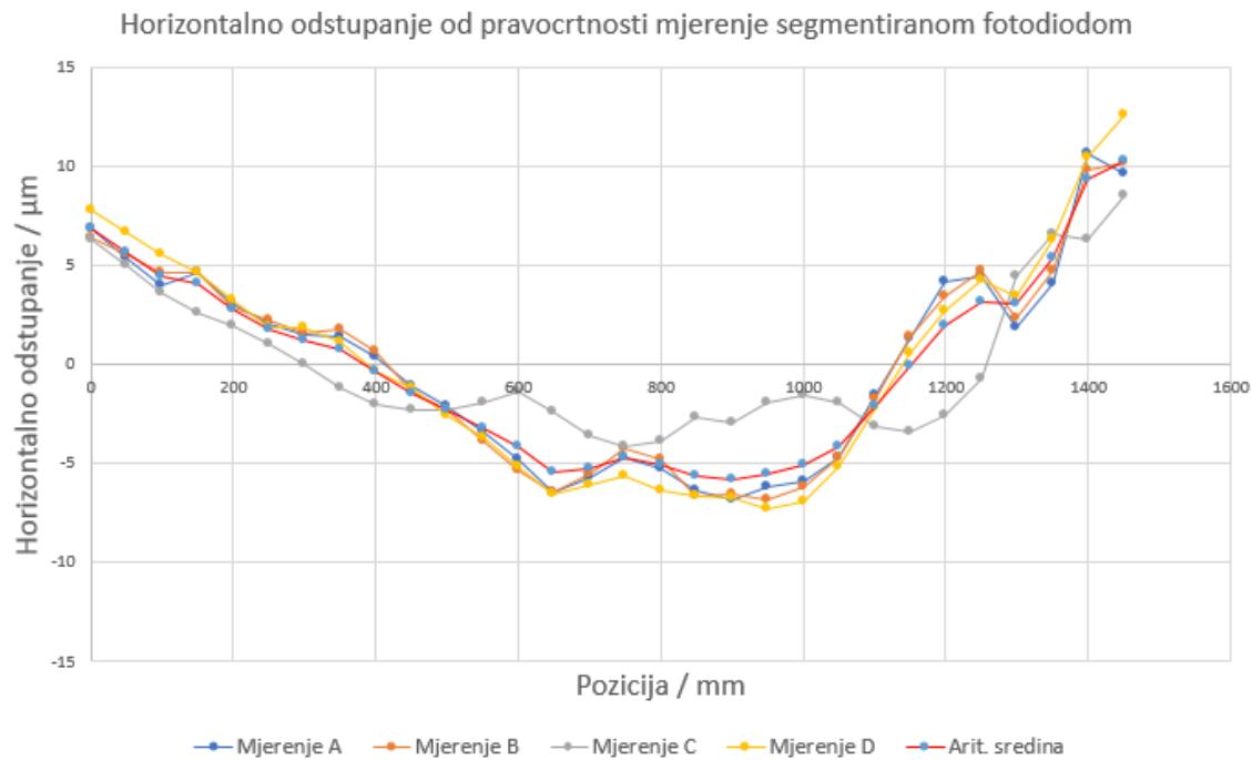
**Slika 46. Graf horizontalnih odstupanja od pravocrtnosti mjerena segmentiranim fotodiodom**
