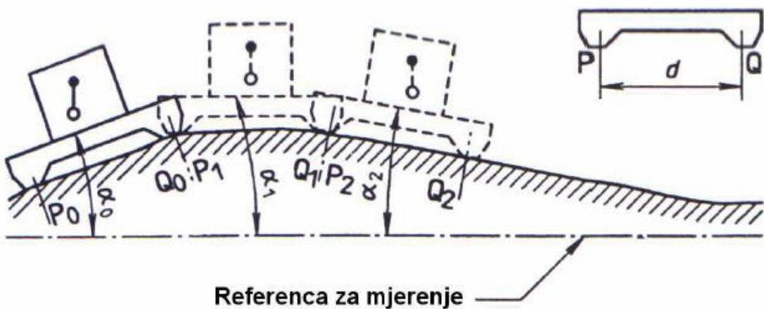
**Slika 11.** Mjerenje odstupanja od pravocrtnosti temeljeno na mjerenuju kutnih odstupanja [7]
