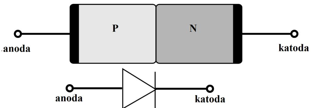
Slika 19. PN fotodioda [18]
