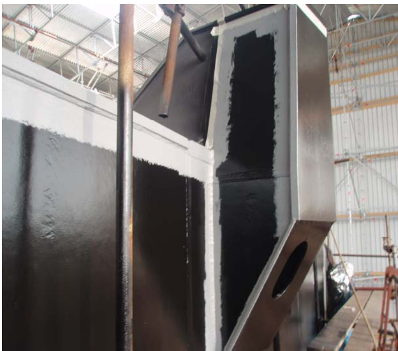
Slika 64. Nanošenje vezivne boje Hempasil nexus 27302, Brodogradilište Uljanik, Pula
