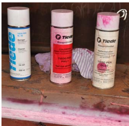
Slika 35. Sprejevi za penetrantsku kontrolu, brodogradilište Uljanik, Pula
