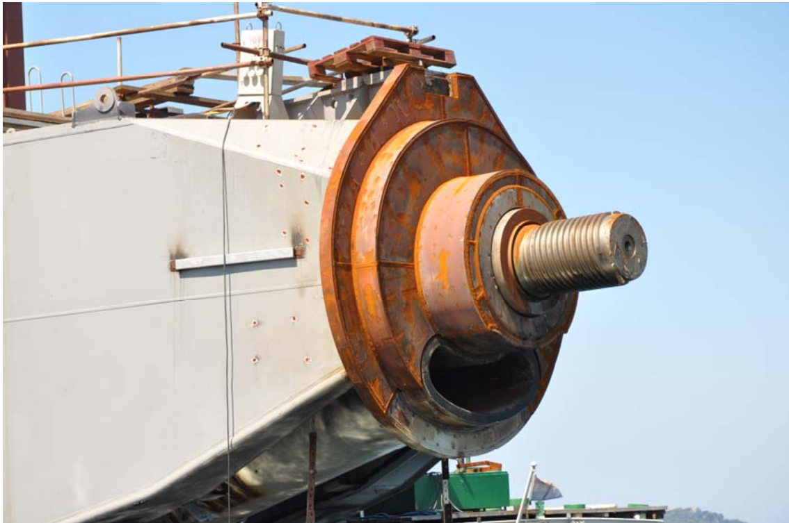
Slika 80. Glava kopača prije montiranja bušećeg svrdla, Brodogradilište Uljanik, Pula
