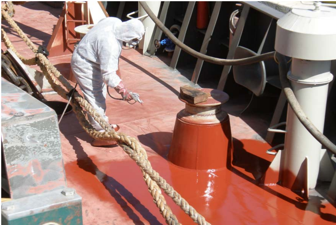
Slika 65. Bojenje završnim premazom glavne palube broda jaružara, detalj iz Brodogradilišta Uljanik, Pula, svibanj 2010.
