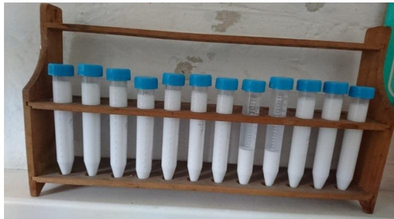
**Slika 7.1** Prikaz provedbe sedimentacijskog testa pripravljenih keramičkih suspenzija.
