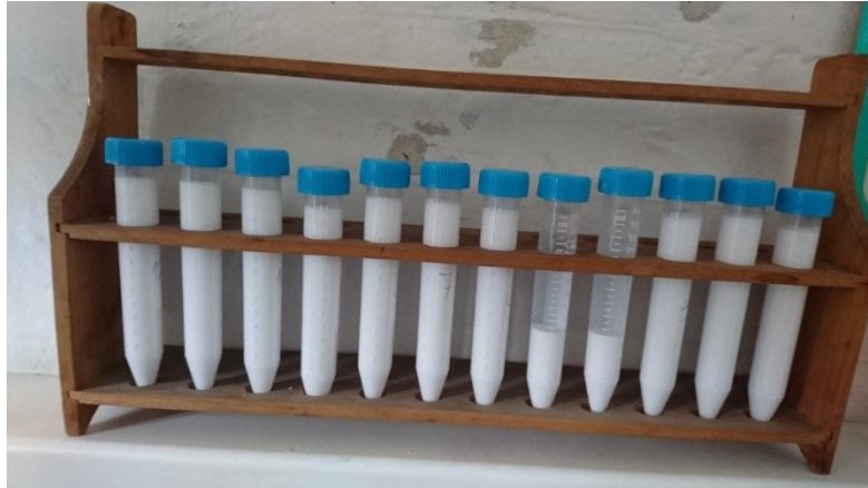
Slika 7.1 Prikaz provedbe sedimentacijskog testa pripremljenih keramičkih suspenzija.
