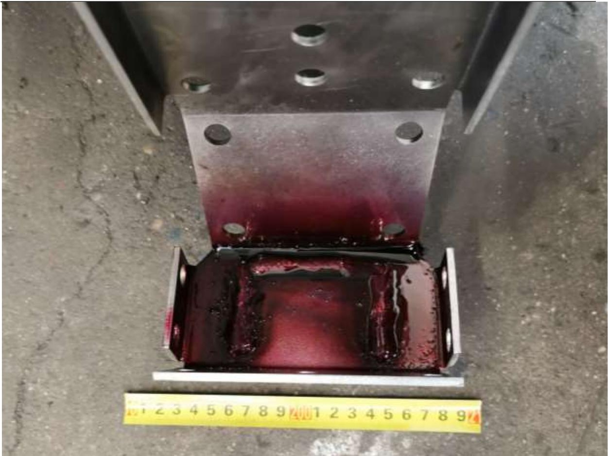
**Slika 29 Penetrantsko ispitivanje zavarenog spoja**
