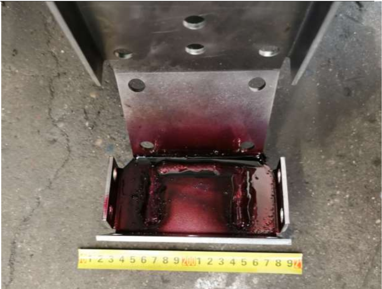
Slika 29 Penetrantsko ispitivanje zavarenog spoja
