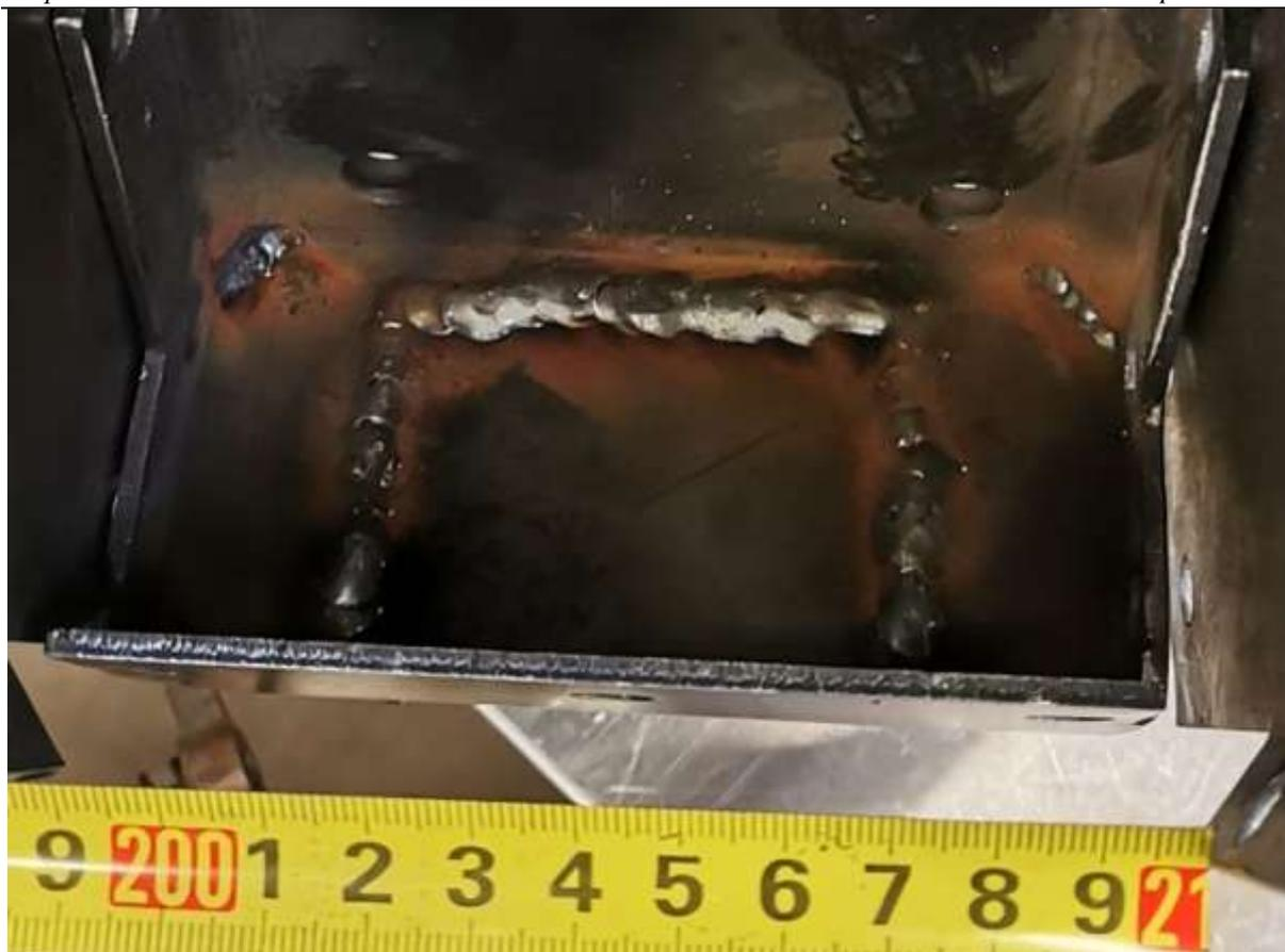
**Slika 27 Zavareni spoj izveden u proizvodnom pogonu TEP-a**
