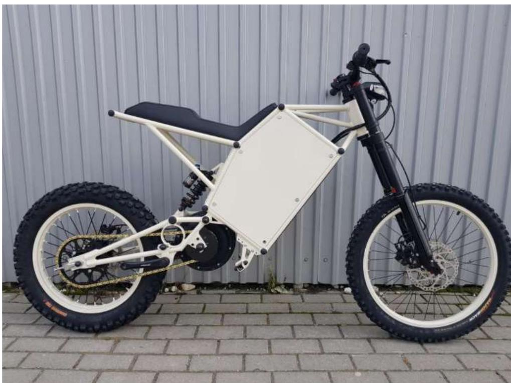
**Slika 4** Konstrukcija okvira električnog bicikla s baterijom integriranom u okvir, model 2 [10]
