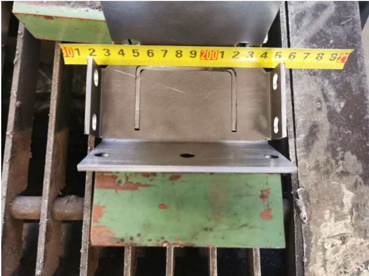
Slika 21 Sučeljeni spoj limova, PA položaj zavarivanja
