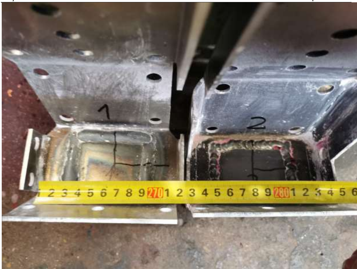
Slika 31 Uzorci 1 (FSB) i 2 (TEP) prije rezanja na strojnoj pili
