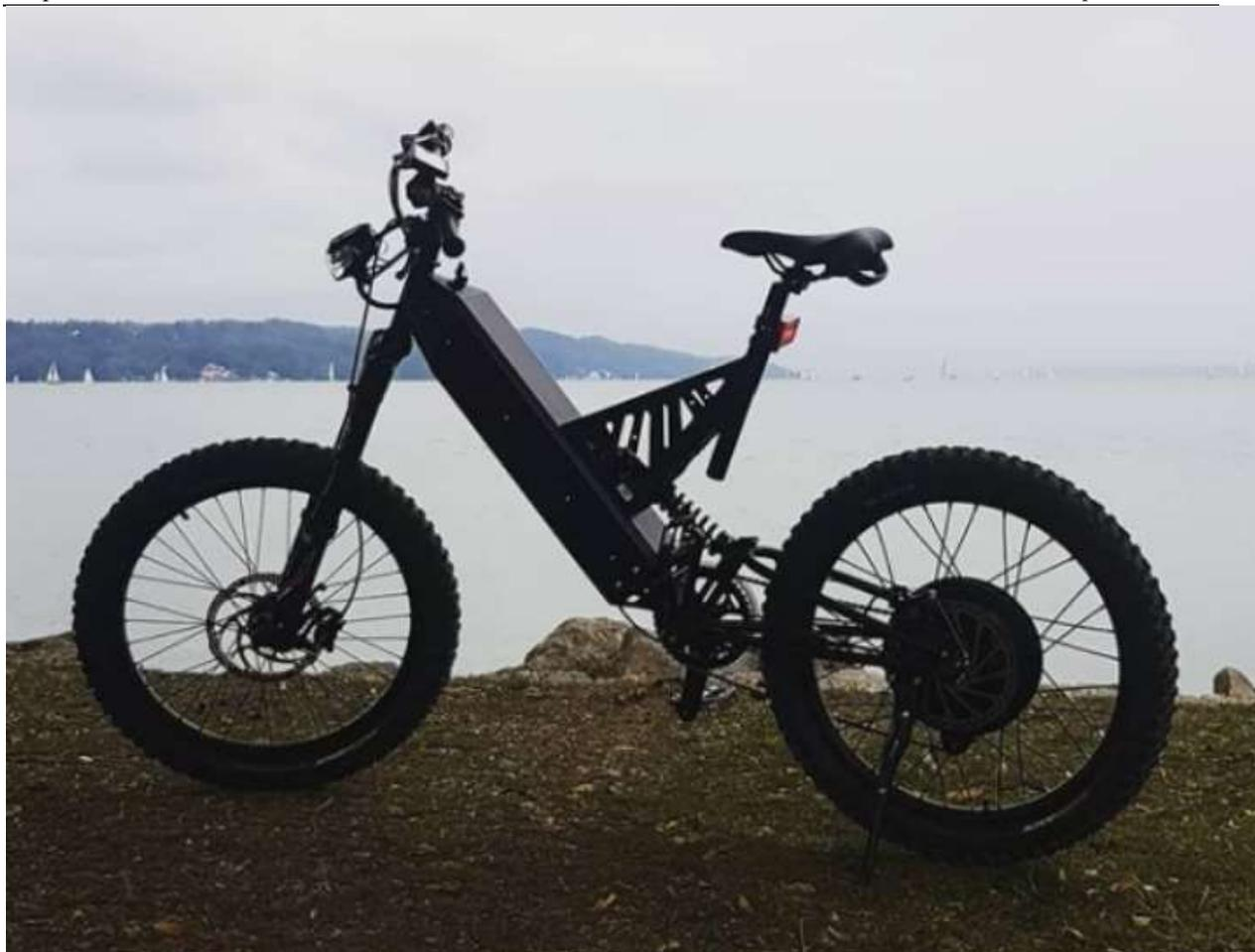
**Slika 5 Konstrukcija okvira električnog bicikla s baterijom integriranom u okvir, model 3 [10]**
