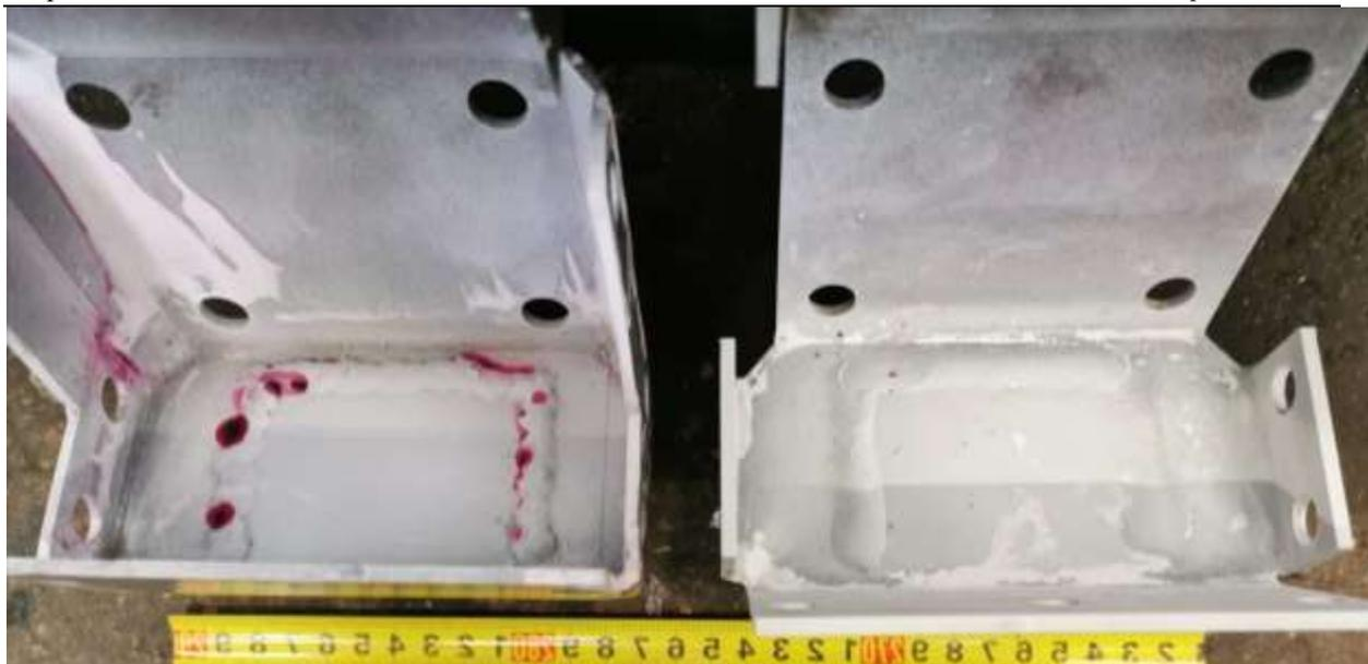
**Slika 30 Indikacije na površini zavarenih spojeva**
