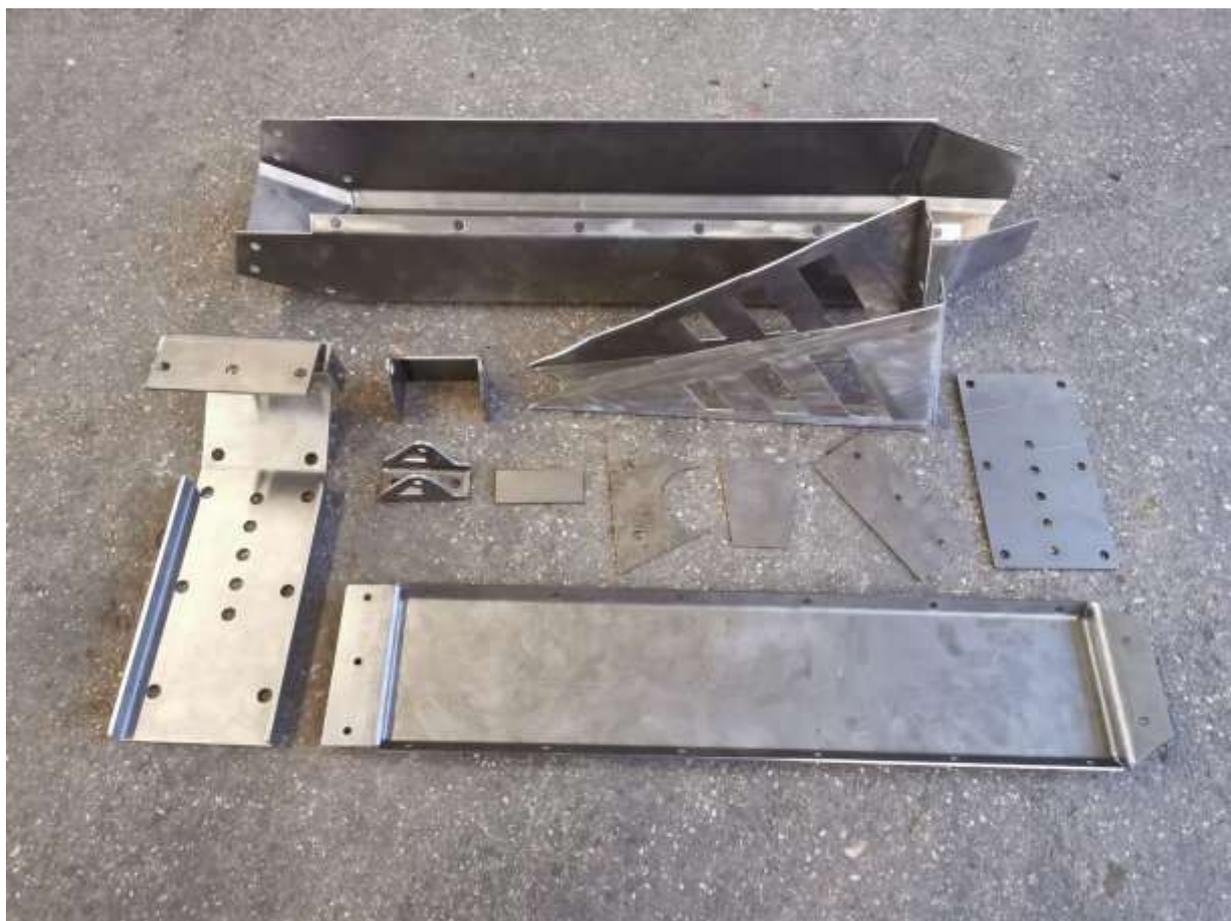
**Slika 15** Komponente za izradu okvira električnog bicikla Thor
