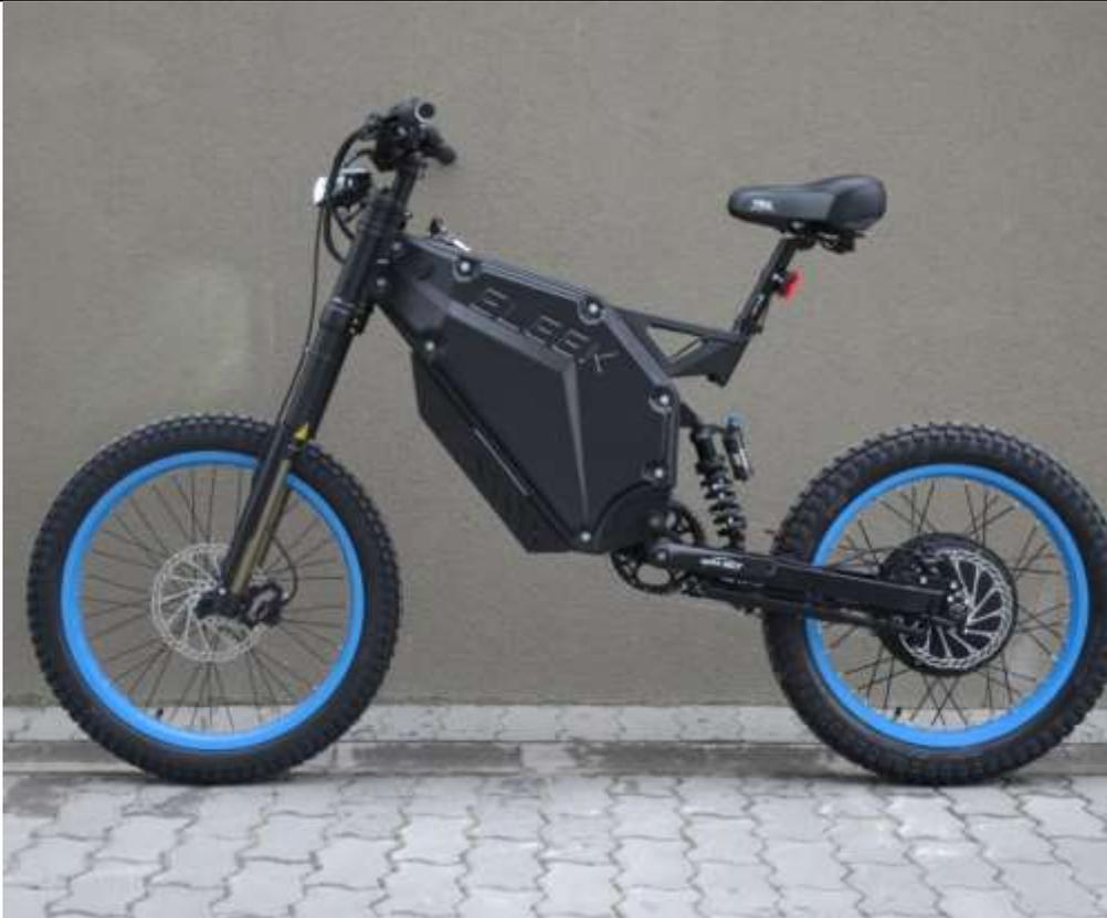
**Slika 3** Konstrukcija okvira električnog bicikla s baterijom integriranom u okvir, model 1 [9]
