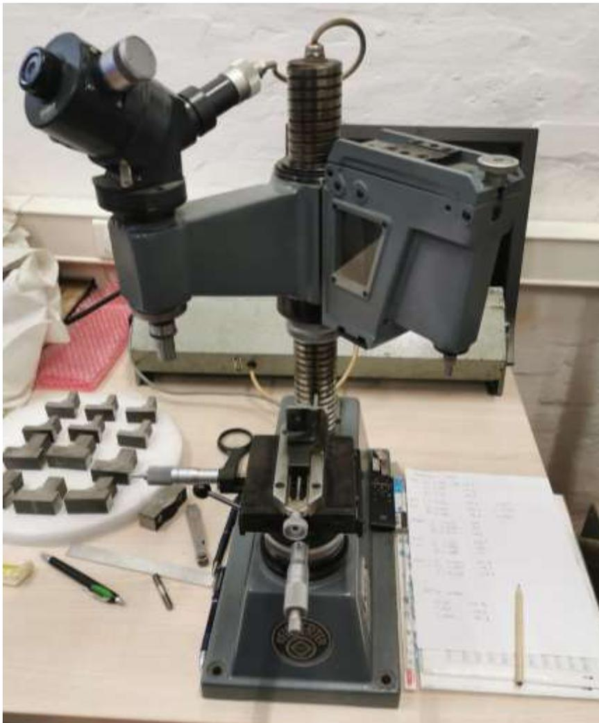
**Slika 43 Uređaj za ispitivanje tvrdoće prema Vickersu**
