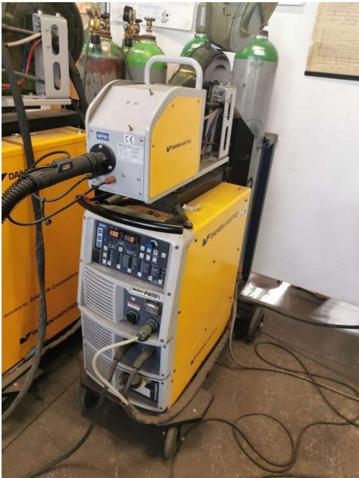
**Slika 22 Izvor struje za zavarivanje Welbee P400**
