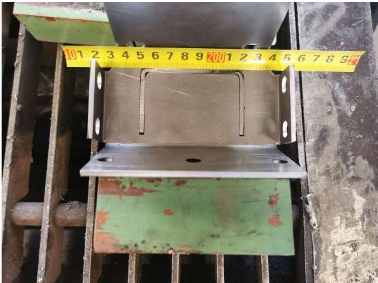
**Slika 21 Sučeljeni spoj limova, PA položaj zavarivanja**
