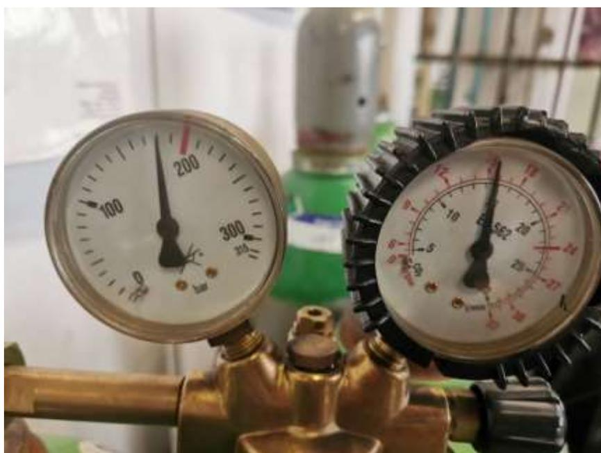
Slika 25 Regulator tlaka i mjerac protoka
