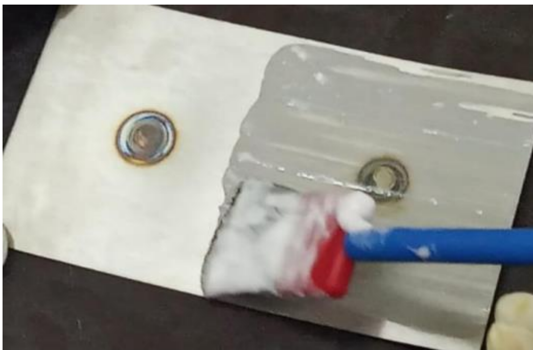
Slika 10. Prikaz kemijske obrade zavora nagrizanjem [5]
