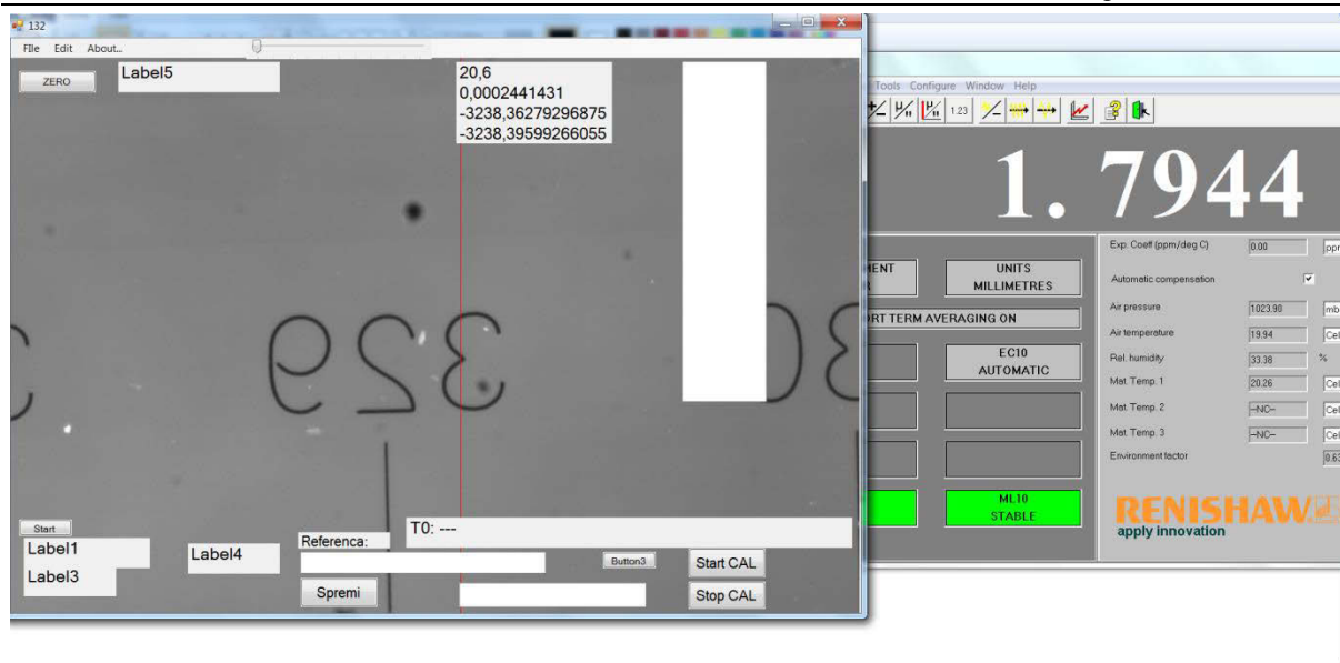
Slika 36. Mjerenje utjecaja rezolucije kamere
