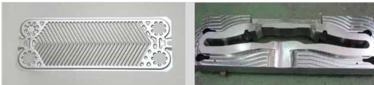
Slika 4. Alat za hladno oblikovanje; alat za probijanje [3]
