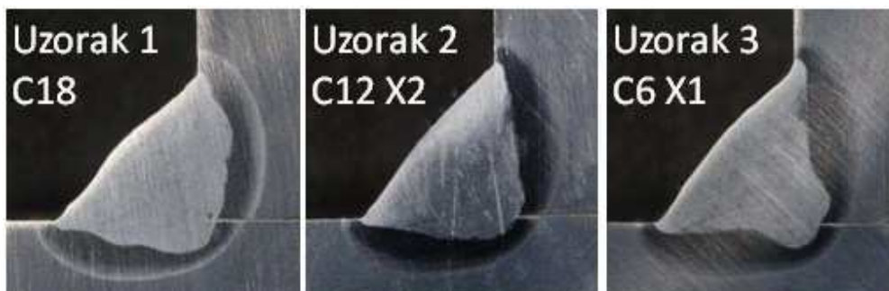
Slika 40. Utjecaj plina na oblik metala zavara
