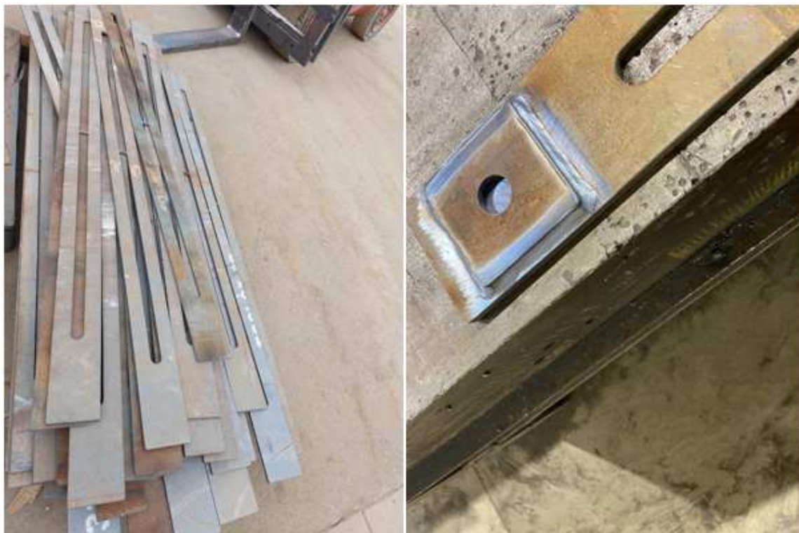
Slika 7. Vlačna motka od Toolox čelika u postupku izrade
