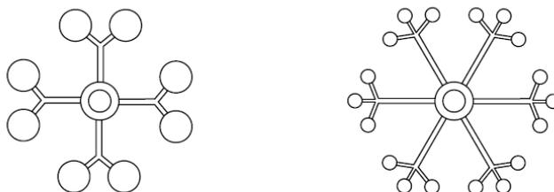
**Slika 9** Simetrični raspored kalupne šupljine (neuravnoteženi-desno; uravnoteženi-lijevo) [5]
