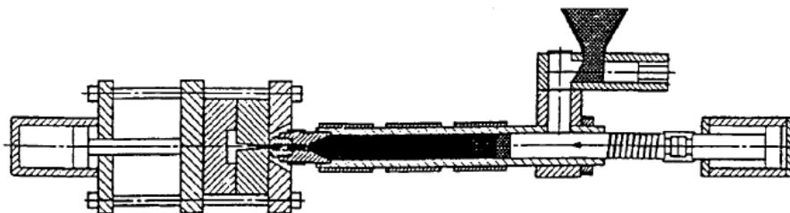
*Slika 2 Faza plastificiranja plastomera [1]*
