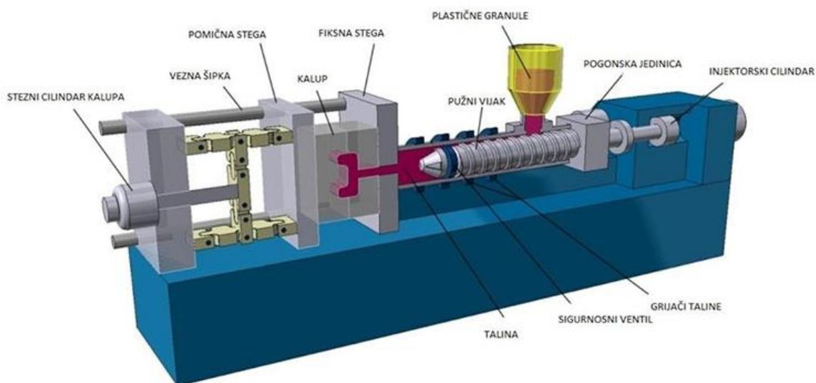
*Slika 1* Dijelovi sustava za injekcijsko prešanje [3]
