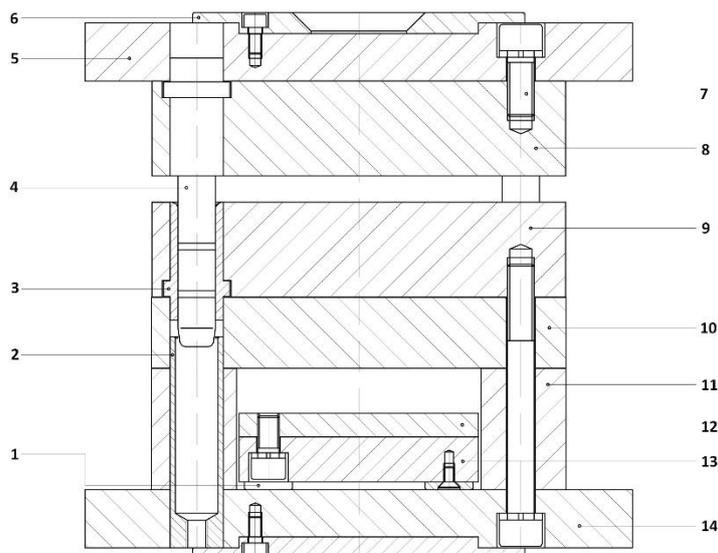
*Slika 5 Primjer kućišta kalupa [5]*
