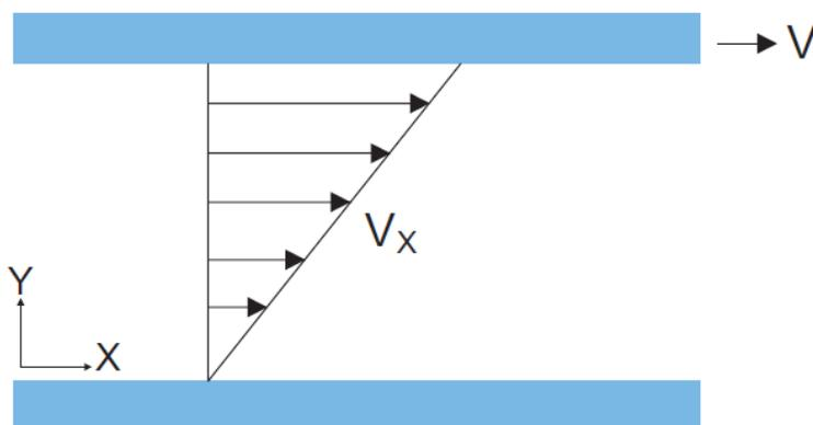
*Slika 16 Protok između dvije paralelne ploče [8]*
