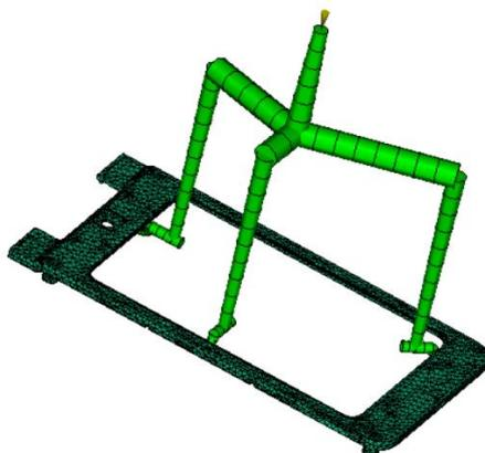
*Slika 27 Otpresak s uljevnim sustavom [13]*
