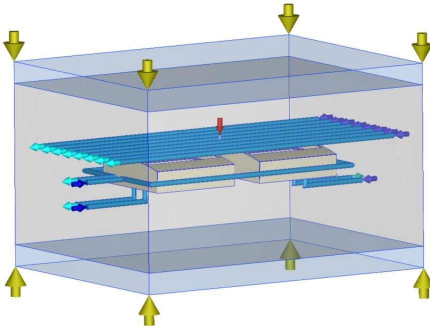
*Slika 34 Model kalupa s otpreskom, uljevnim kanalima i sustavom za hlađenje*
