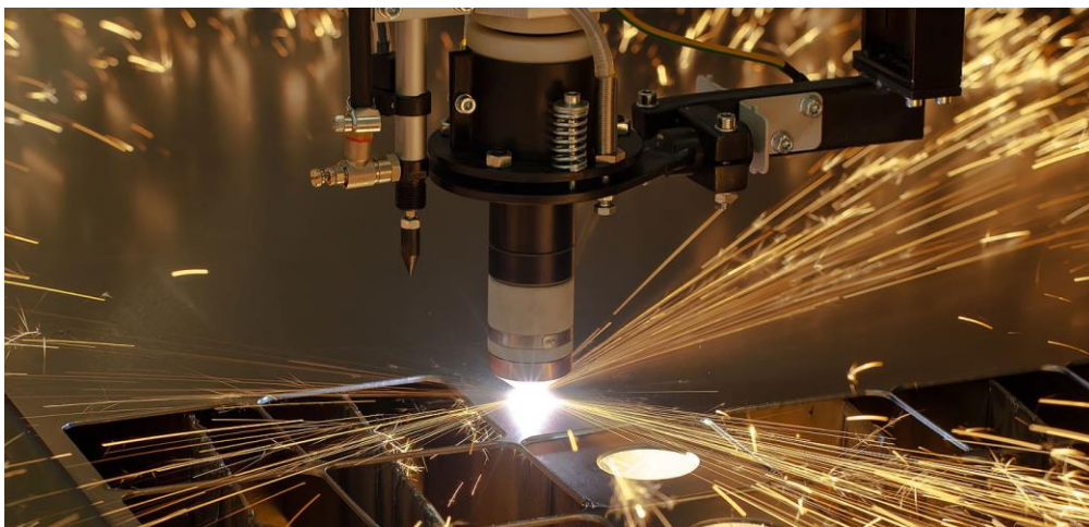
Slika 4. Rezanje metala laserom [10]
