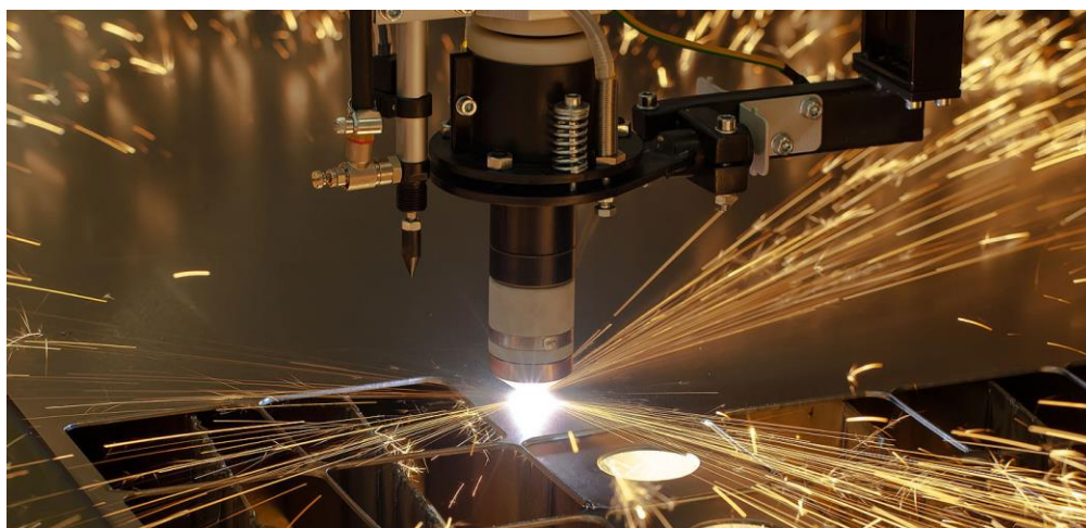
Slika 4. Rezanje metala laserom [10]
