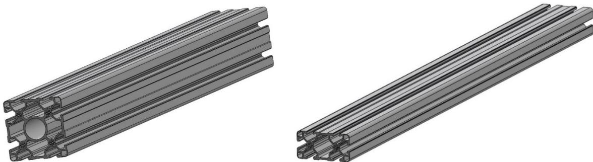
Slika 24. Aluminijski profil 90x90 (lijevo) i aluminijski profil 90x45 (desno)
