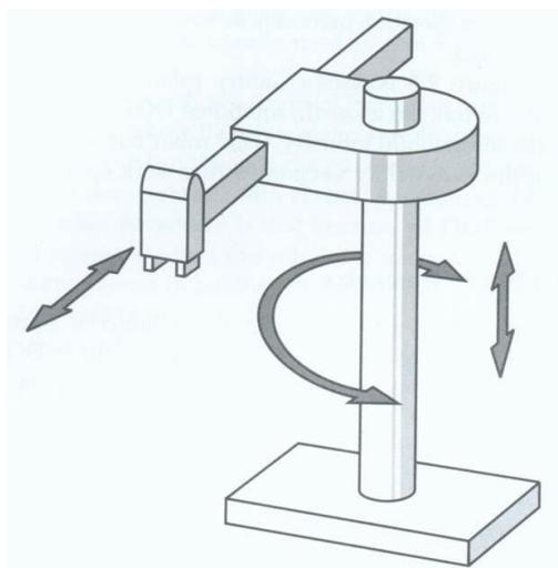
Slika 18. Cilindrični robot [15]
