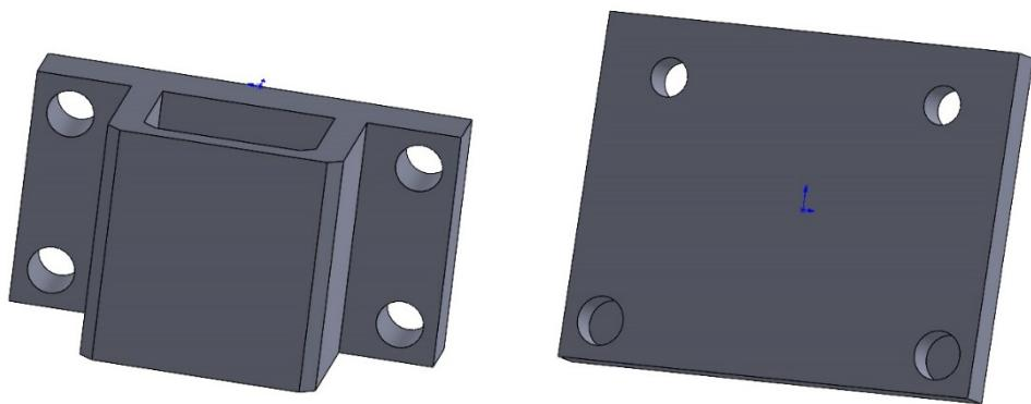
**Slika 28.** Nosač servomotora (lijevo) i pločica (desno)
