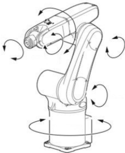
Slika 17. Zglobni robot sa 6 stupnjeva slobode gibanja [14]
