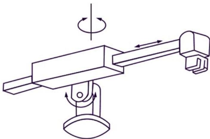
Slika 16. Polarni robot [13]
