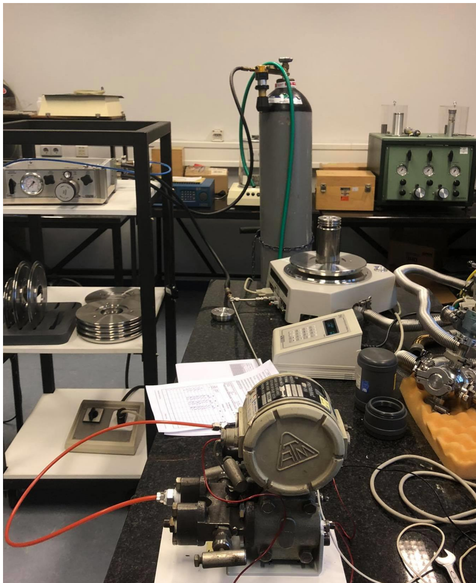
Slika 18. Umjeravanje tlačnom vagom TLVAG 09
