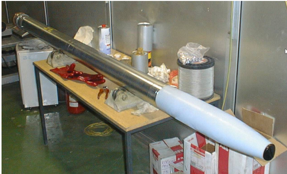
Slika 2.11. Raketa 122 mm M-21-OF GRAD, vidljiv spoj bojeve glave i komore motora
