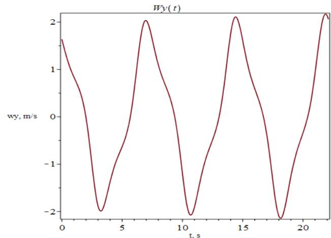
Slika 40. Komponenta brzine Y uslijed nailaznog vala
