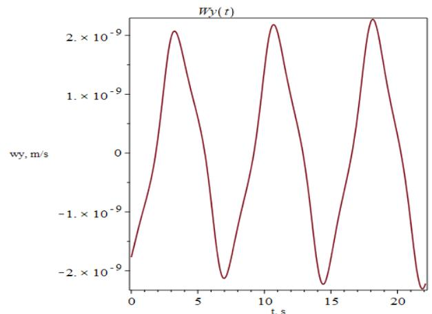
Slika 82. Komponenta Y brzine uslijed nailaznog vala
