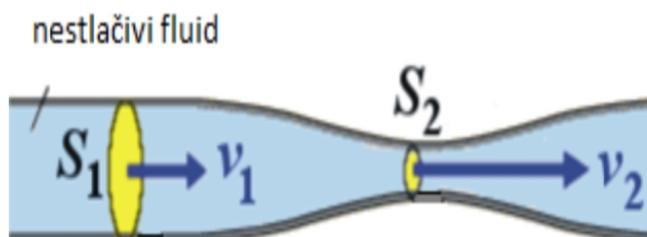
Slika 11. Venturijeva cijev
