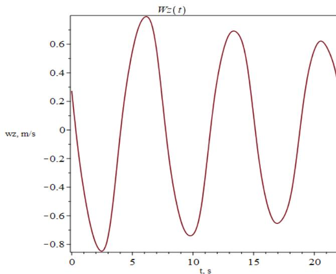
Slika 98. Komponenta Z brzine uslijed nailaznog vala
