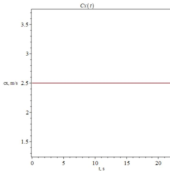
Slika 38. Komponenta brzine X uslijed morske struje
