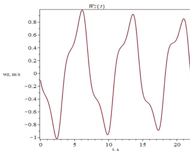
Slika 42. Komponenta brzine Z uslijed nailaznog vala
