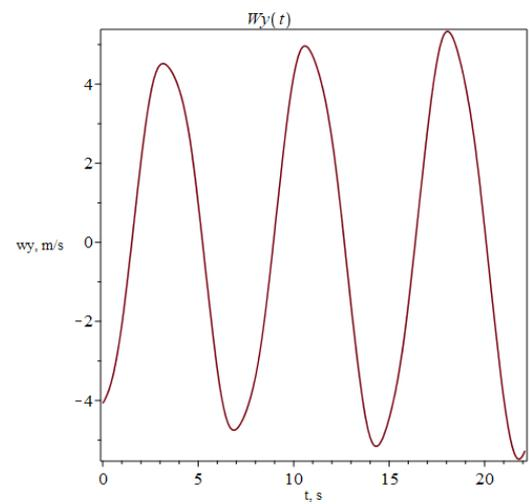
Slika 97. Komponenta Y brzine uslijed nailaznog vala
