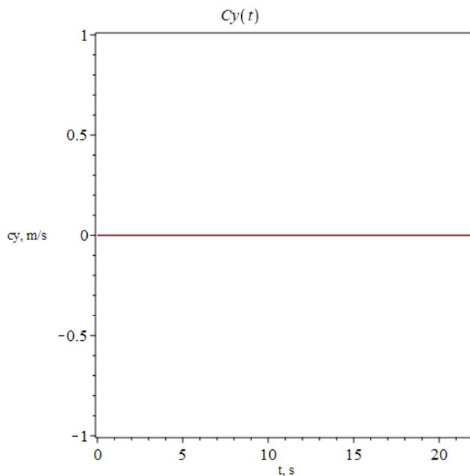
Slika 95. Komponente Y brzine uslijed morske struje
