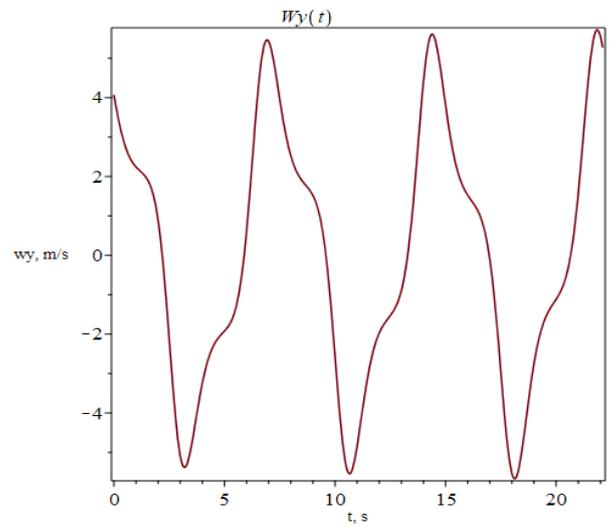
Slika 54. Komponenta brzine Y uslijed nailaznog vala
