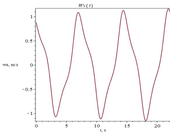
Slika 41. Komponenta brzine X uslijed nailaznog vala
