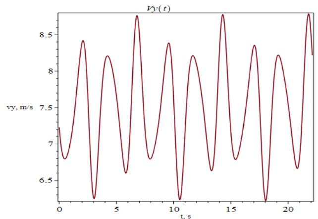
Slika 61. Komponentna Y rezultante brzine K.S. lopatice
