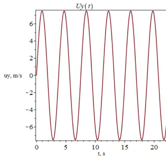
Slika 22. Komponenta brzine Y usljed rotacije
