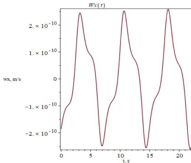
Slika 55. Komponenta brzine X uslijed nailaznog vala
