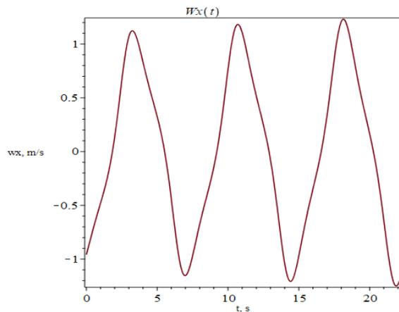
Slika 83. Komponenta X brzine uslijed nailaznog vala
