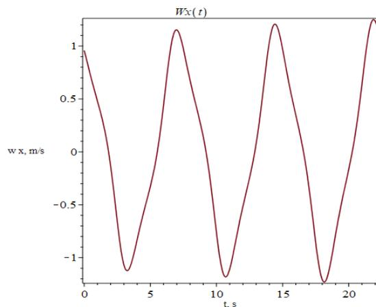
Slika 26. Komponenta brzine X uslijed nailaznog vala
