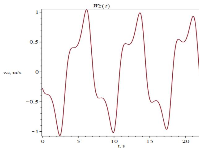
Slika 56. Komponenta brzine Z uslijed nailaznog vala
