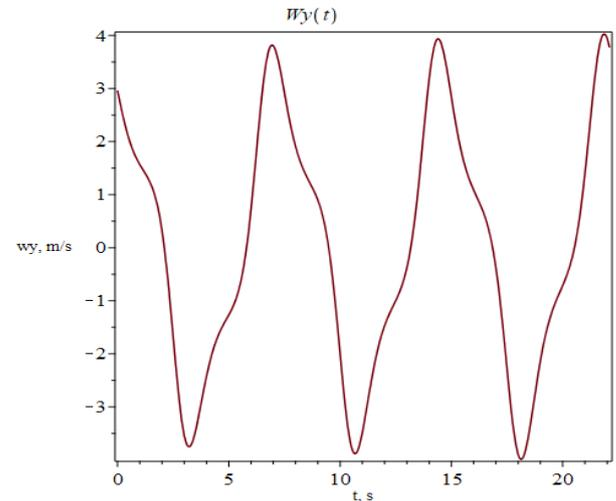
Slika 68. Komponentna Y brzine uslijed nailaznog vala
