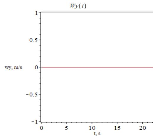
Slika 27. Komponenta brzine Y uslijed nailaznog vala
