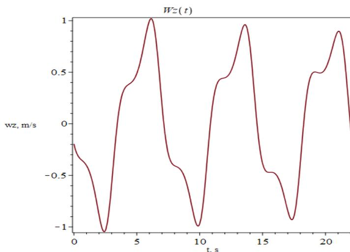
Slika 70. Komponenta Z brzine uslijed nailaznog vala
