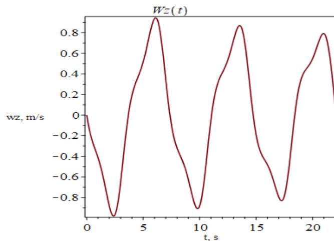
Slika 28: Komponenta brzine Z uslijed nailaznog vala
