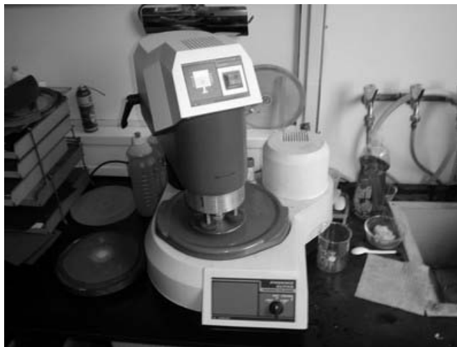
Slika 11. Uređaj za brušenje i poliranje Buehler
