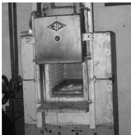
Slika 5. Električna peć u kojoj je proveden sferoidizacija
