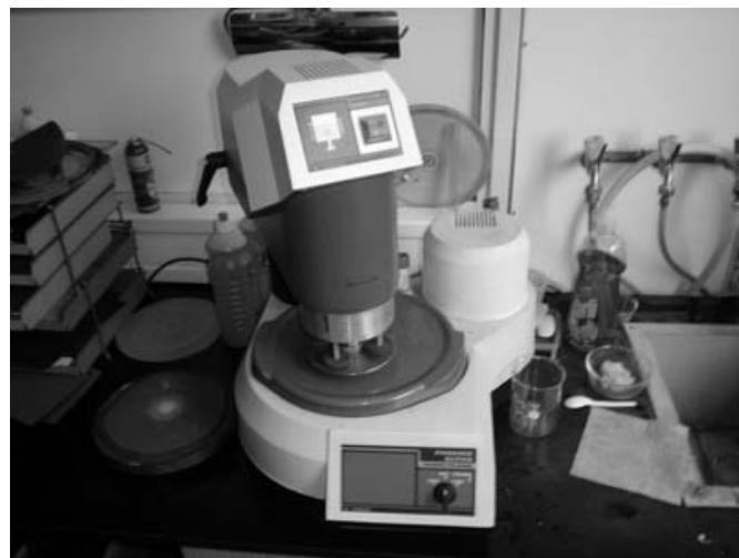
Slika 11. Uređaj za brušenje i poliranje *Buehler*
