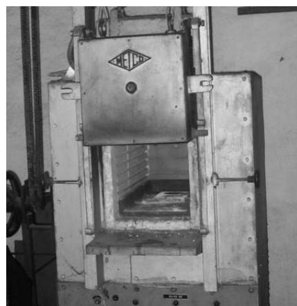
Slika 5. Električna peć u kojoj je proveden sferoidizacija
