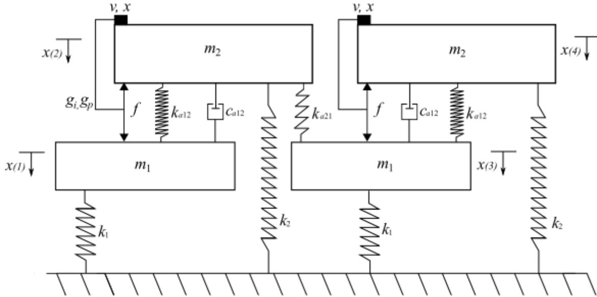
**Slika 2 Model s diskretnim parametrima jedne čelije aktivnog akustičkog metamaterijala**
