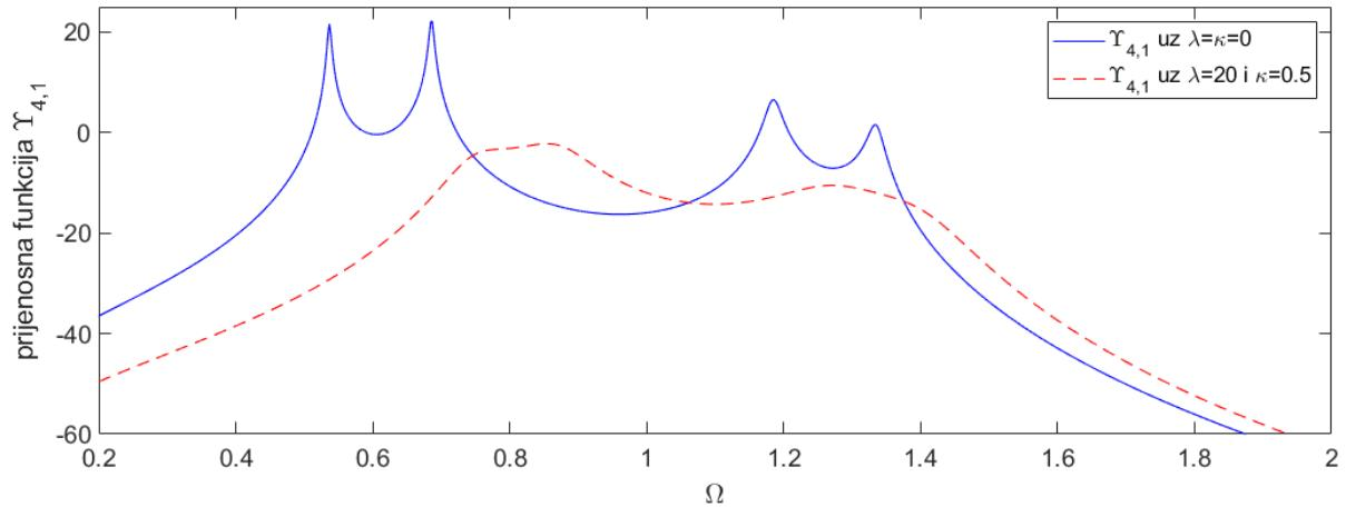
**Slika 9 Utjecaj vrijednosti bezdimenzijskog pojačanja integralnog člana regulatora ( $\kappa$ ) na prijenosnu funkciju  $Y_{4,1}$**
