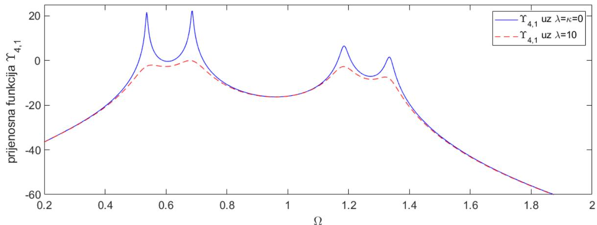
**Slika 7 Utjecaj vrijednosti bezdimenzijskog pojačanja proporcionalnog člana regulatora ( $\lambda$ ) na prijenosnu funkciju  $\Upsilon_{4,1}$**
