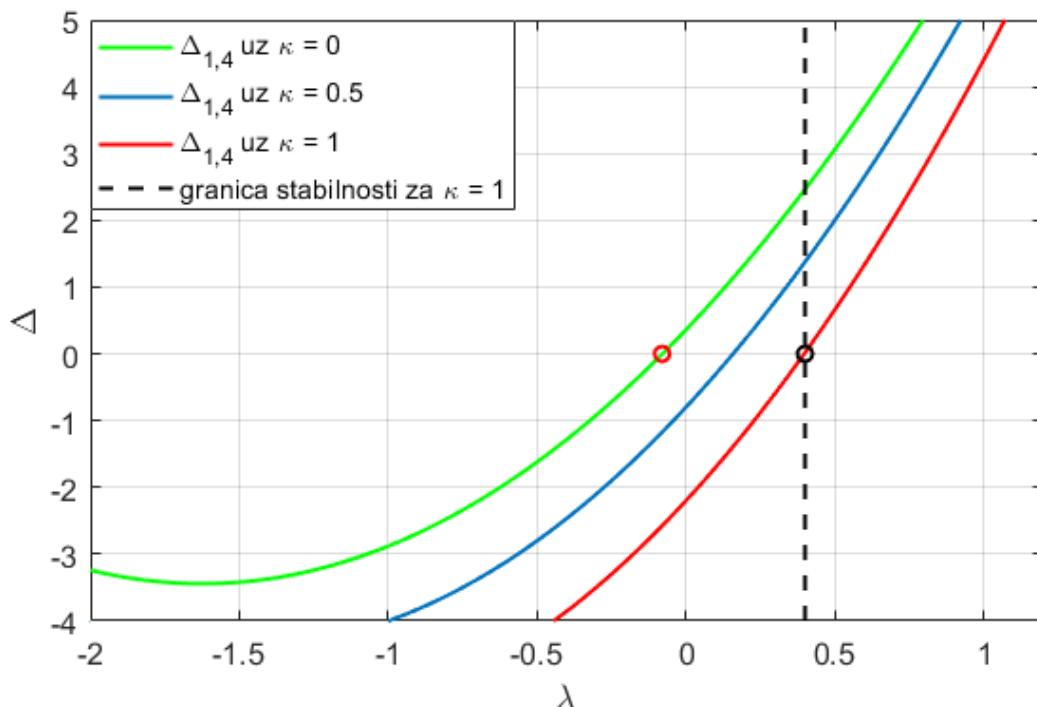
Slika 5 Determinanta  $\Delta_{1,4}$  u ovisnosti o bezdimenzijskom pojačanju proporcionalnog člana regulatora ( $\lambda$ ) za različite iznose bezdimenzijskog pojačanja integralnog člana regulatora ( $\kappa$ )
