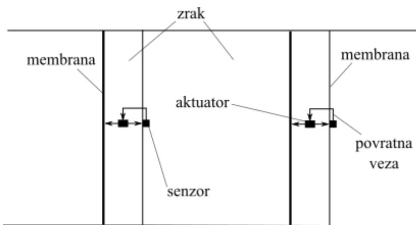
Slika 1 Shema jedne čelije aktivnog akustičnog metamaterijala sa senzorima i aktuatorima
