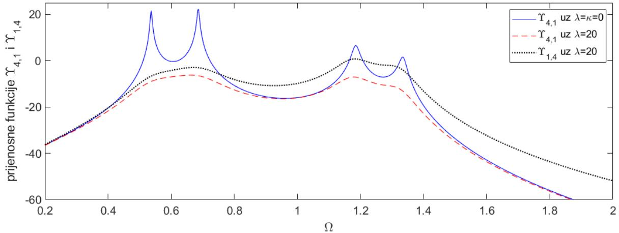
**Slika 8 Utjecaj vrijednosti bezdimenzijskog pojačanja proporcionalnog člana regulatora ( $\lambda$ ) na recipročnost sustava**
