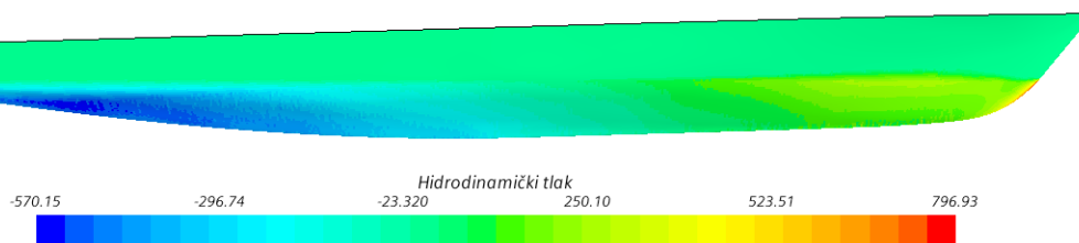
Slika 39. Raspodjela hidrodinamičkog tlaka po trupu katamarana s razmakom H/L = 0,3 pri Fr = 0,5
