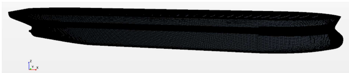
Slika 17. Model broda diskretiziran finom mrežom
