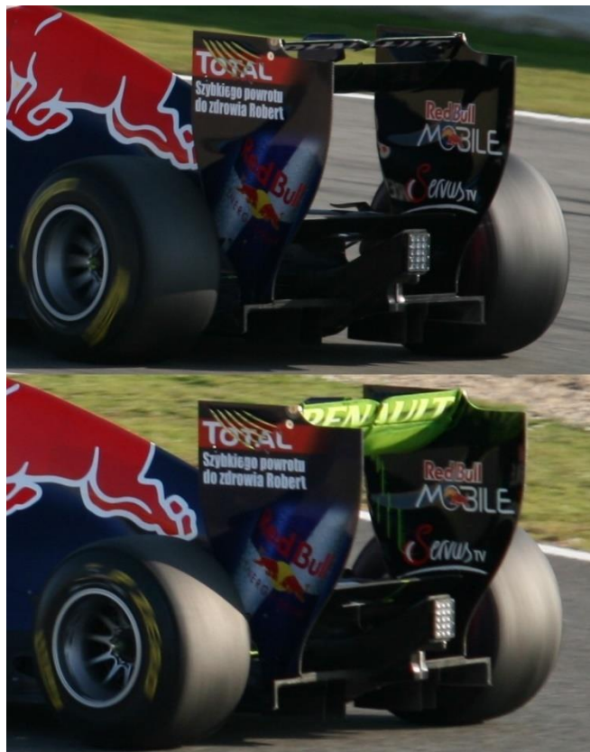
Slika 3. DRS u zatvorenom i otvorenom položaju [5]
