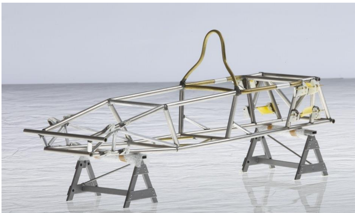
Slika 6. Ferrari 156 - Sharknose spaceframe [9]
