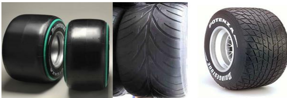
Slika 22. Lijevo – slik guma za suho vrijeme, Sredina – guma za djelomično mokre uvijete, Desno – guma za potpuno mokre uvijete [18]
