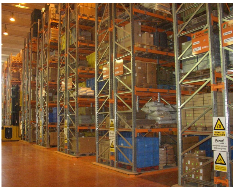
Slika 3.4 Primjer paletno polične regalne konstrukcije "Elektrokontakt Zagreb"
