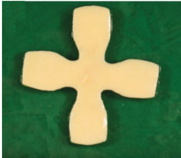
Slika 1. Primjer križne epruvete od mekog tkiva, slika preuzeta iz [2]
