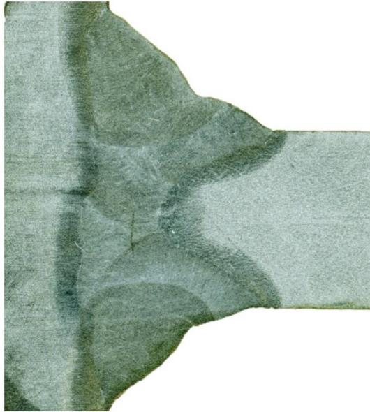
**Slika 21: Uvećan prikaz zavara modela [16]**
