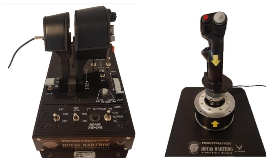
Slika 7. Ručica gasa i upravljačka palica [3]
