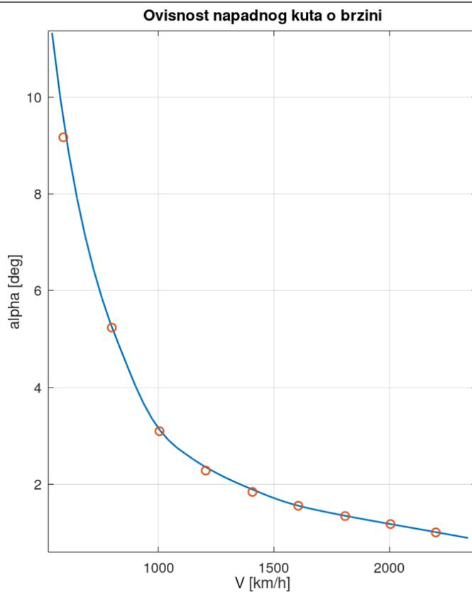
**Slika 13. Esperimentalne vrijedosti napadnog kuta s promjenom brzine**
