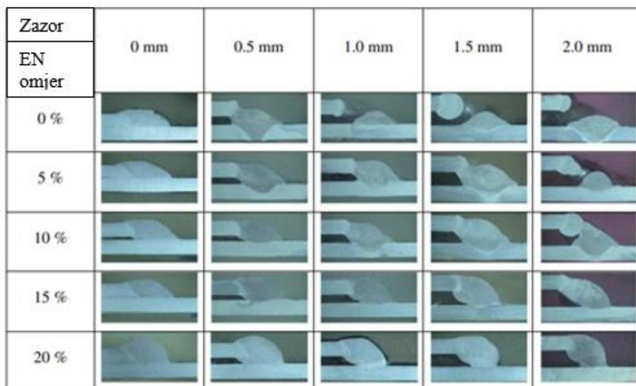
**Slika 20. Prikaz tolerancija zazora s povećanjem EN omjera [13]**
