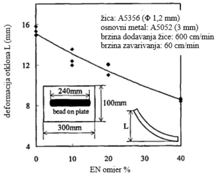
Slika 21. Smanjenje deformacija AC impulsnim zavarivanjem [2]
