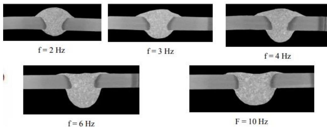
**Slika 17. Ispitivanje utjecaja različitih frekvencija na makroizbruscima zavarenim AC valnim impulsom [17]**
