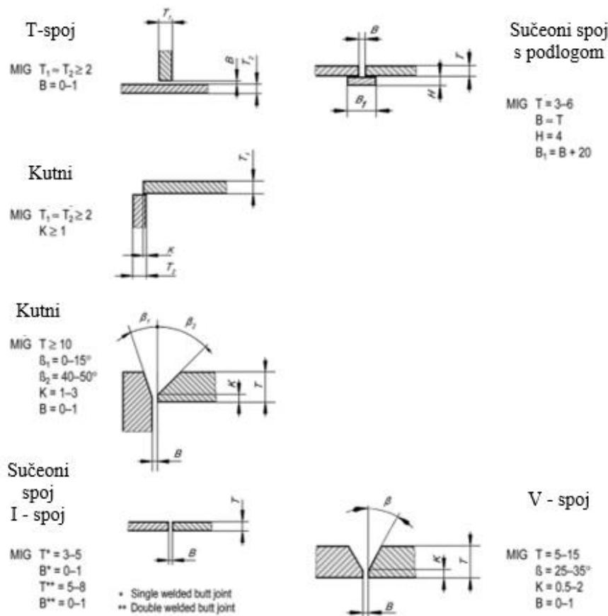
Slika 18. Primjeri spojeva za MIG zavarivanje aluminija [3]
