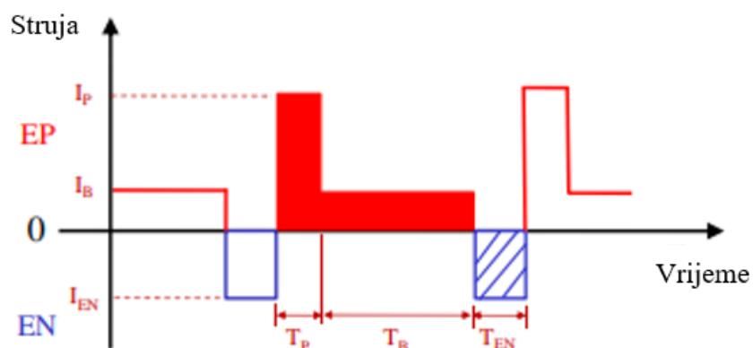
Slika 8. Valni oblik struje za AC MIG [12]
