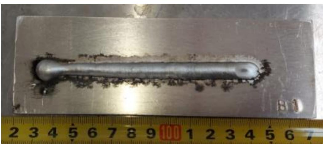
Slika 29. Uzorak B1 - izmjenična struja,  $I = 120 \text{ A}$ ,  $U = 21,8 \text{ V}$ ,  $f = 127,2 \text{ Hz}$ ,  $EN = 0 \%$
