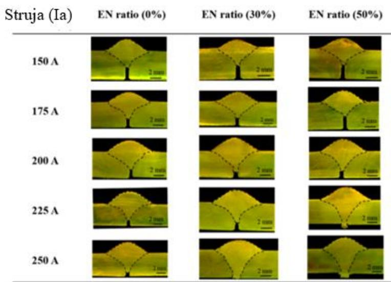
**Slika 13. Makroizbrusci zavara pri različitim strujama i omjeru negativnog polariteta [12]**
