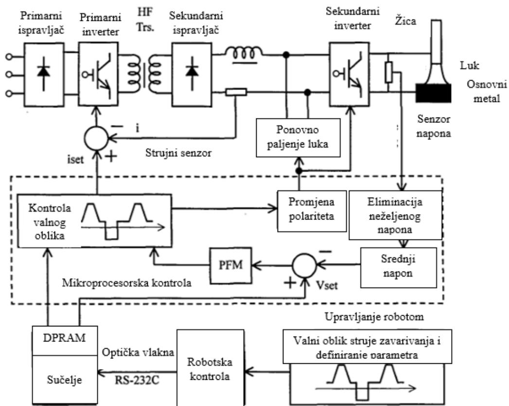
Slika 7. Shematski dijagram sustava za AC MIG impulsno zavarivanje [2]
