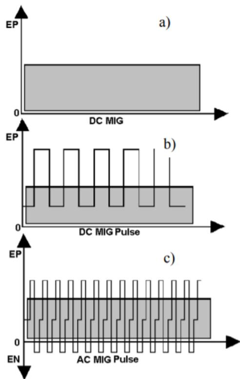
**Slika 4. Promjena polariteta struje u različitim varijantama MIG zavarivanja [8] :**
