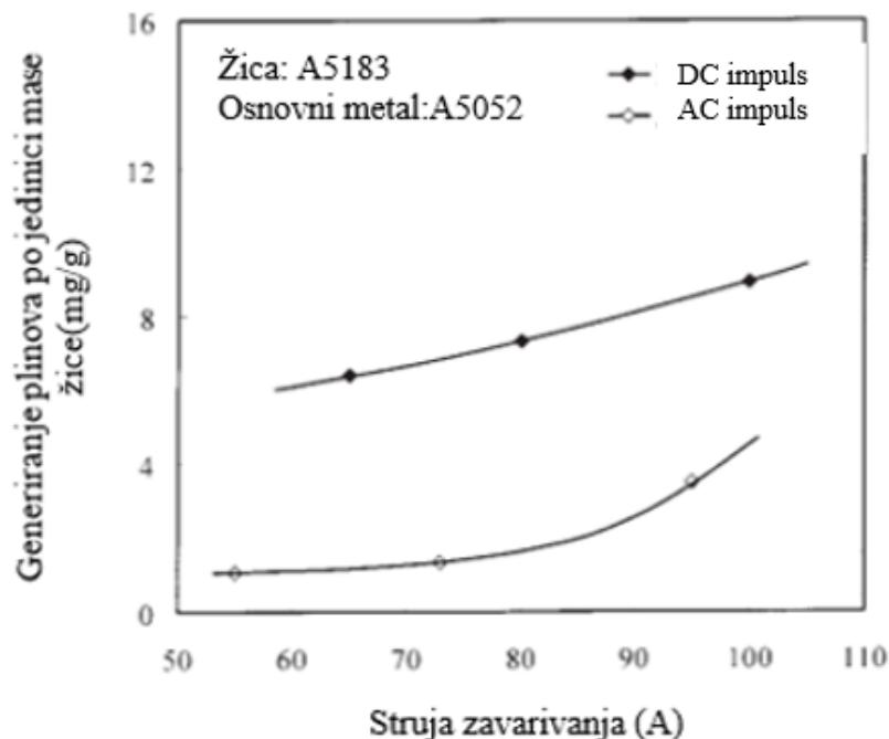
**Slika 24. Utjecaj struje zavarivanja na generiranje plinova [15]**
