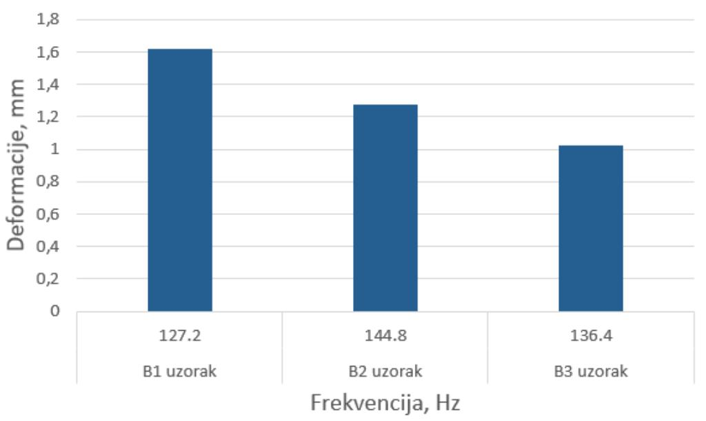
**Slika 37. Grafički prikaz ovisnosti kutne deformacije o frekvenciji**
