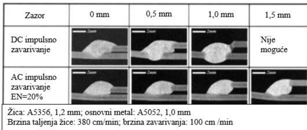
**Slika 19. Usporedba tolerancija zazora u AC i DC impulsnom zavarivanju [4]**
