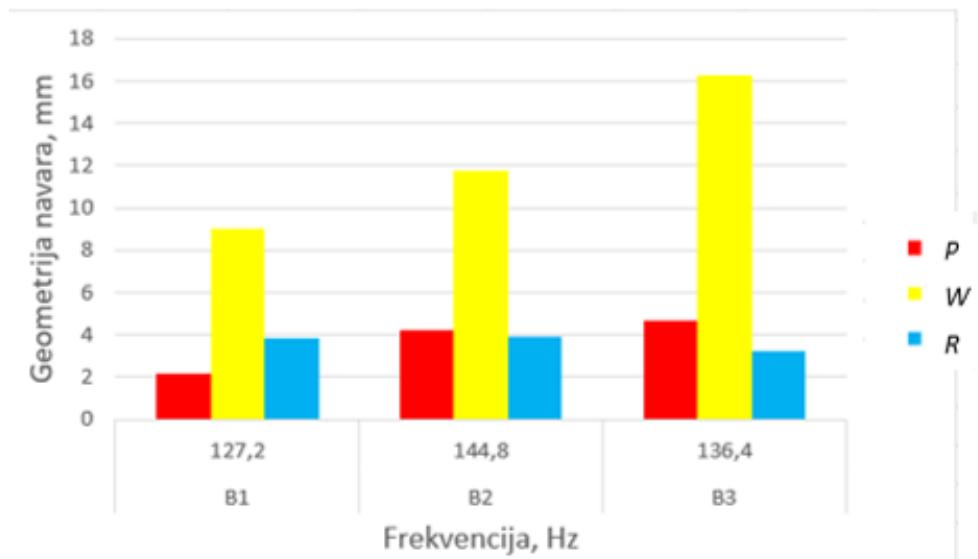
**Slika 46. Grafički prikaz ovisnosti geometrije navara o frekvenciji**
