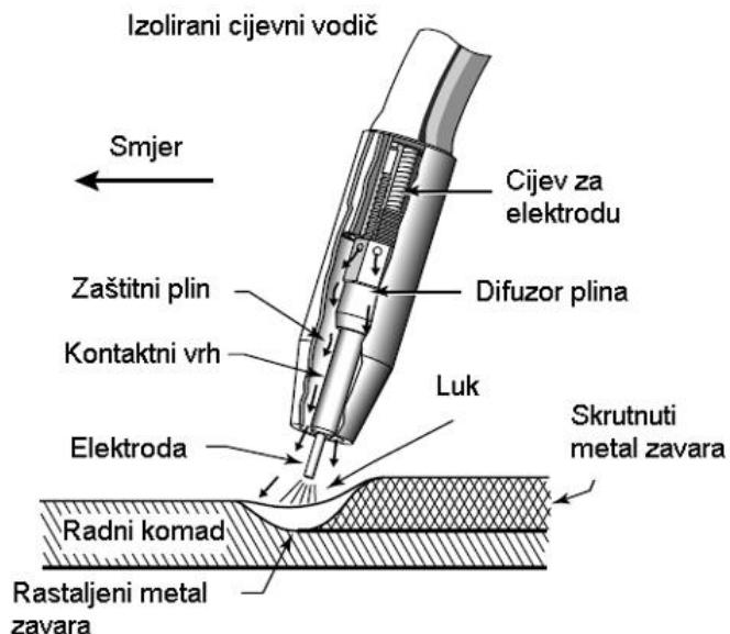
**Slika 3. Prikaz dijelova sapnice i zavara [6]**
