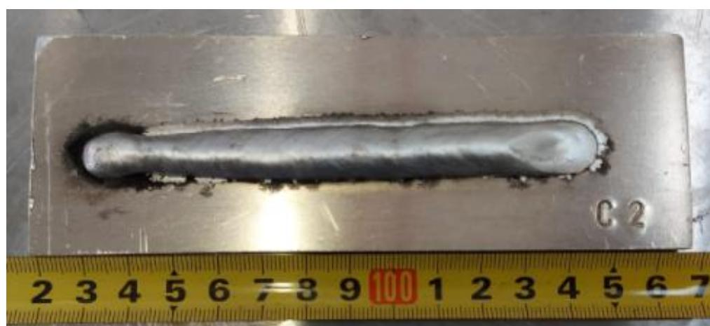
Slika 33. Uzorak C2 - izmjenična struja,  $I = 150 \text{ A}$ ,  $U = 22,8 \text{ V}$ ,  $EN = 50 \text{ \%}$
