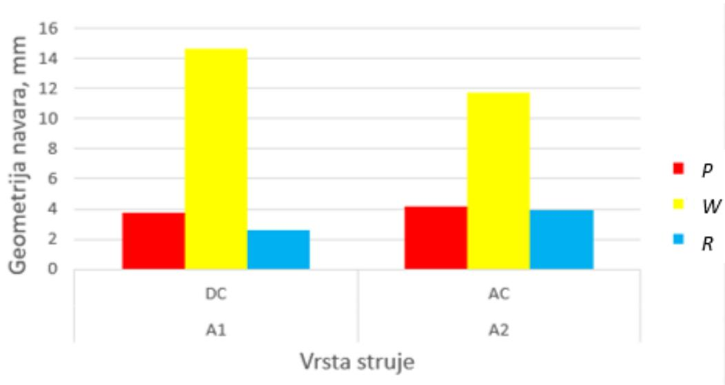
Slika 44. Grafički prikaz ovisnosti geometrije navara o vrsti struje
