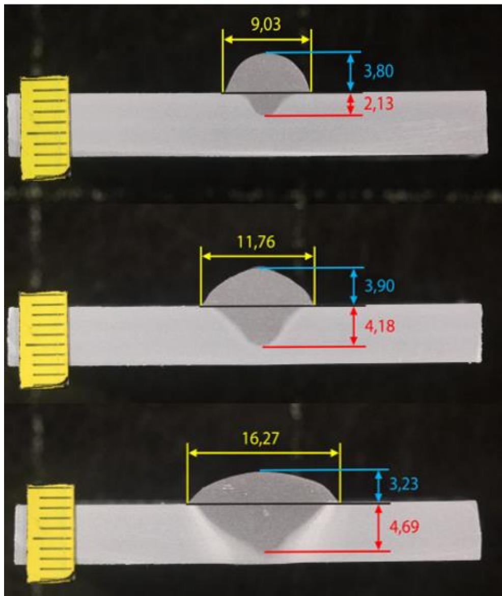
Slika 45. Ovisnost geometrije navara o frekvenciji - uzorci B1, B2 i B3
