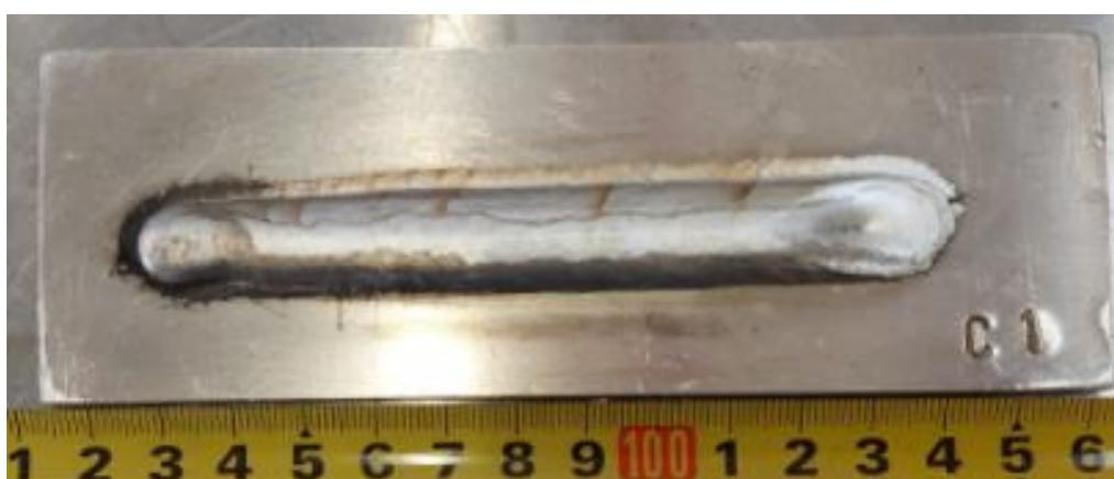
Slika 32. Uzorak C1 - izmjenična struja,  $I = 150 \text{ A}$ ,  $U = 23,8 \text{ V}$ ,  $EN = -50 \text{ \%}$
