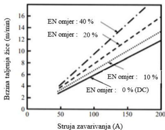
**Slika 9. Ovisnost EN omjera i brzine taljenja žice [4]**
