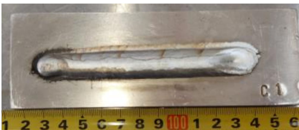
Slika 31. Uzorak B3 - izmjenična struja, I = 180 \text{ A} , U = 24,8 \text{ V} , f = 136,4 \text{ Hz} , EN = 0 \%
