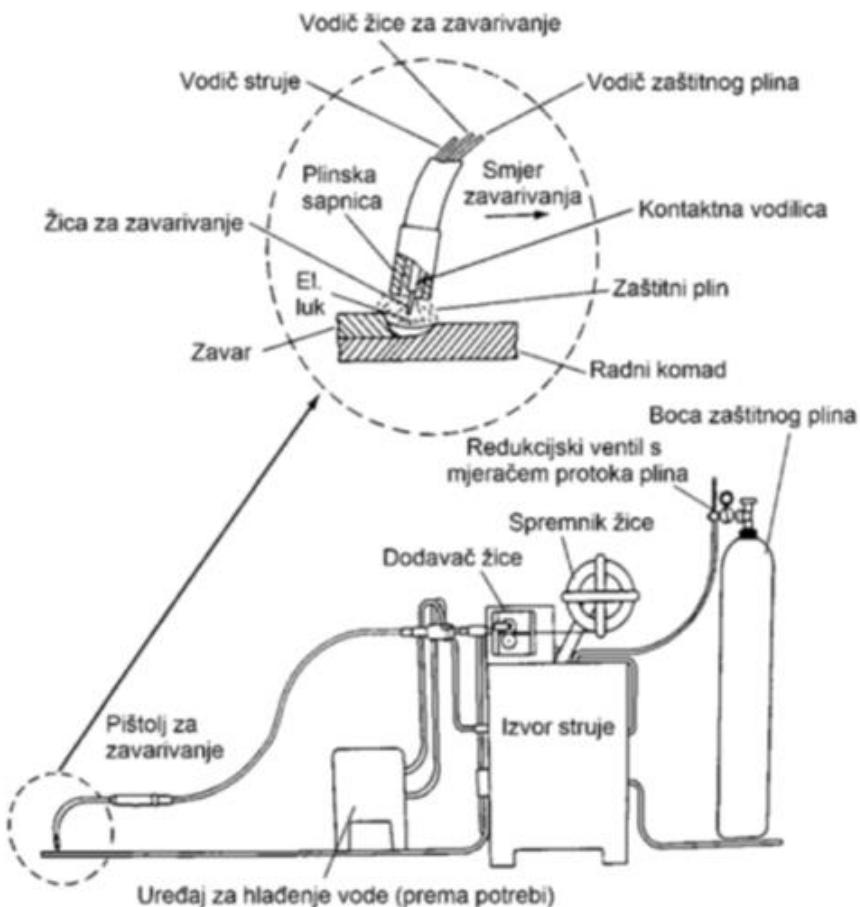
Slika 2. Oprema za MIG zavarivanje [6]
