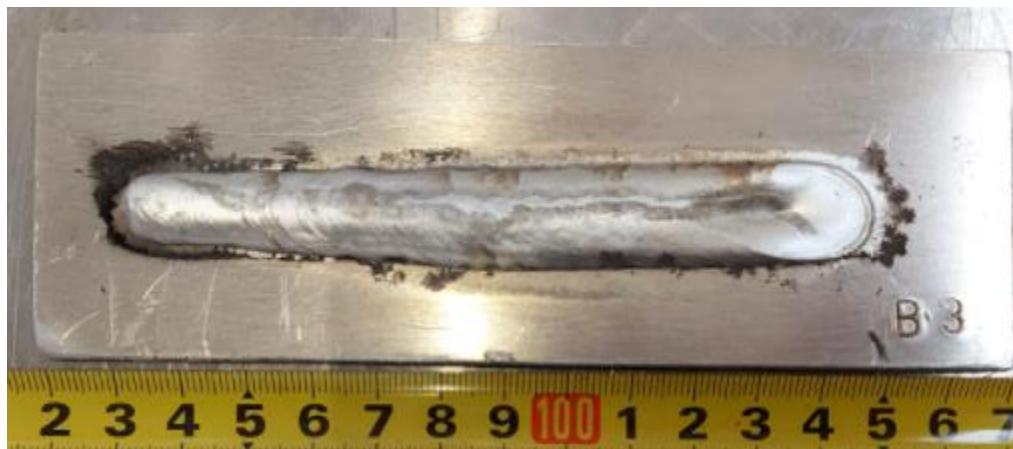
Slika 31. Uzorak B3 - izmjenična struja,  $I = 180 \text{ A}$ ,  $U = 24,8 \text{ V}$ ,  $f = 136,4 \text{ Hz}$ ,  $EN = 0 \text{ \%}$
