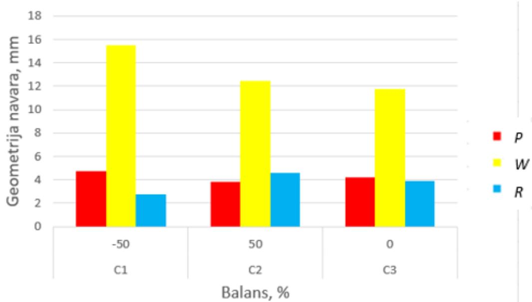
Slika 48. Grafički prikaz geometrije navara ovisnosti o balansu
