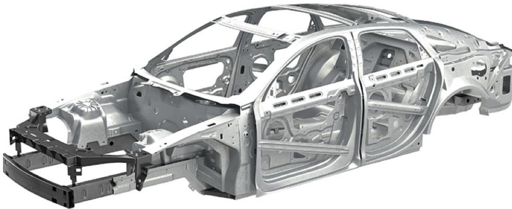
Slika 5. Čelični kostur automobila [13]
