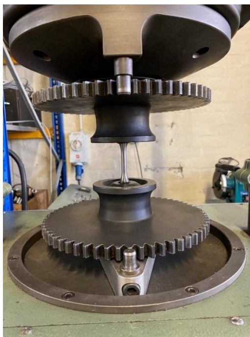
Slika 33. Prihvatni sustav za epruvetu na umaralici
