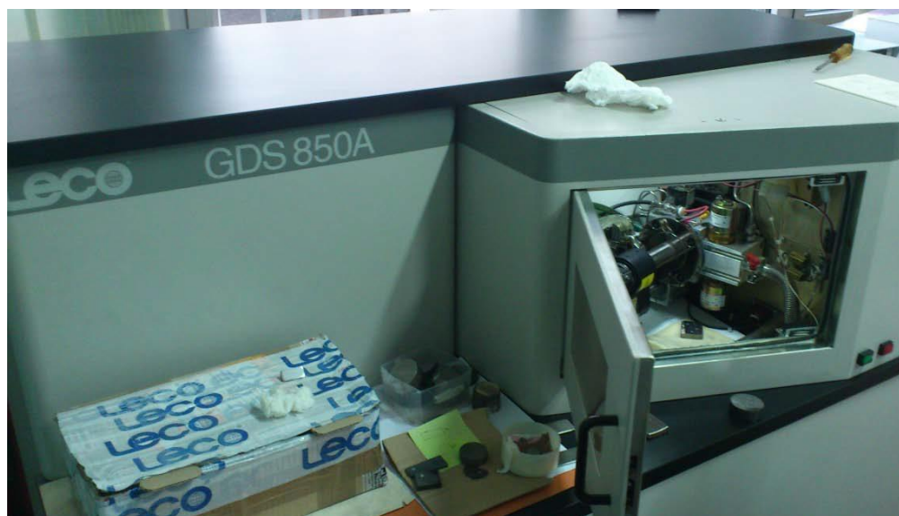
Slika 26. Uređaj LECO GDS 850A za optičku emisijsku spektrometriju (GDOS)
