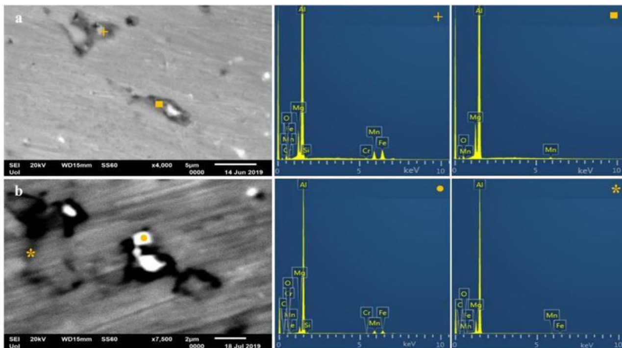
Slika 27. Mikrografi poprečnih presjeka nanese legure nakon korozijskog ispitivanja [29]
