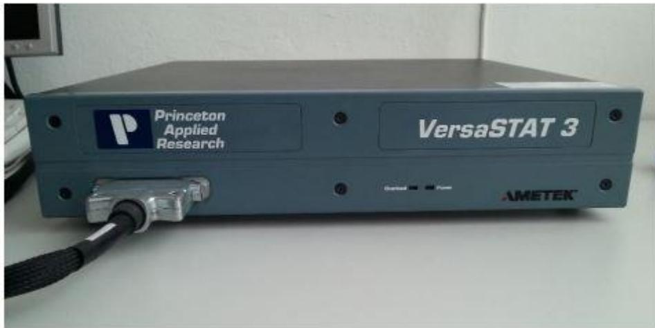
Slika 32. Potencijostat/galvanostat VersaSTAT 3
