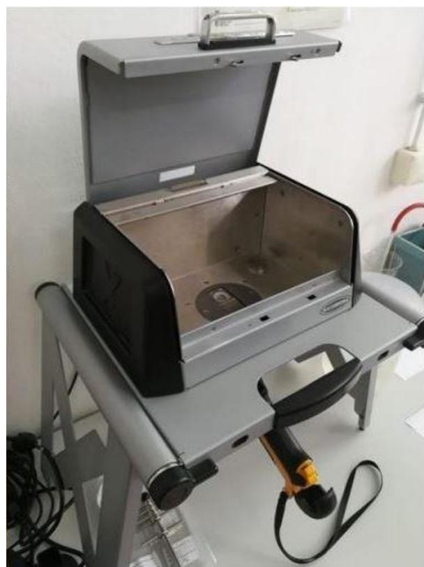
**Slika 31. Prikaz XRF analizatora za ispitivanje kemijskog sastava**
