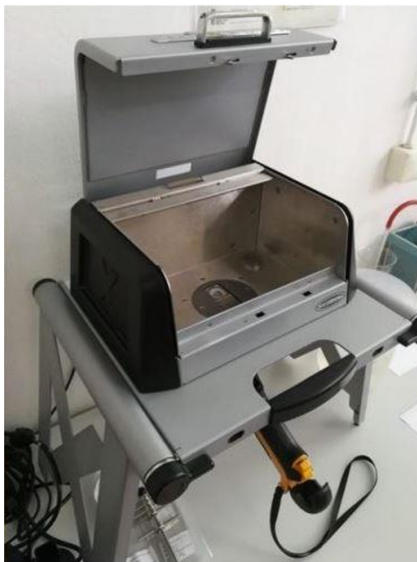
Slika 31. Prikaz XRF analizatora za ispitivanje kemijskog sastava
