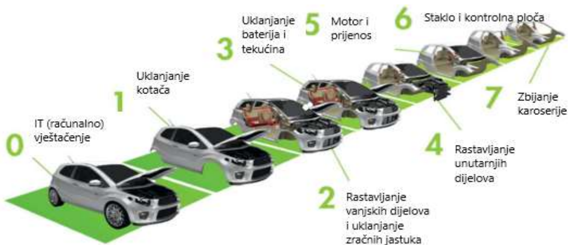
Slika 19. Prijedlog novog postupka demontaže [19]
