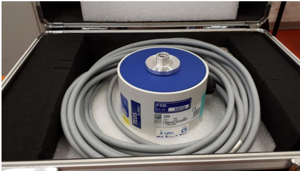
Slika 19. Dinamometar HBM Z30A 200 N
