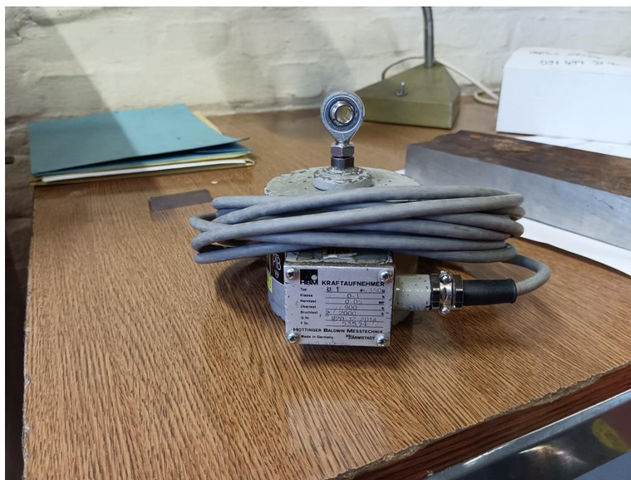
Slika 20. Dinamometar HBM U1 500 N
