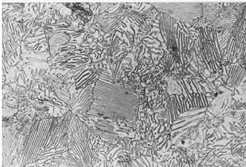
Slika 3. Mikrostruktura poboljšanog čelika [8]
