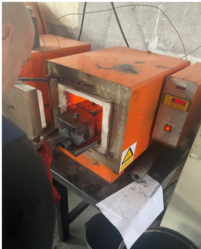
Slika 19. Stavljanje uzoraka u peć
